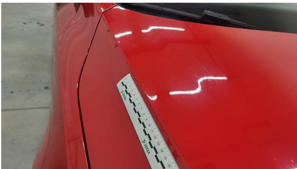
Fot. 38. Pokrywa komory silnika - Rysa/odprysk 1
