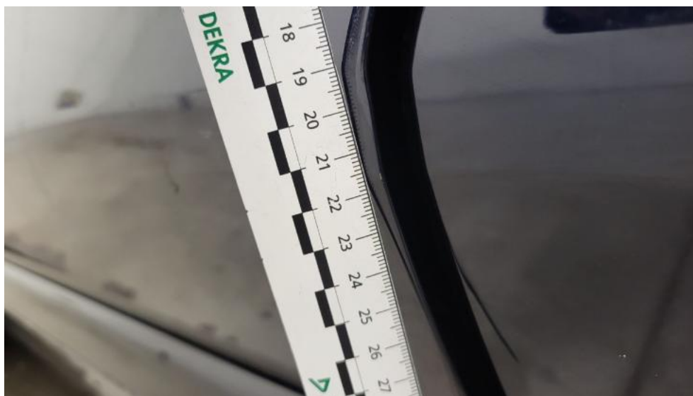
Fot. 47. Drzwi przed L - Rysa/odprysk 1
