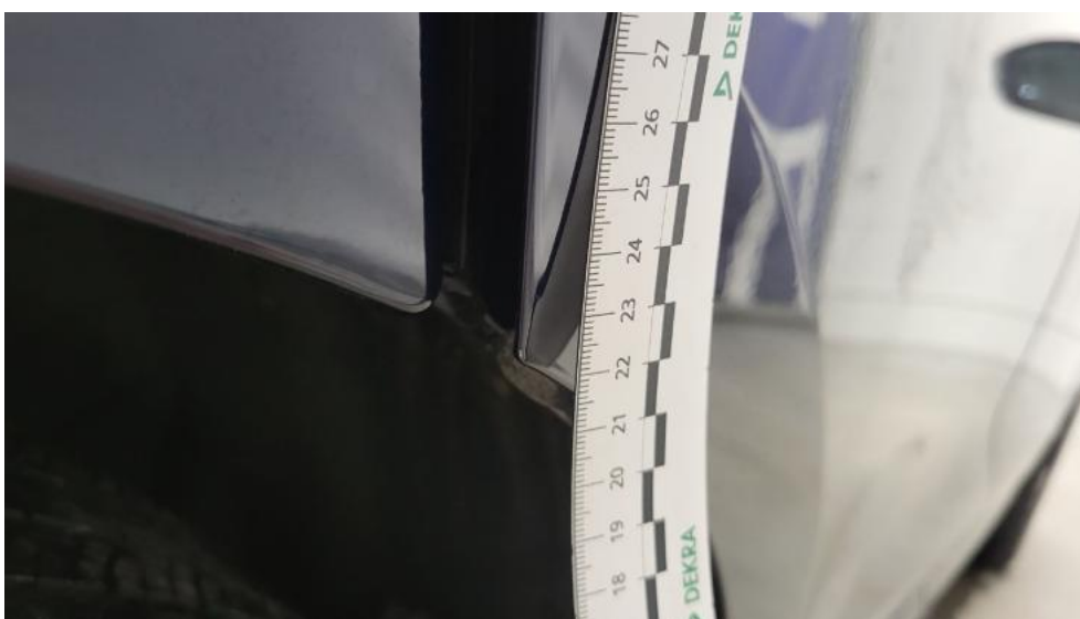
Fot. 46. Drzwi tylne P - Rysa/odprysk 1
