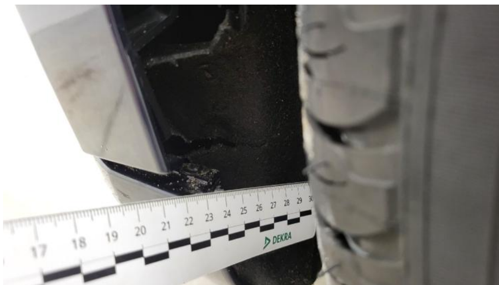
Fot. 49. Nadkole przednie L - Pęknięcie/rozerwanie 1
