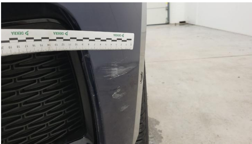
Fot. 44. Zderzak - Wgniecenie/odkształcenie 1
