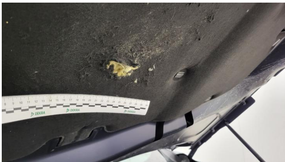
Fot. 42. Wykładzina pokrywy komory silnika - Pęknięcie/rozerwanie 1
