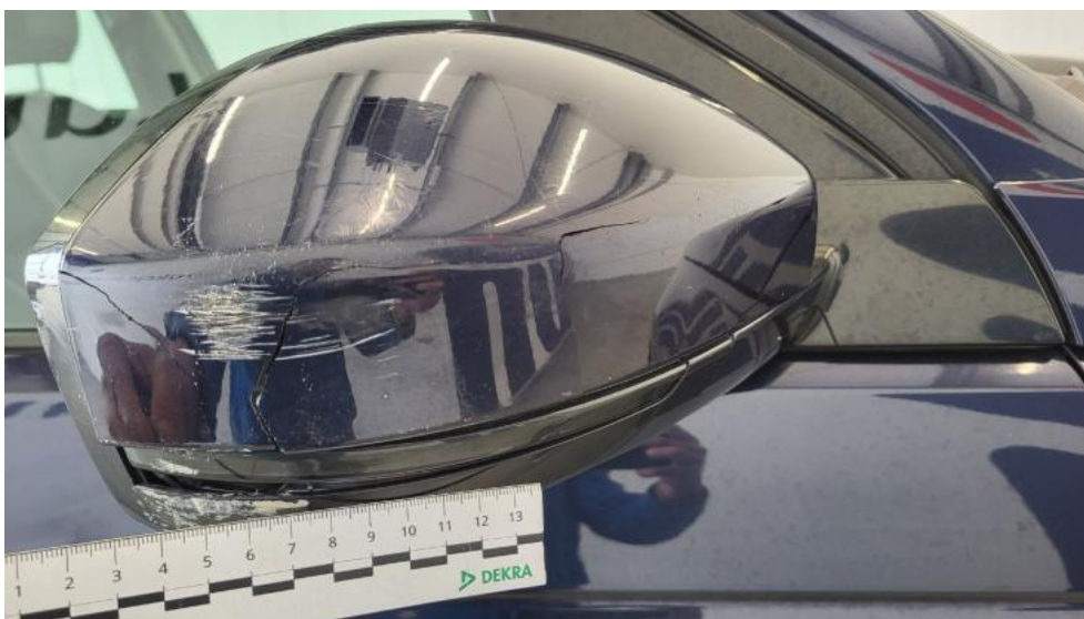
Fot. 58. Lusterko zew P - Pęknięcie/rozerwanie 1
