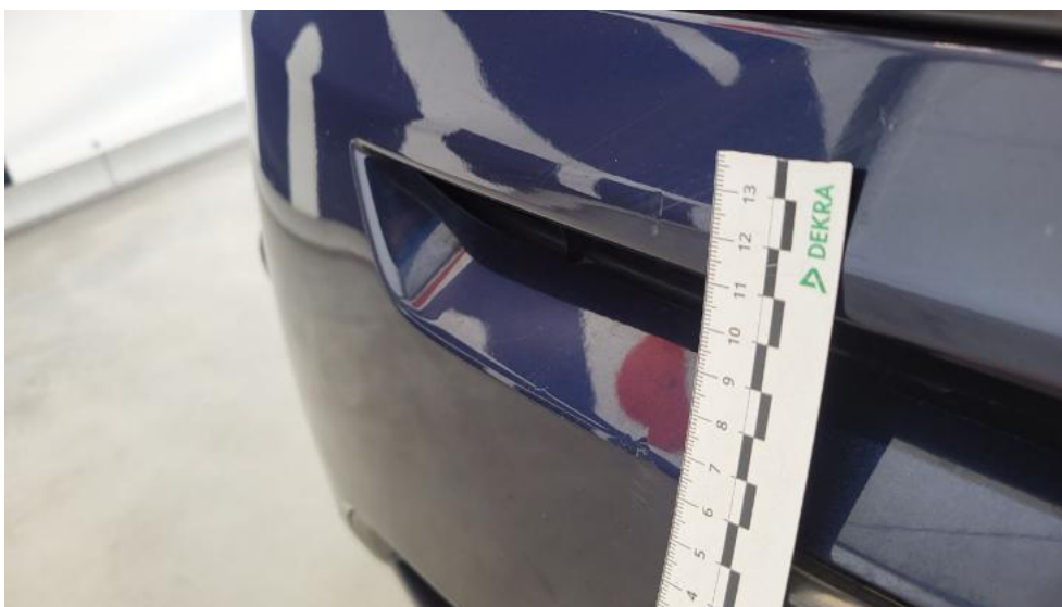
Fot. 47. Zderzak - Wgniecenie/odkształcenie 1
