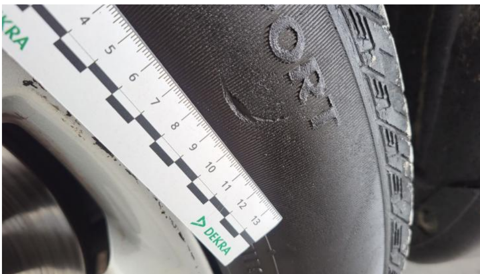
Fot. 82. Opona przednia L - Pęknięcie/rozerwanie 1
