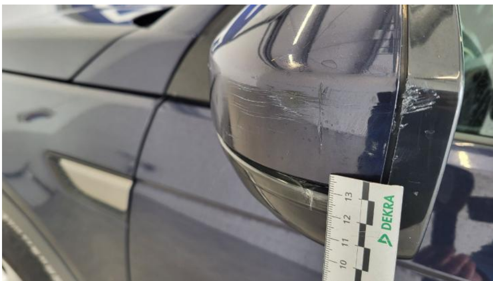
Fot. 80. Lusterko zew L - Pęknięcie/rozerwanie 1
