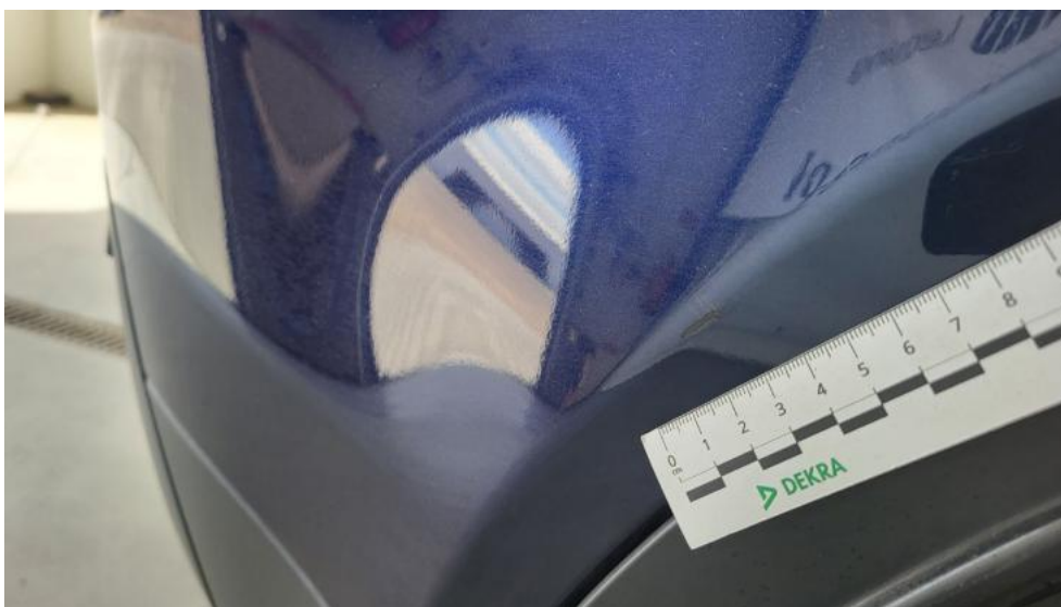
Fot. 67. Zderzak tylny cz P - Rysa/odprysk 1
