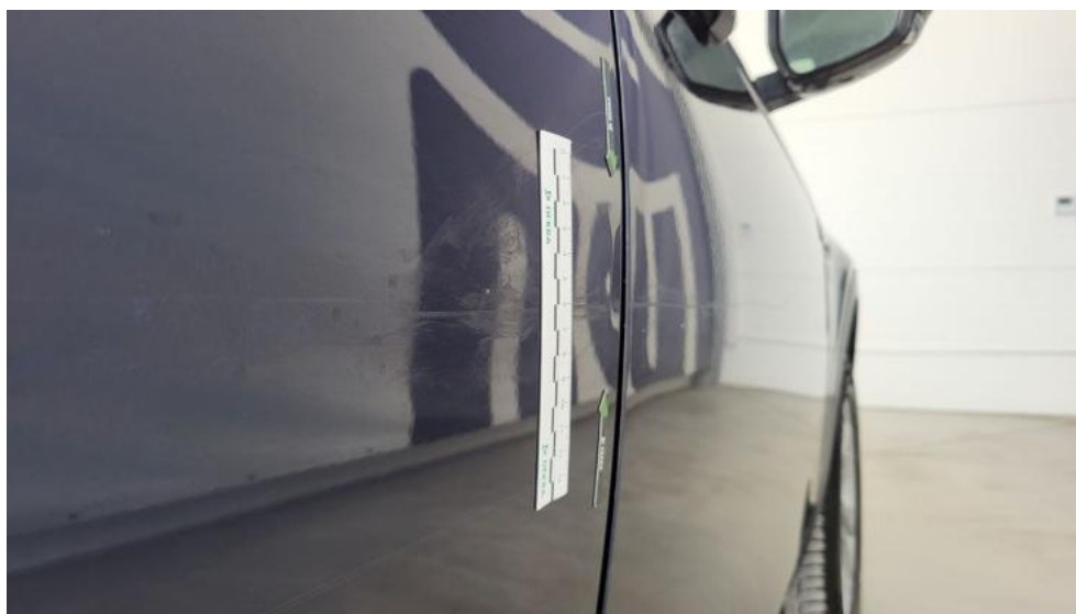
Fot. 55. Drzwi tylne P - Wgniecenie/odkształcenie 1
