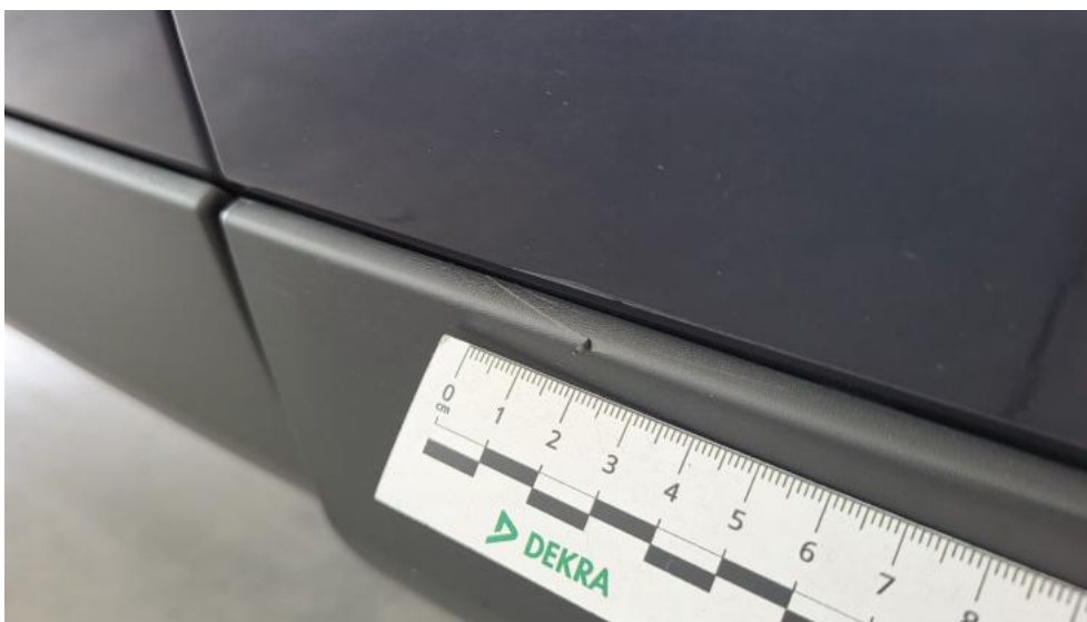
Fot. 57. Listwa drzwi przednich P - Rysa/odprysk 1
