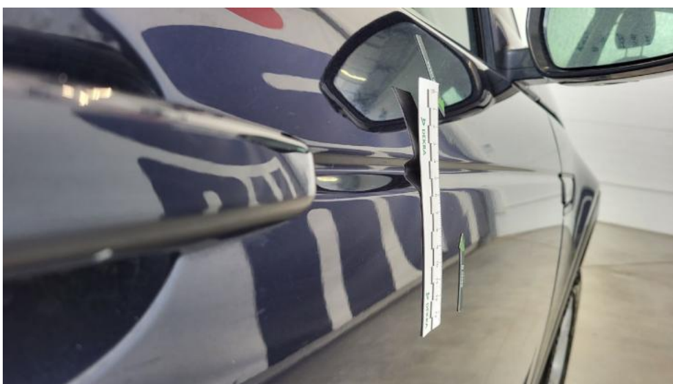
Fot. 52. Drzwi przednie P - Wgniecenie/odkształcenie 1
