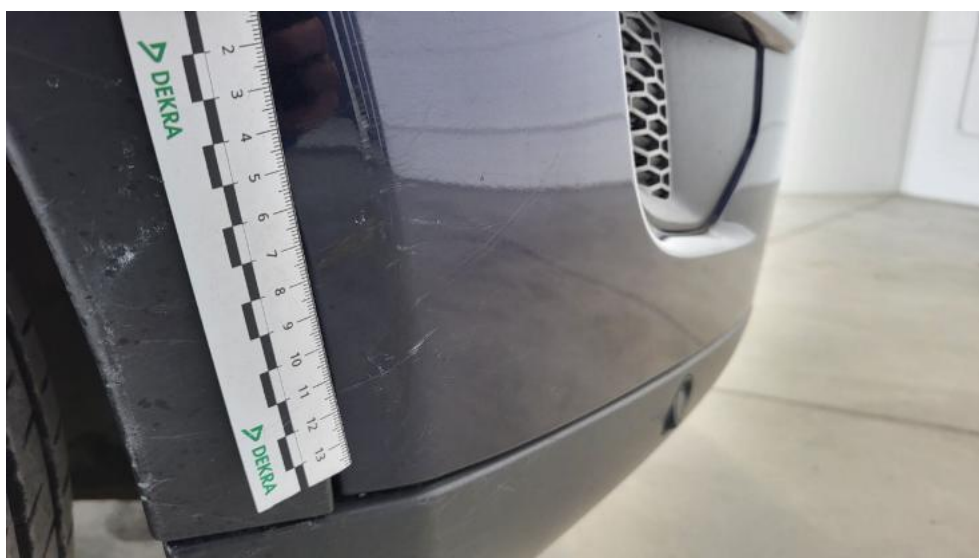
Fot. 46. Zderzak() - Rysa/odprysk 3
