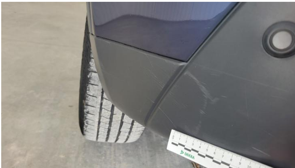
Fot. 65. Zderzak tylny - Rysa/odprysk 1
