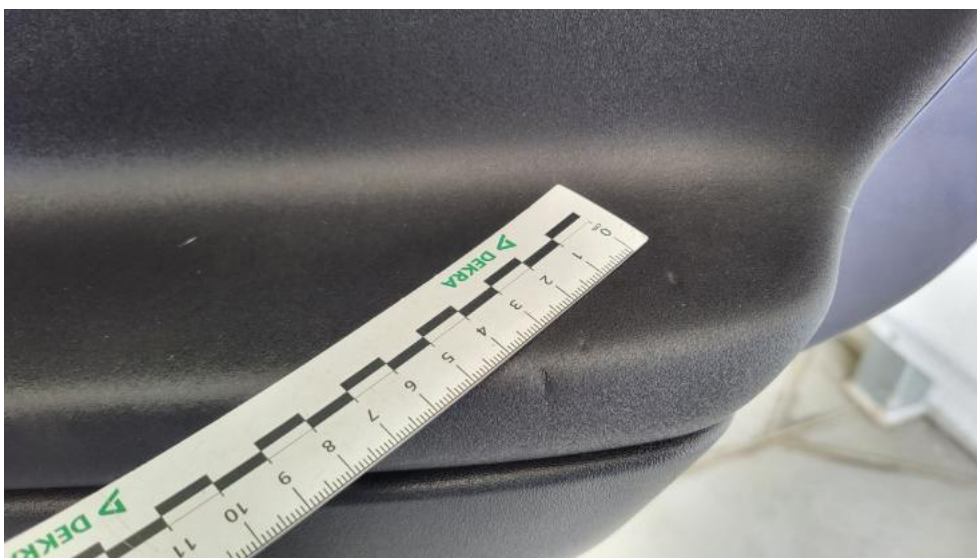
Fot. 86. Tapicerka drzwi tylnych P - Wgniecenie/odkształcenie 1
