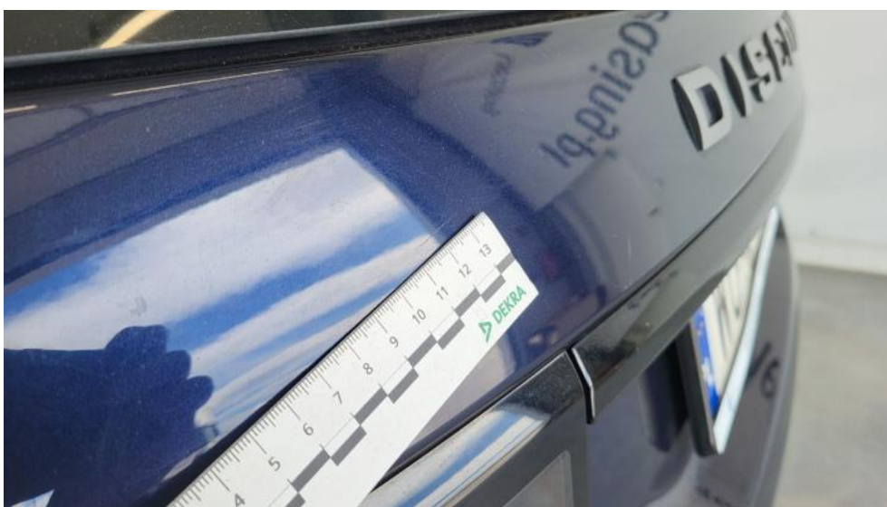
Fot. 64. Pokrywy bagażnika - Rysa/odprysk 2
