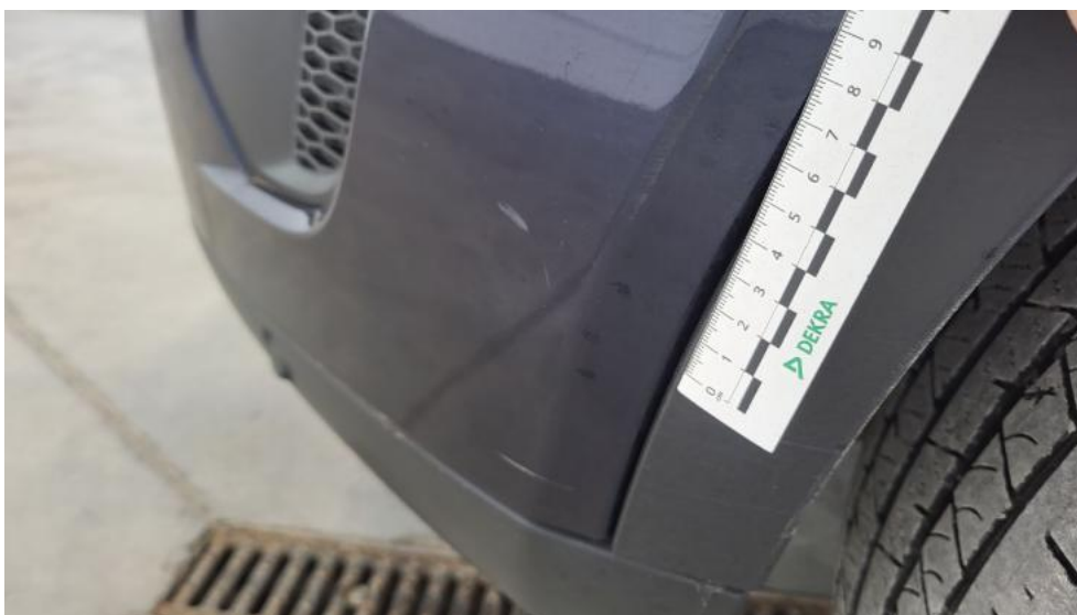
Fot. 44. Zderzak - Rysa/odprysk 1
