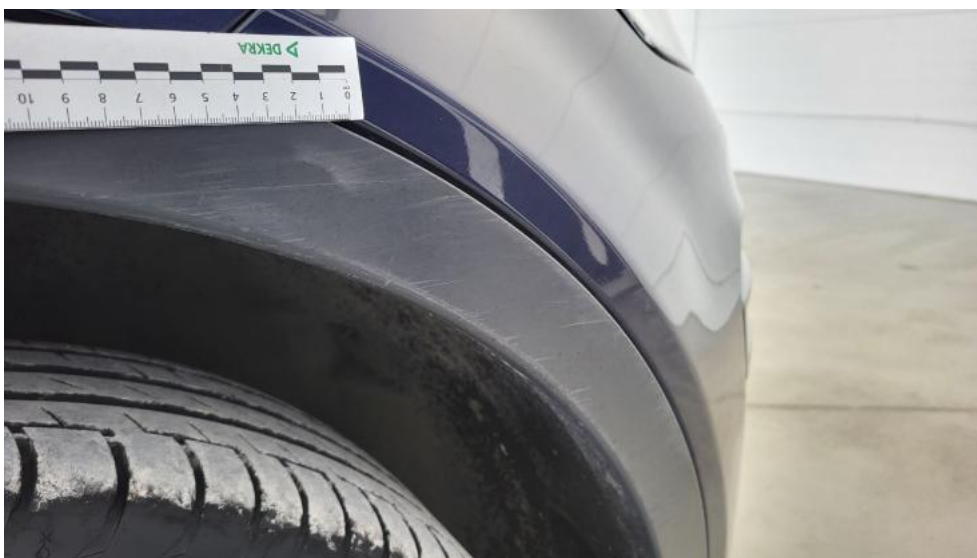
Fot. 50. Listwa krawędzi błotnika prz P - Rysa/odprysk 1
