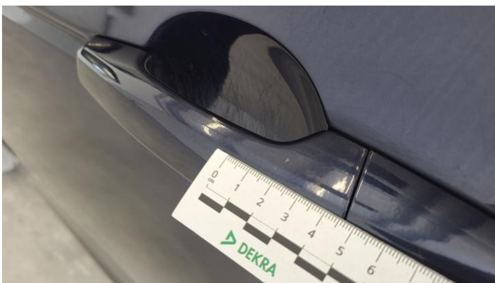
Fot. 78. Klamka drzwi prz L - Rysa/odprysk 1
