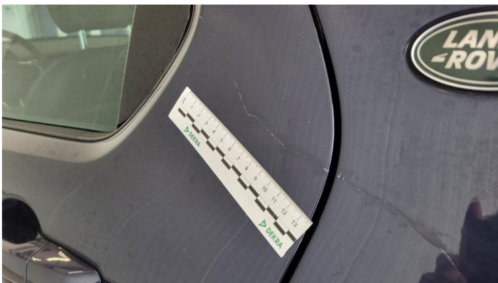
Fot. 76. Drzwi tylne L - Rysa/odprysk 1
