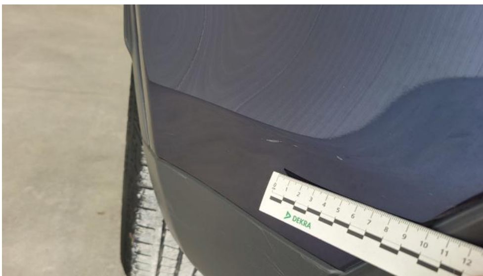
Fot. 66. Zderzak tylny cz L - Rysa/odprysk 1
