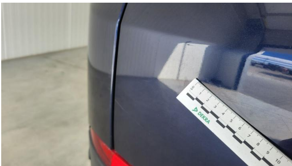
Fot. 63. Pokrywy bagażnika - Rysa/odprysk 1
