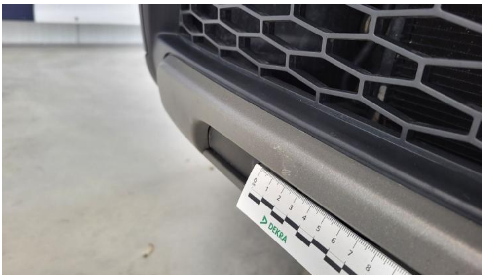
Fot. 42. Spoiler zderzaka przedniego - Wgniecenie/odkształcenie 1
