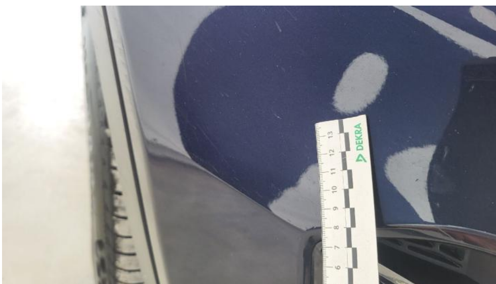
Fot. 48. Zderzak - Wgniecenie/odkształcenie 2
