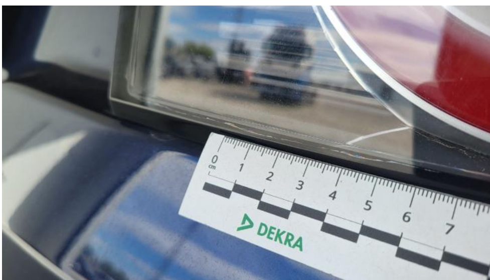
Fot. 60. Lampa tylna wew P - Pęknięcie/rozerwanie 1
