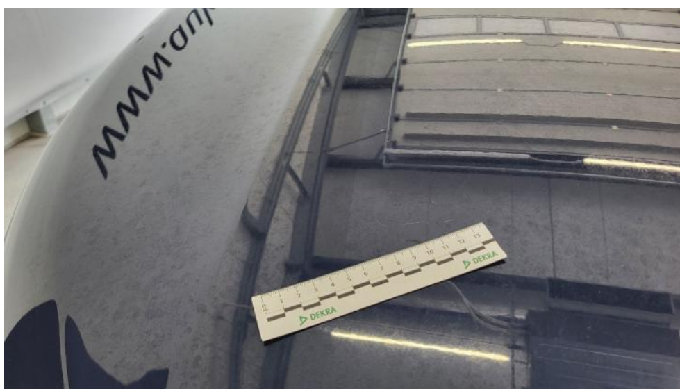
Fot. 40. Pokrywa komory silnika - Rysa/odprysk 1
