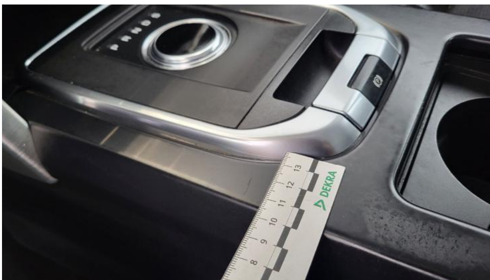
Fot. 83. Konsola tunelu śr. - Rysa/odprysk 1
