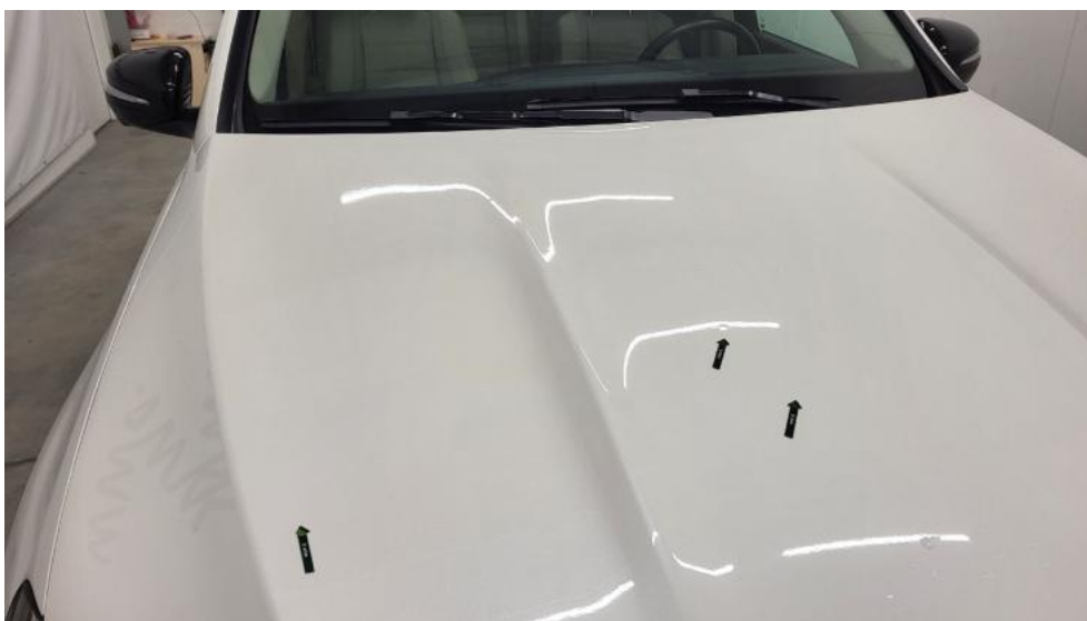
Photo 43. Pokrywa komory silnika - Wgniecenie/odkształcenie 1
