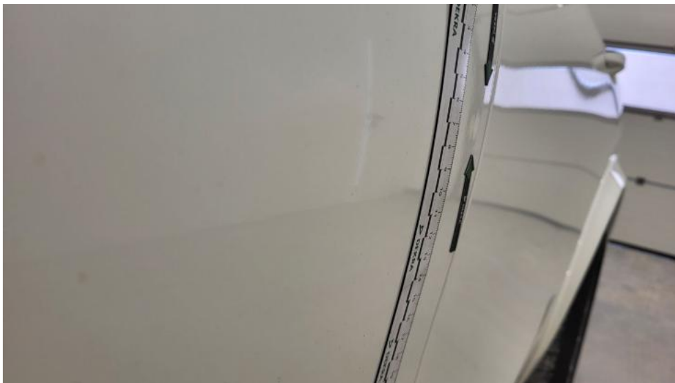
Photo 59. Drzwi przed L - Wgniecenie/odkształcenie 1
