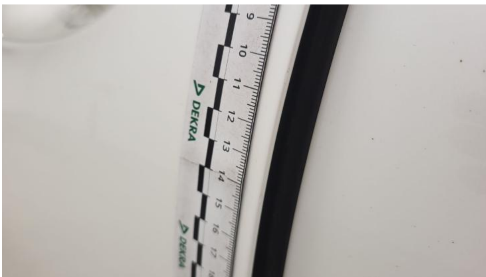
Photo 58. Drzwi przed L - Rysa/odprysk 1
