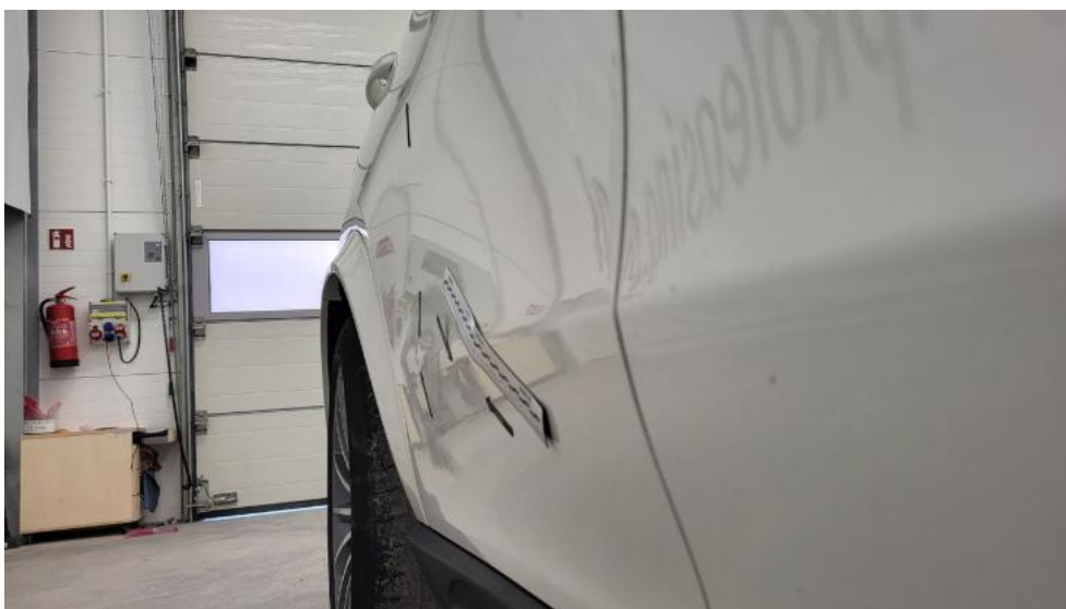
Photo 51. Drzwi tylne P - Wgniecenie/odkształcenie 1
