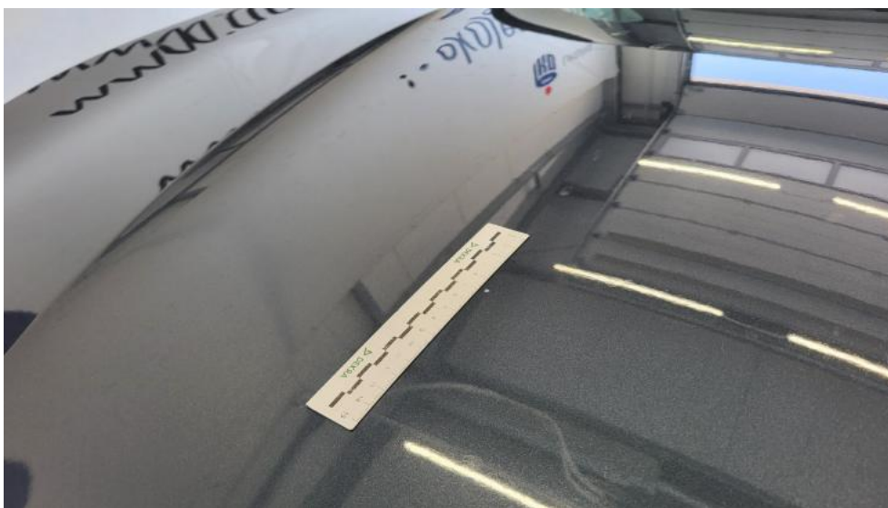
Photo 41. Pokrywa komory silnika - Rysa/odprysk 1
