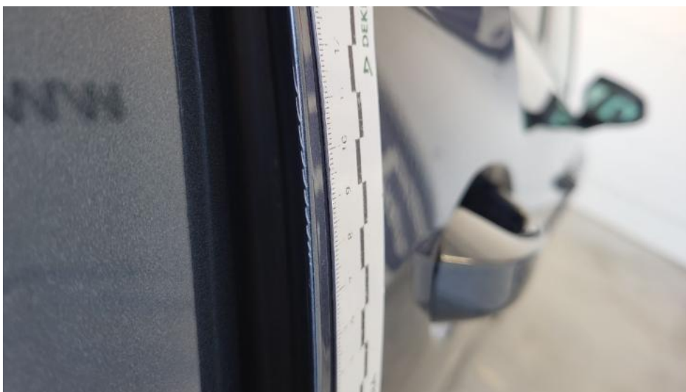
Photo 48. Drzwi tylne P - Rysa/odprysk 1
