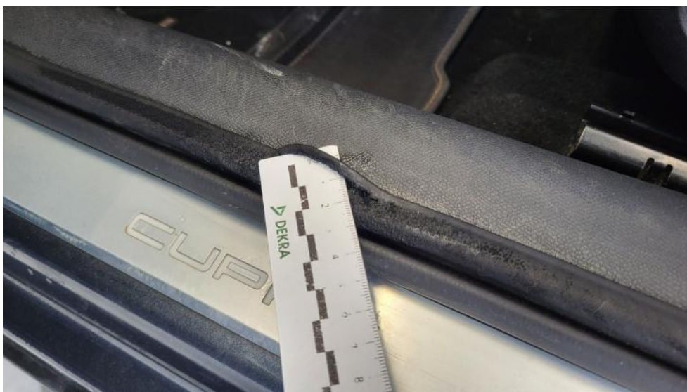
Photo 70. Uszczelka drzwi przednich L - Pęknięcie/rozerwanie 1
