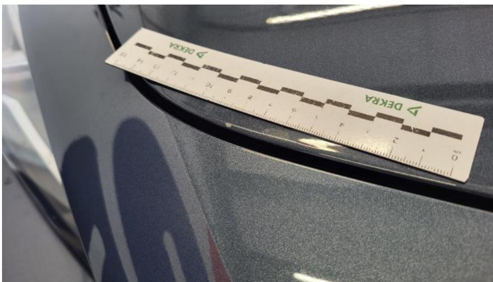
Photo 42. Pokrywa komory silnika - Rysa/odprysk 2
