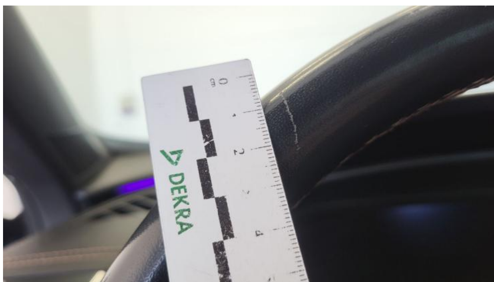
Photo 64. Koło kierownicy - Rysa/odprysk 1
