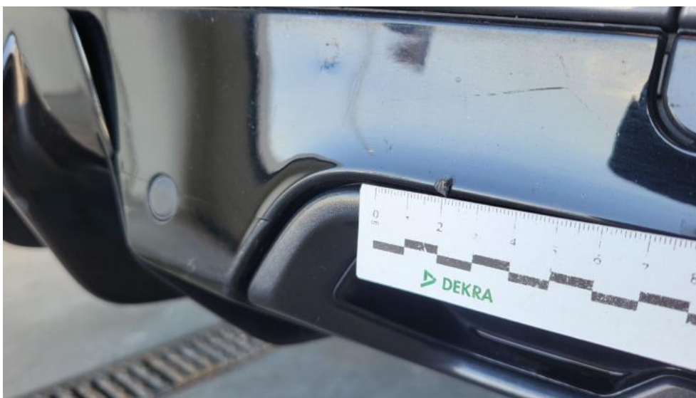
Photo 57. Zderzak tylny cz dolna - Wgniecenie/odkształcenie 1
