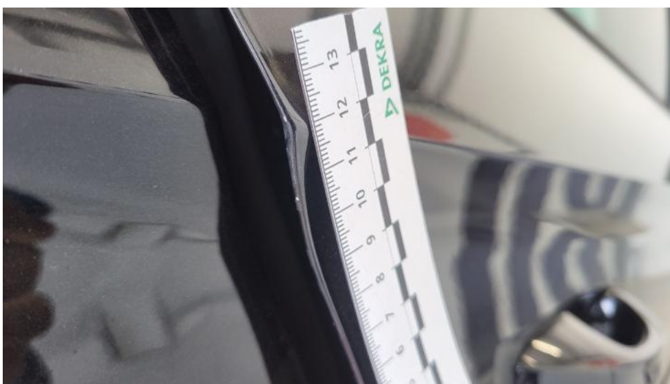
Fot. 42. Drzwi tylne P - Rysa/odprysk 1
