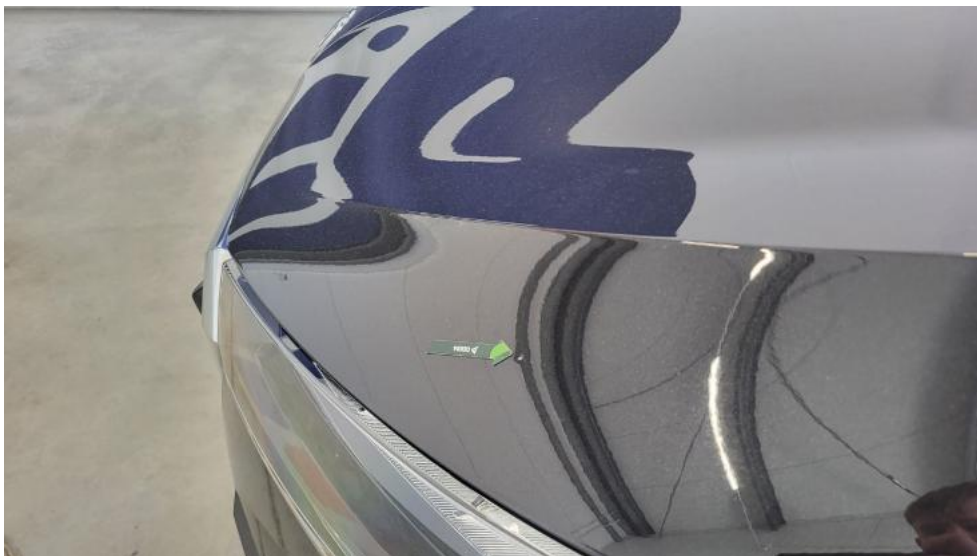
Fot. 39. Pokrywa komory silnika - Wgniecenie/odkształcenie 1
