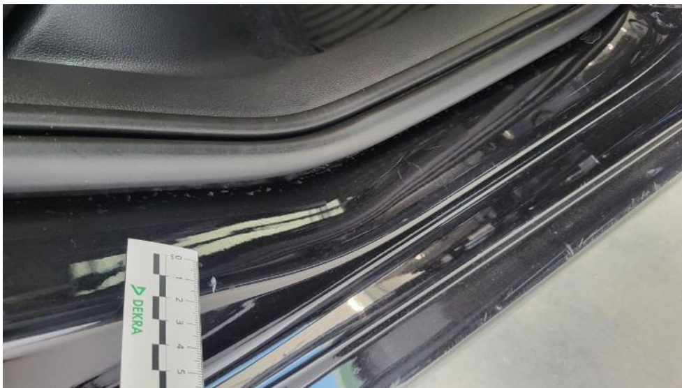
Fot. 43. Próg P - Rysa/odprysk 1
