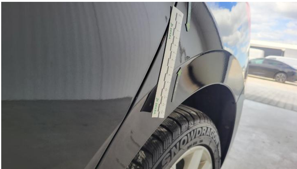
Fot. 49. Błotnik tylny L / Ściana boczna L - Wgniecenie/odkształcenie 1
