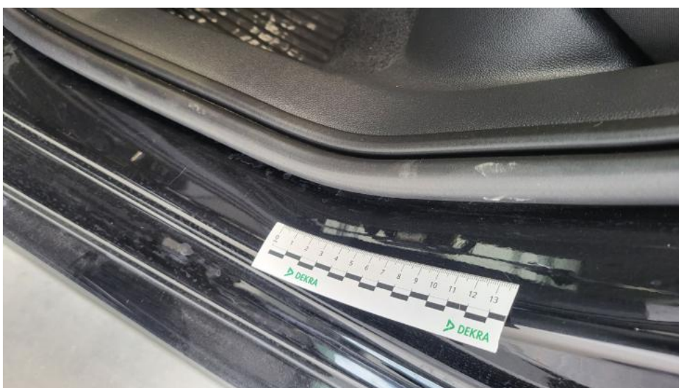
Fot. 52. Próg L - Rysa/odprysk 1
