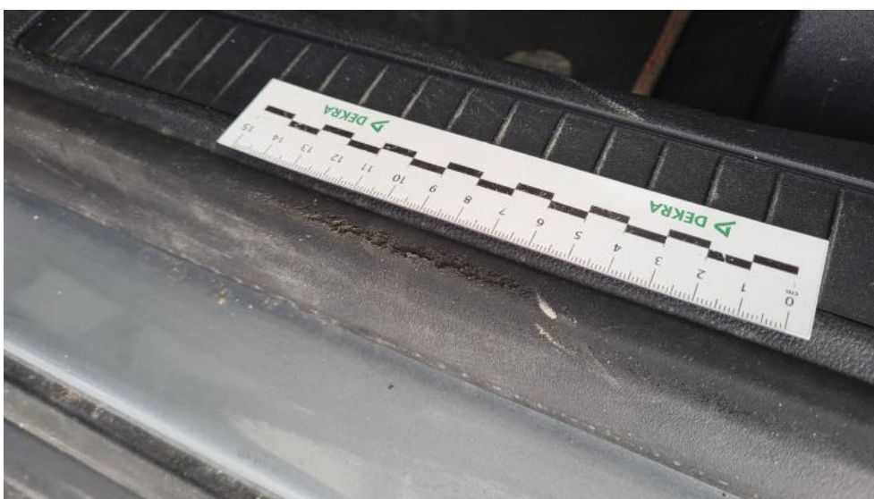
Photo 72. Uszczelka drzwi przednich L - Rysa/odprysk 1
