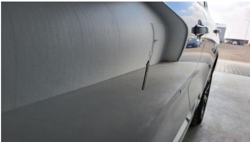
Photo 65. Drzwi przed L - Wgniecenie/odkształcenie 1
