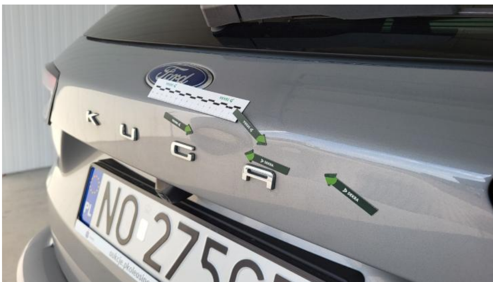
Photo 57. Pokrywy bagażnika - Wgniecenie/odkształcenie 1
