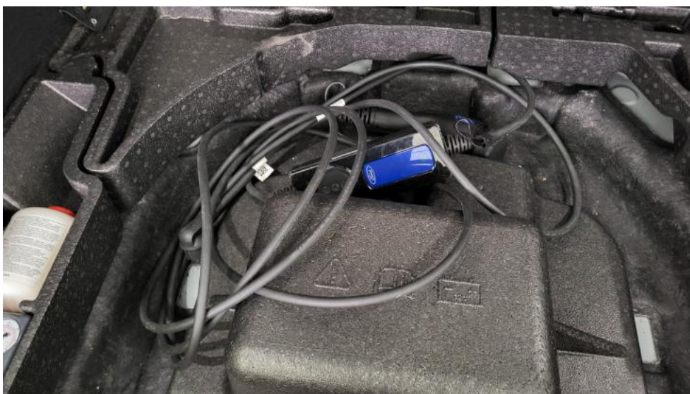
Photo 32. Przewód ładowania baterii trakcyjnej
