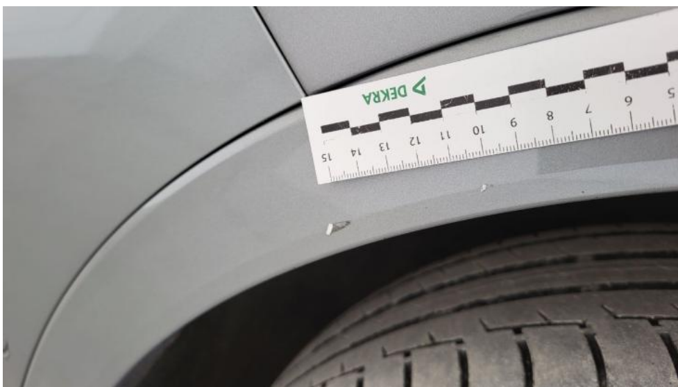
Photo 68. Listwa błotnika przedniego L - Rysa/odprysk 1
