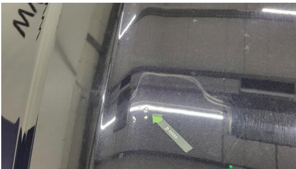
Fot. 58. Pokrywa komory silnika - Wgniecenie/odkształcenie 2
