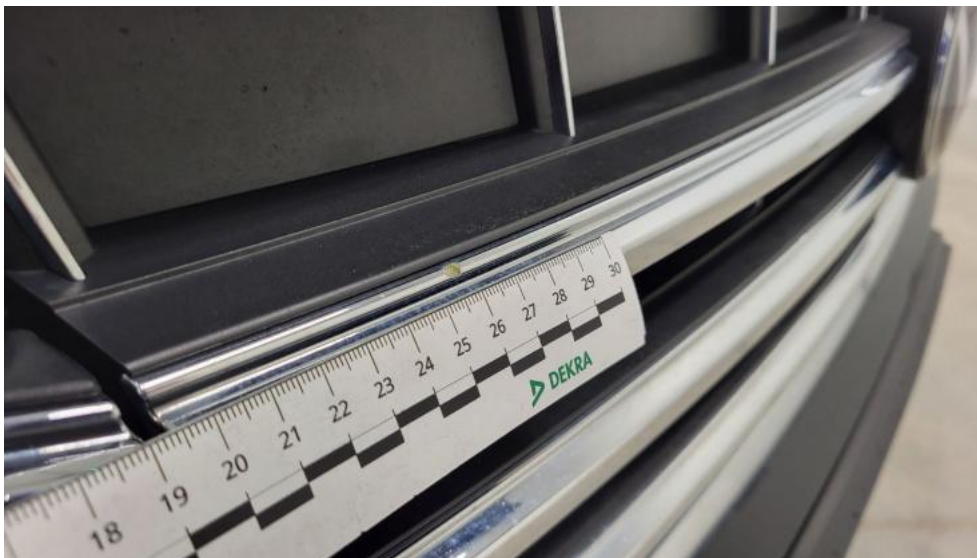
Fot. 53. Atrapa przednia - Rysa/odprysk 1
