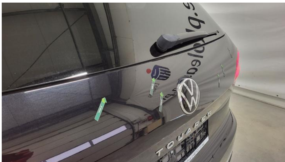
Fot. 69. Pokrywy bagażnika - Wgniecenie/odkształcenie 1
