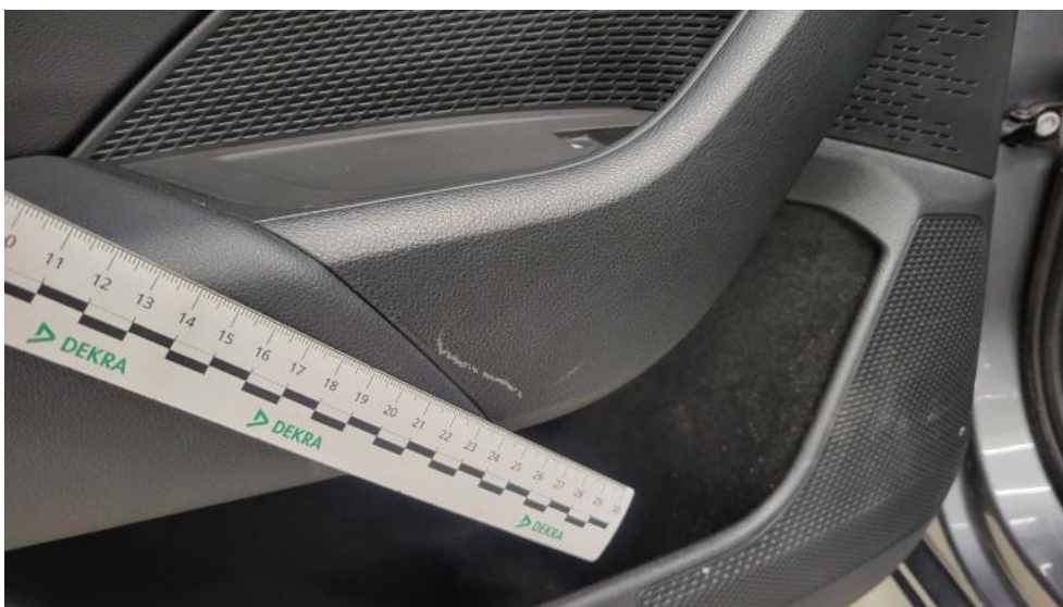
Photo 56. Uchwyt drzwi tyl L - Rysa/odprysk 1
