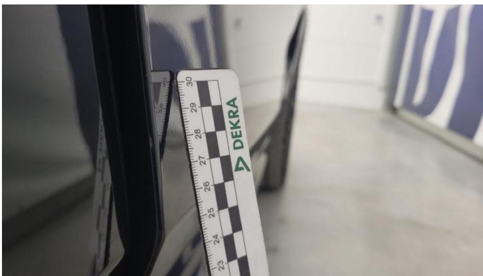
Fot. 42. Drzwi przednie P - Rysa/odprysk 1
