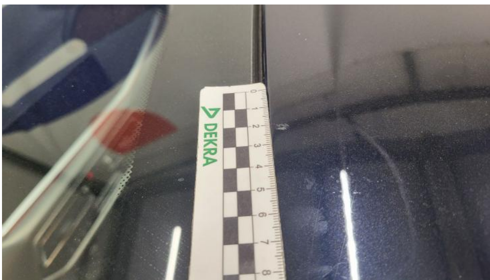
Fot. 43. Dach - Rysa/odprysk 1
