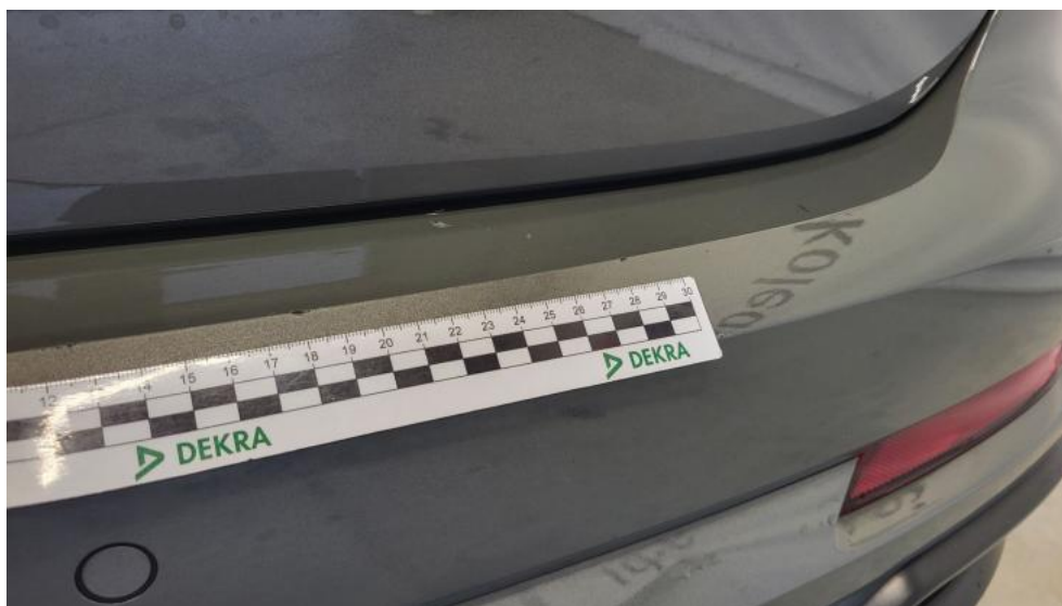
Photo 71. Zderzak tylny - Rysa/odprysk 1
