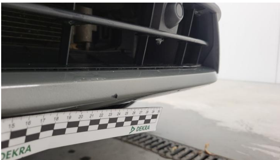
Photo 65. Spoiler zderzaka przedniego - Rysa/odprysk 1
