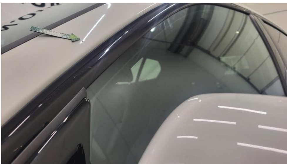
Photo 71. Stupek przedni L - Wgniecenie/odkształcenie 1
