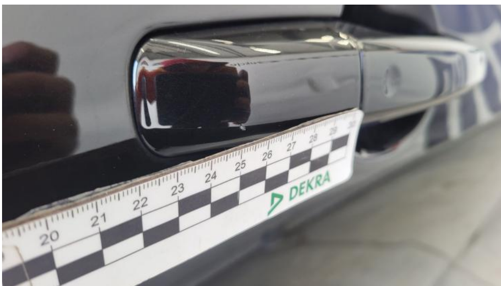
Photo 57. Klamka drzwi tyl P - Rysa/odprysk 1
