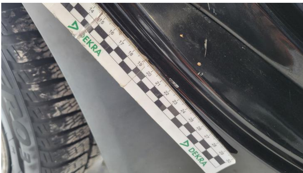
Photo 59. Próg P - Rysa/odprysk 1
