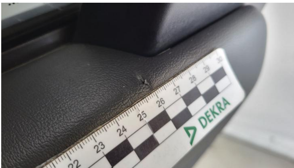
Photo 95. Tapicerka drzwi tylnych P - Pęknięcie/rozerwanie 1
