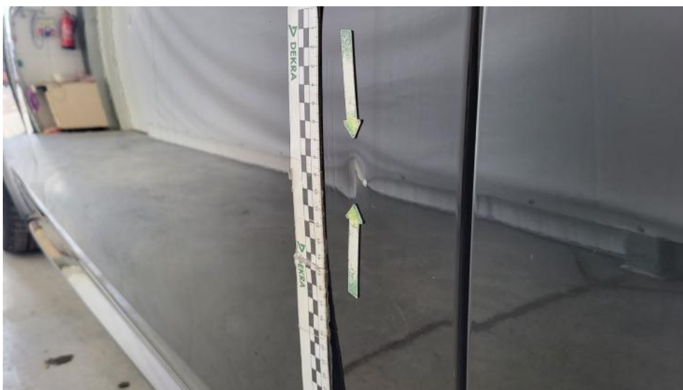
Photo 51. Drzwi przednie P - Wgniecenie/odkształcenie 1
