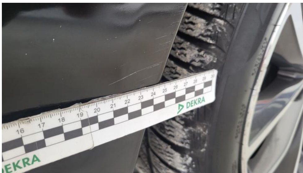
Photo 43. Błotnik przedni P - Rysa/odprysk 2
