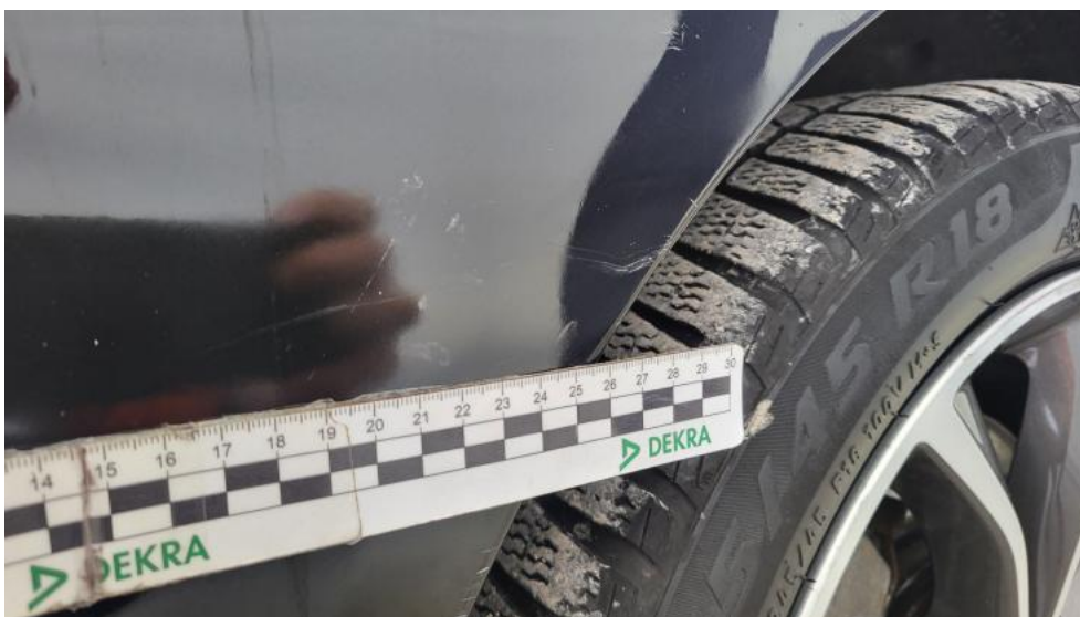
Photo 42. Błotnik przedni P - Rysa/odprysk 1
