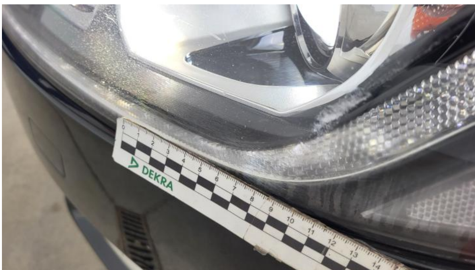
Photo 90. Reflektor L - Rysa/odprysk 2
