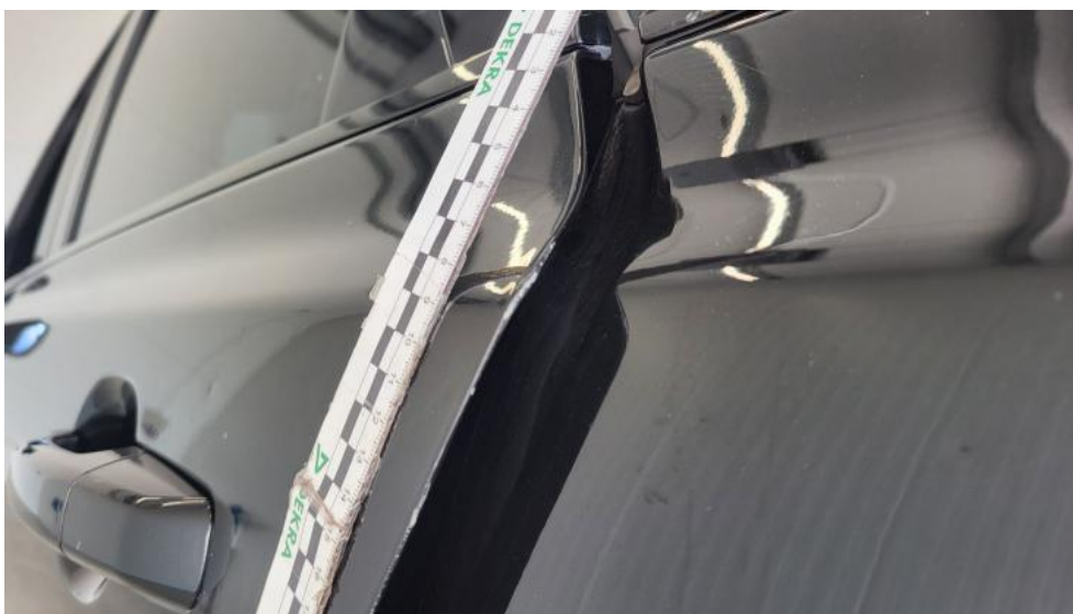
Photo 81. Drzwi tylne L - Rysa/odprysk 2
