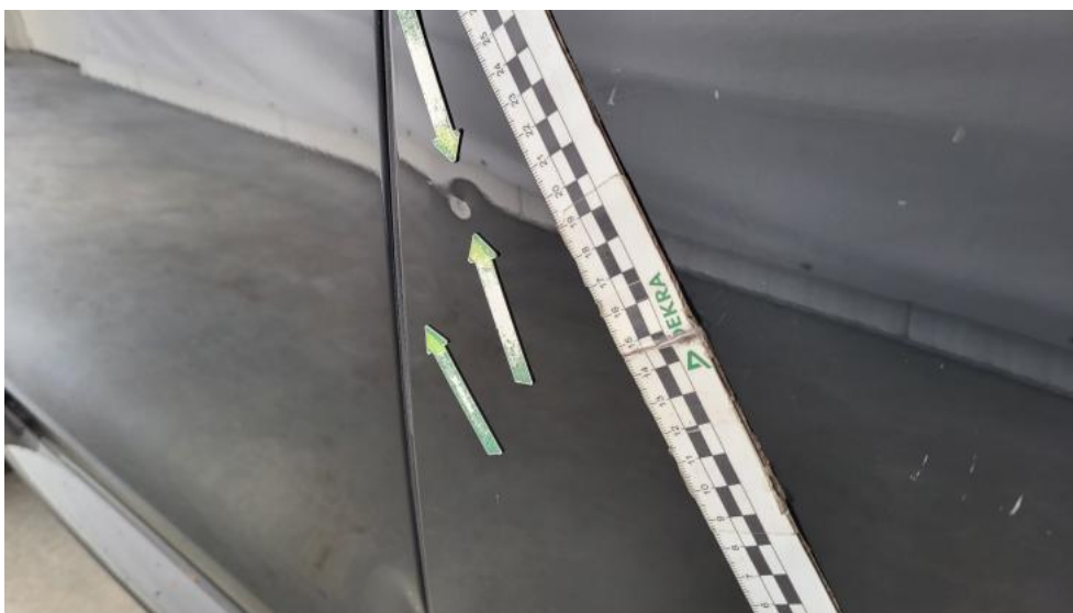
Photo 52. Drzwi przednie P - Wgniecenie/odkształcenie 2
