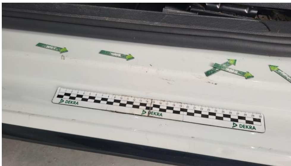
Fot. 81. Próg L - Rysa/odprysk 1
