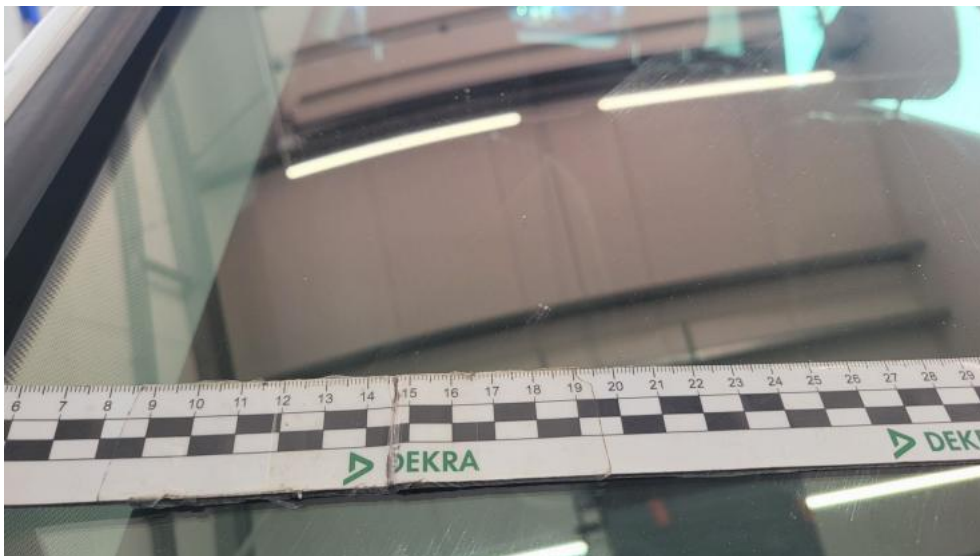
Fot. 53. Szyba czołowa - Rysa/odprysk 1
