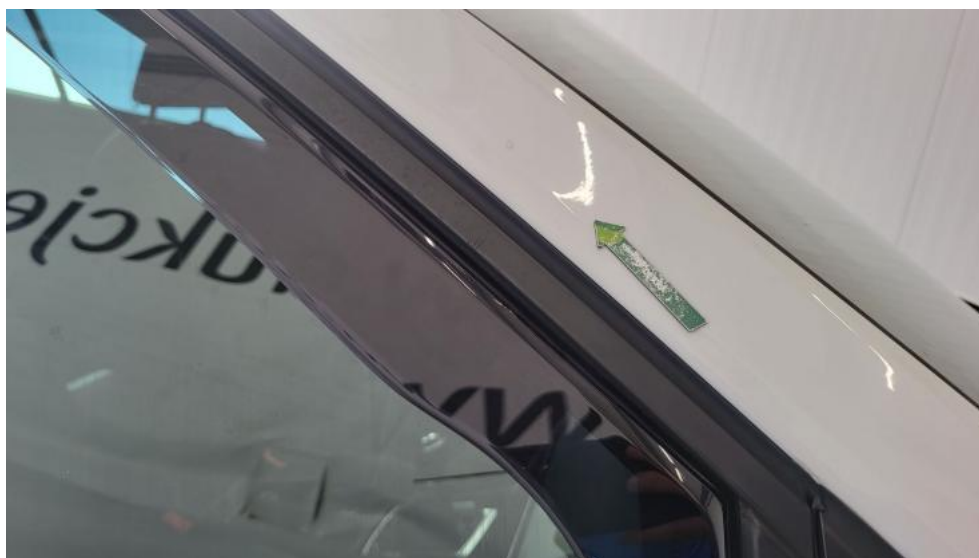
Fot. 66. Słupek przedni P - Wgniecenie/odkształcenie 1
