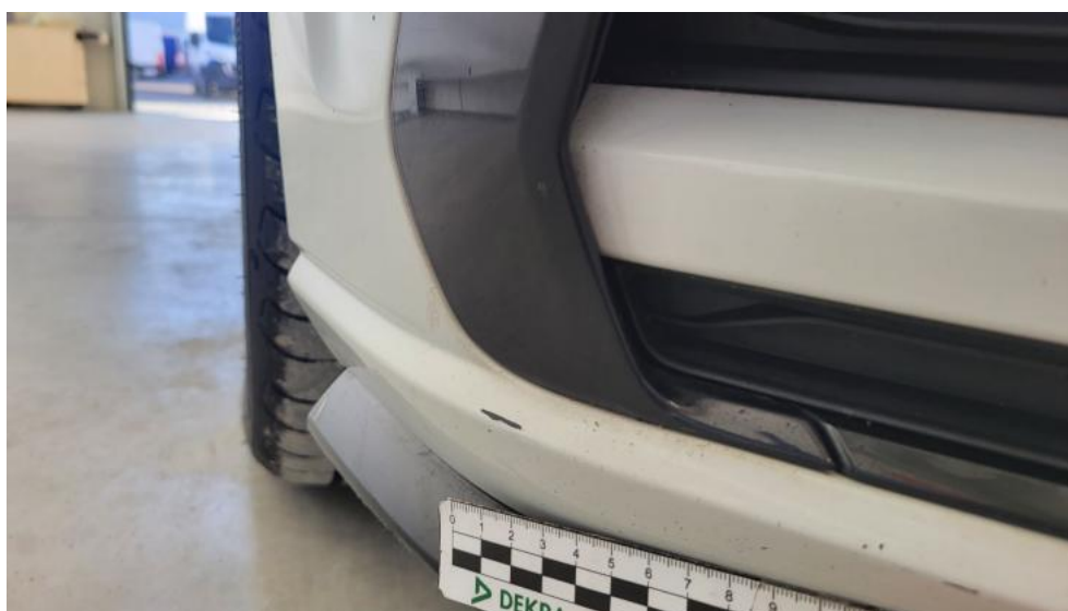
Fot. 58. Zderzak() - Rysa/odprysk 3
