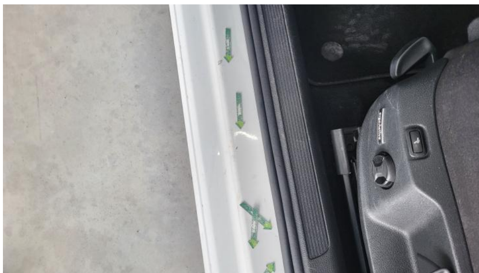
Fot. 83. Próg L - Wgniecenie/odkształcenie 2
