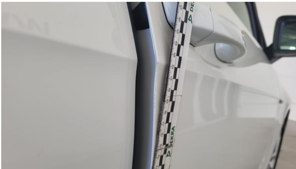
Fot. 59. Drzwi przednie P - Rysa/odprysk 1
