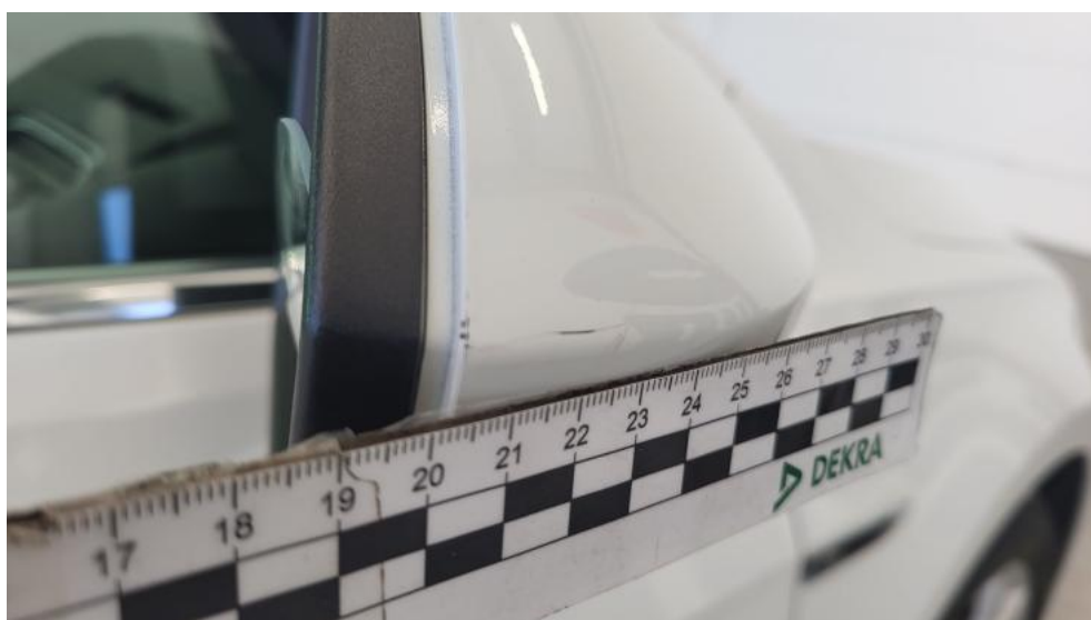
Fot. 62. Lusterko zew P - Rysa/odprysk 1
