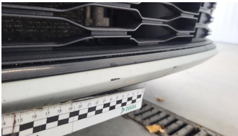
Fot. 57. Zderzak - Rysa/odprysk 2
