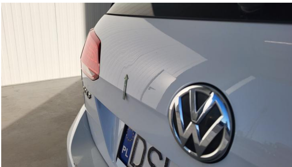
Fot. 72. Pokrywy bagażnika - Wgniecenie/odkształcenie 2
