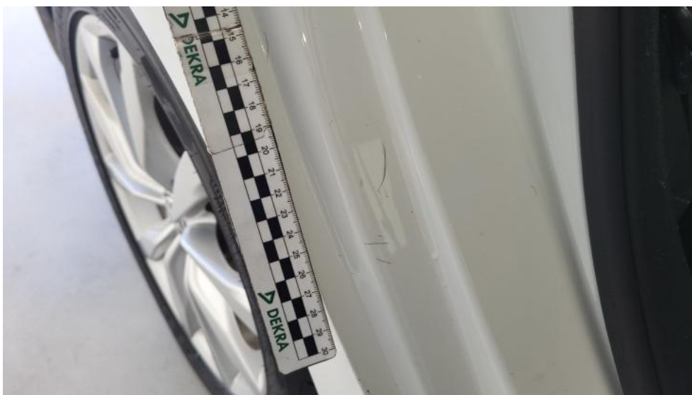
Fot. 68. Błotnik tylny P / Ściana boczna P - Rysa/odprysk 1
