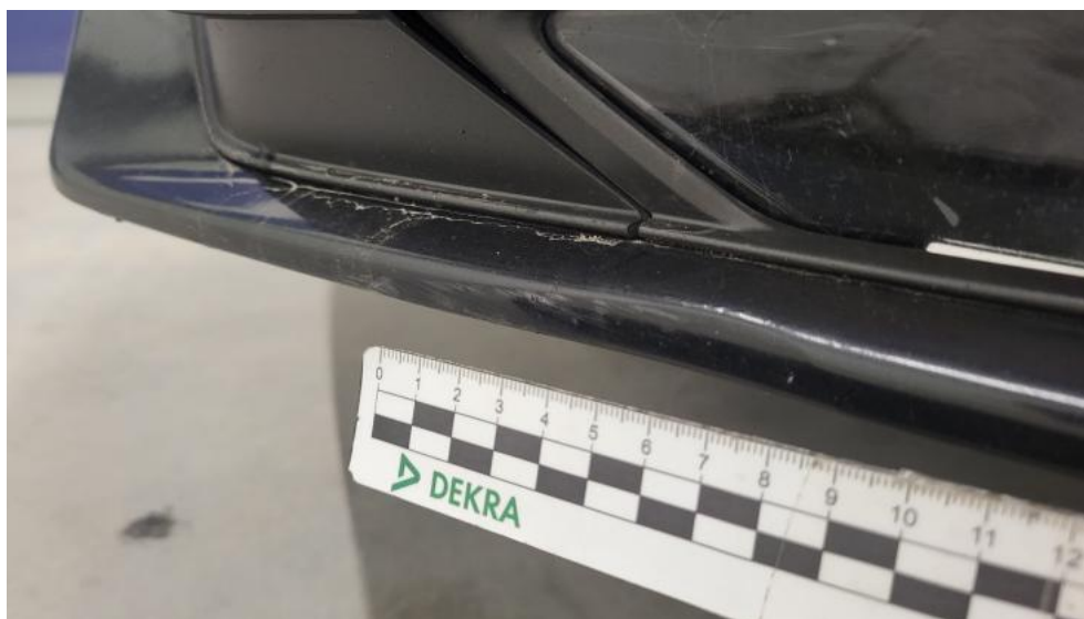
Fot. 47. Zderzak przedni cz dolna - Rysa/odprysk 1
