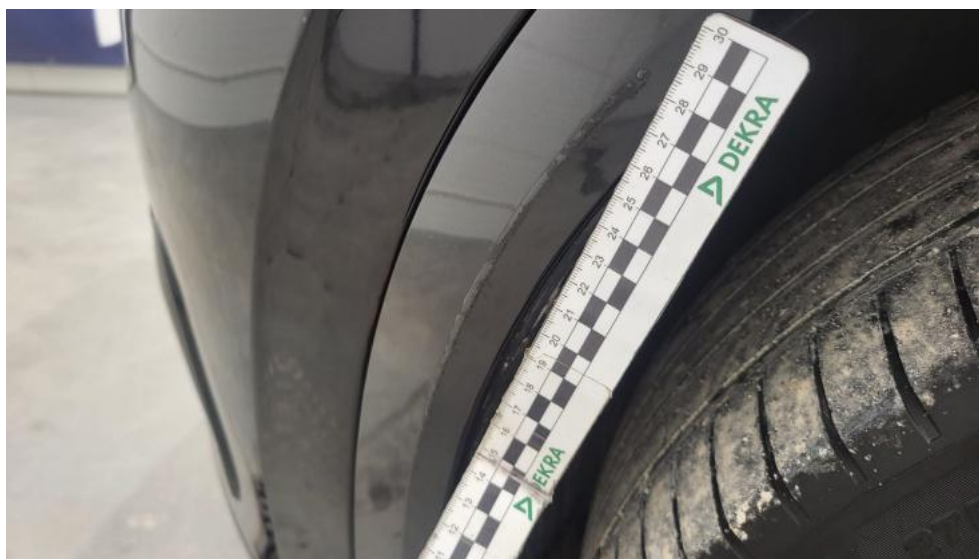
Fot. 65. Listwa błotnika przedniego L - Rysa/odprysk 1
