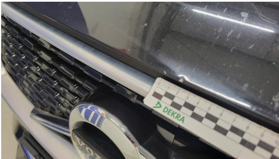
Fot. 45. Pokrywa komory silnika - Wgniecenie/odkształcenie 1
