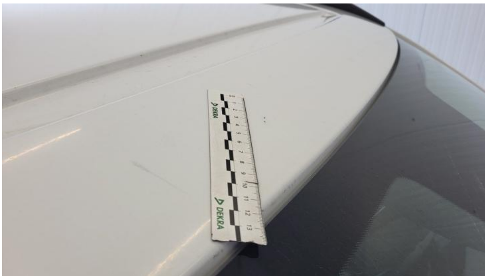
Fot. 79. Dach - Rysa/odprysk 1
