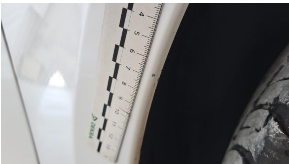
Fot. 56. Błotnik przedni P - Rysa/odprysk 1
