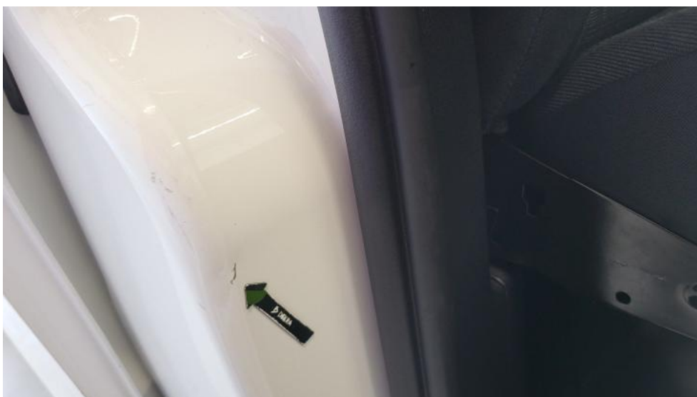
Fot. 68. Słupek środkowy P - Wgniecenie/odkształcenie 1
