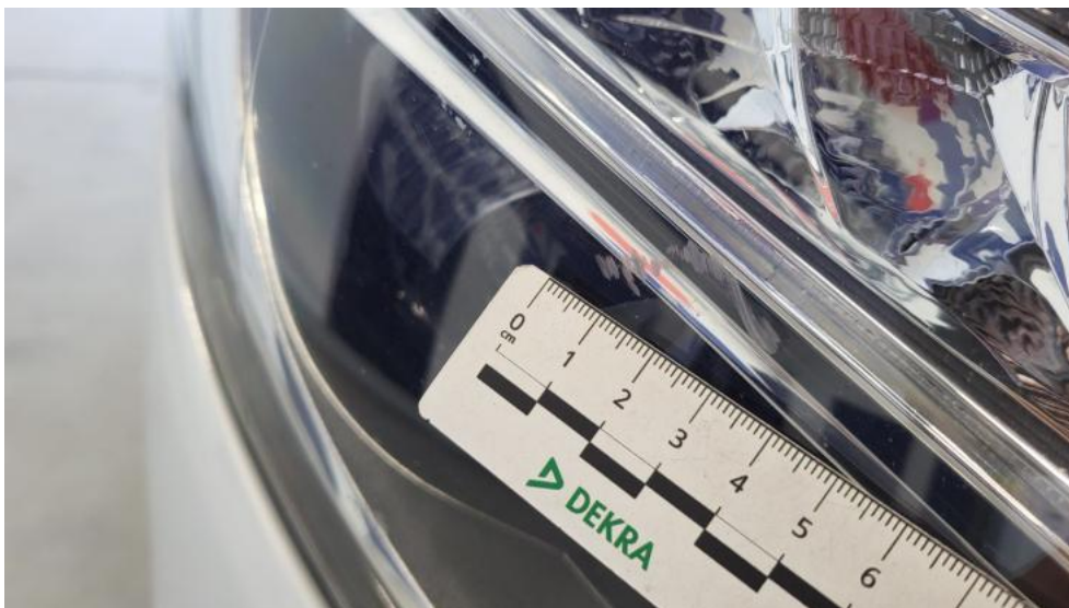
Fot. 59. Reflektor P - Rysa/odprysk 1
