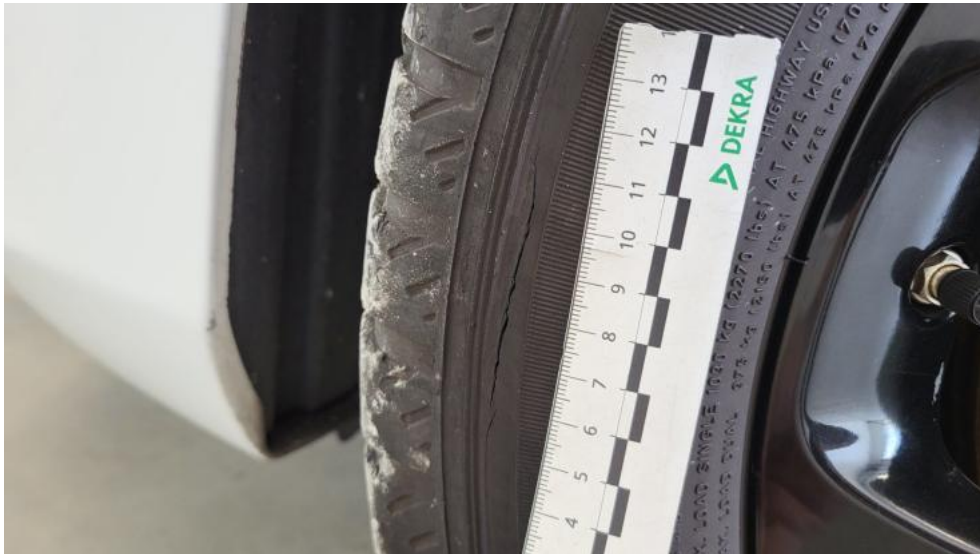
Fot. 93. Opona przednia L - Pęknięcie/rozerwanie 1
