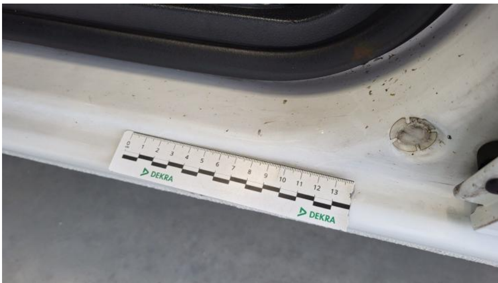
Fot. 89. Próg L - Rysa/odprysk 1
