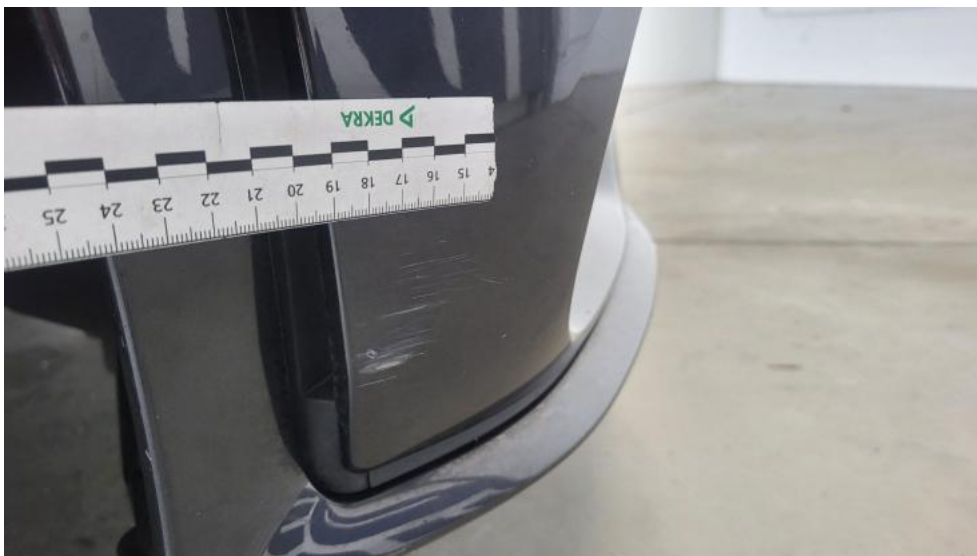
Fot. 45. Zderzak() - Rysa/odprysk 3
