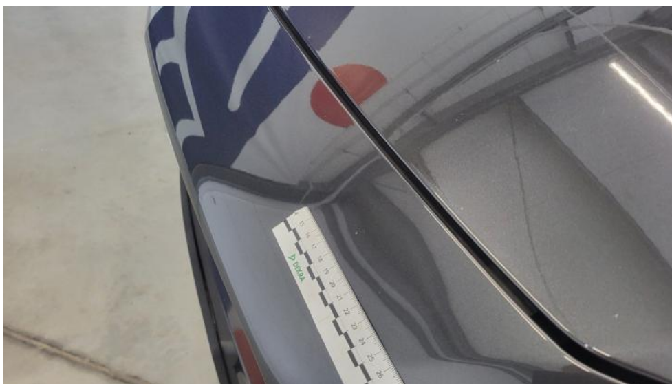
Fot. 46. Zderzak - Wgniecenie/odkształcenie 1
