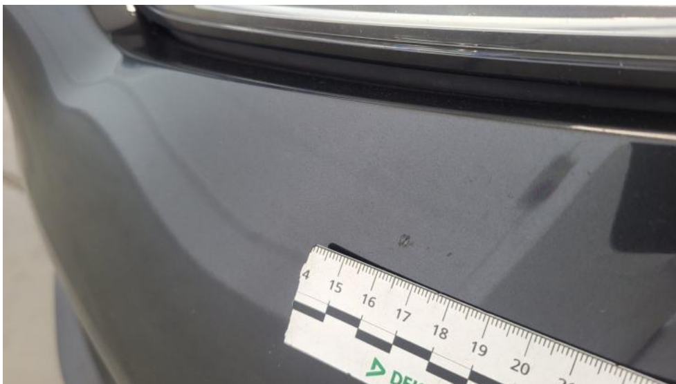
Fot. 43. Zderzak - Rysa/odprysk 1
