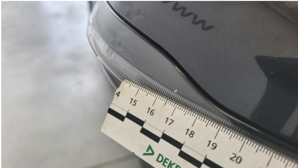
Fot. 53. Lusterko zew P - Rysa/odprysk 1
