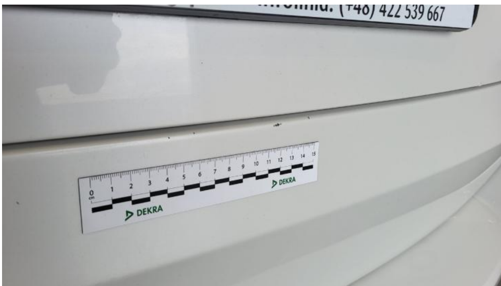
Photo 66. Pokrywy bagażnika - Rysa/odprysk 1
