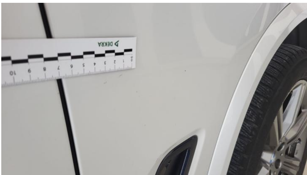
Photo 55. Błotnik przedni P - Rysa/odprysk 2
