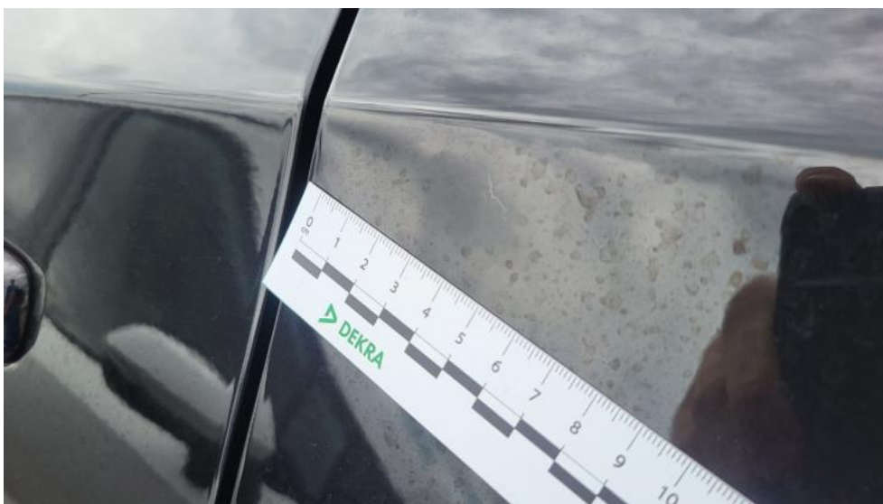
Photo 54. Błotnik tylny L / Ściana boczna L - Rysa/odprysk 1
