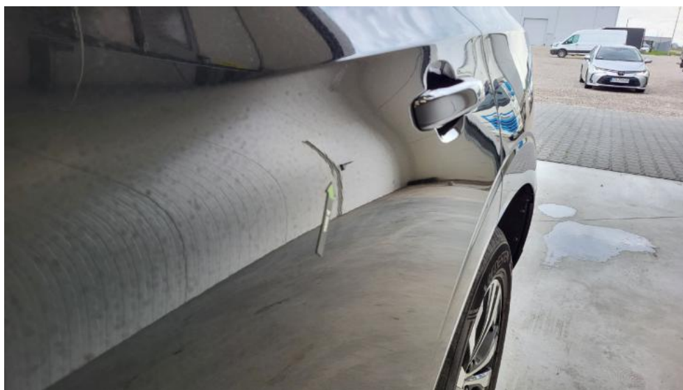
Photo 57. Drzwi tylne L - Wgniecenie/odkształcenie 1
