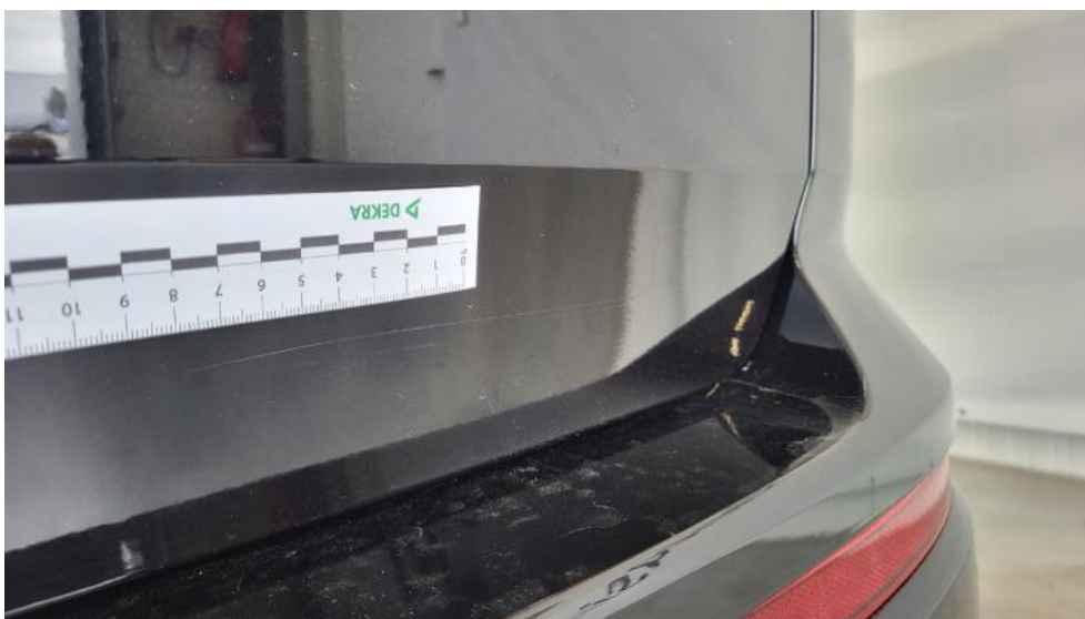
Photo 52. Pokrywy bagażnika - Rysa/odprysk 1
