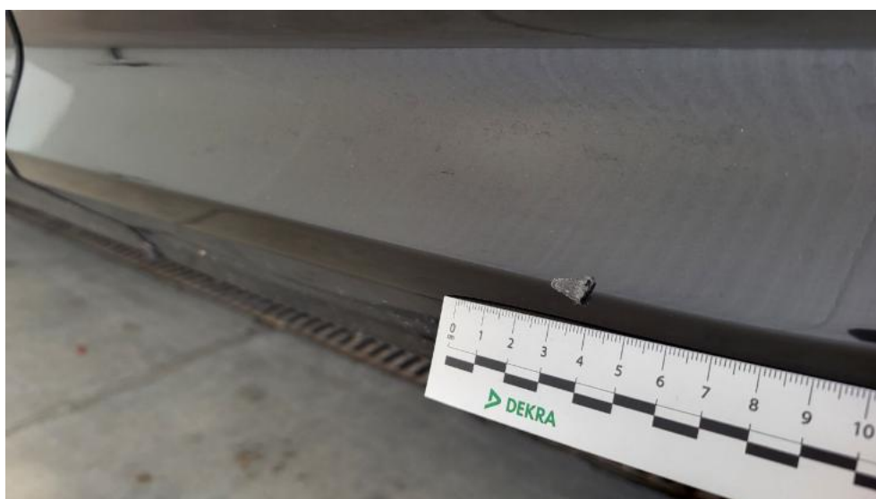
Photo 58. Listwa drzwi tył L - Rysa/odprysk 1
