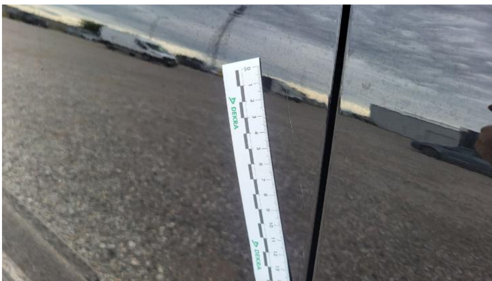
Photo 46. Drzwi przednie P - Rysa/odprysk 1
