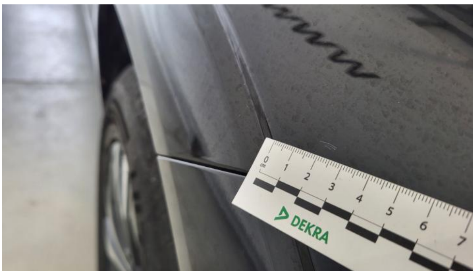
Photo 45. Błotnik przedni P - Rysa/odprysk 1
