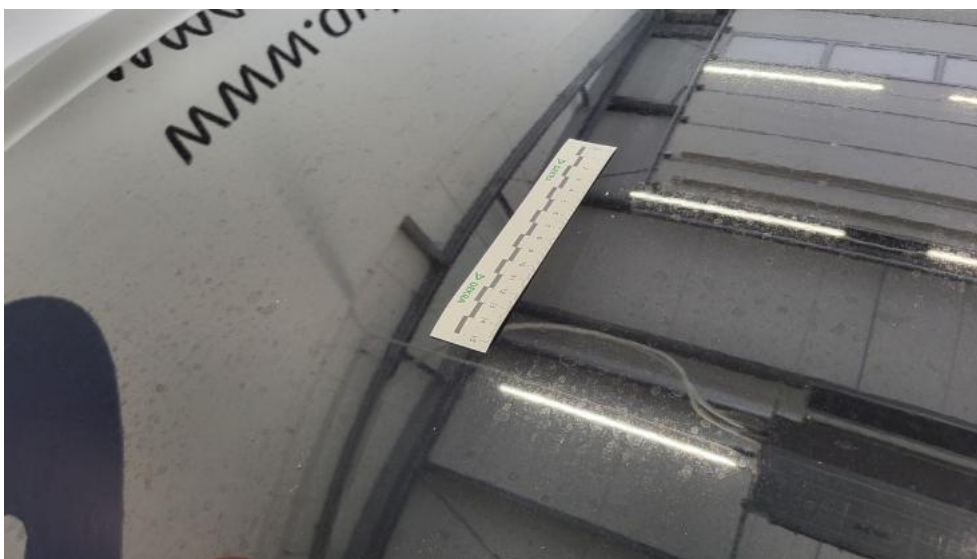
Photo 43. Pokrywa komory silnika - Rysa/odprysk 1
