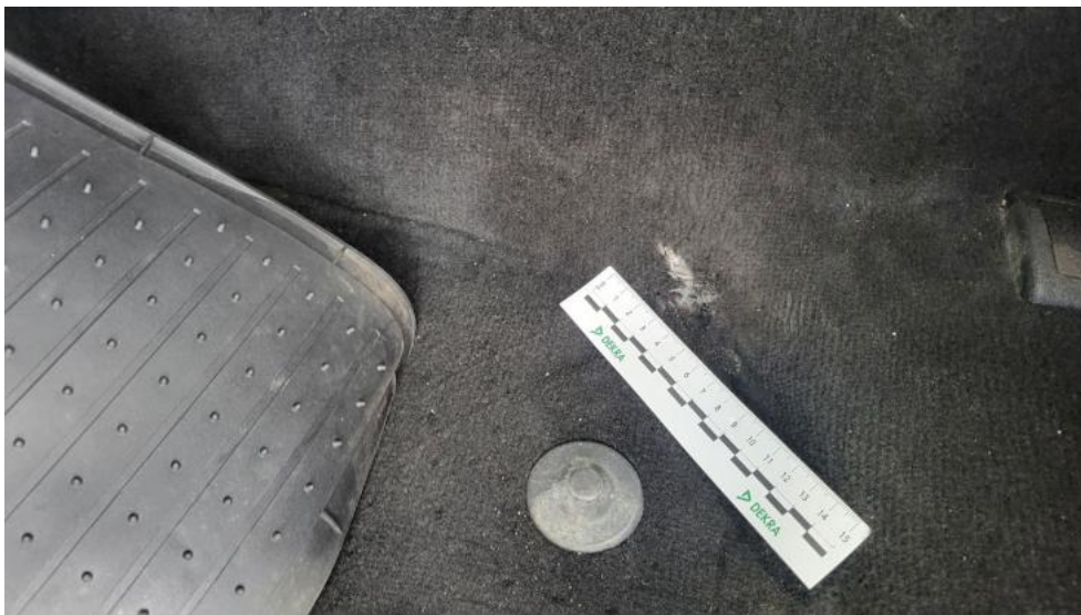
Fot. 103. Wykładzina podłogi - Pęknięcie/rozerwanie 1
