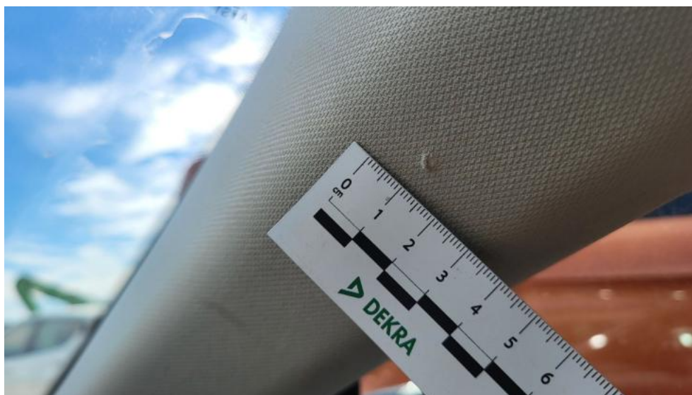
Fot. 101. Wykładzina(y) słupka przedniego P - Pęknięcie/rozerwanie 1
