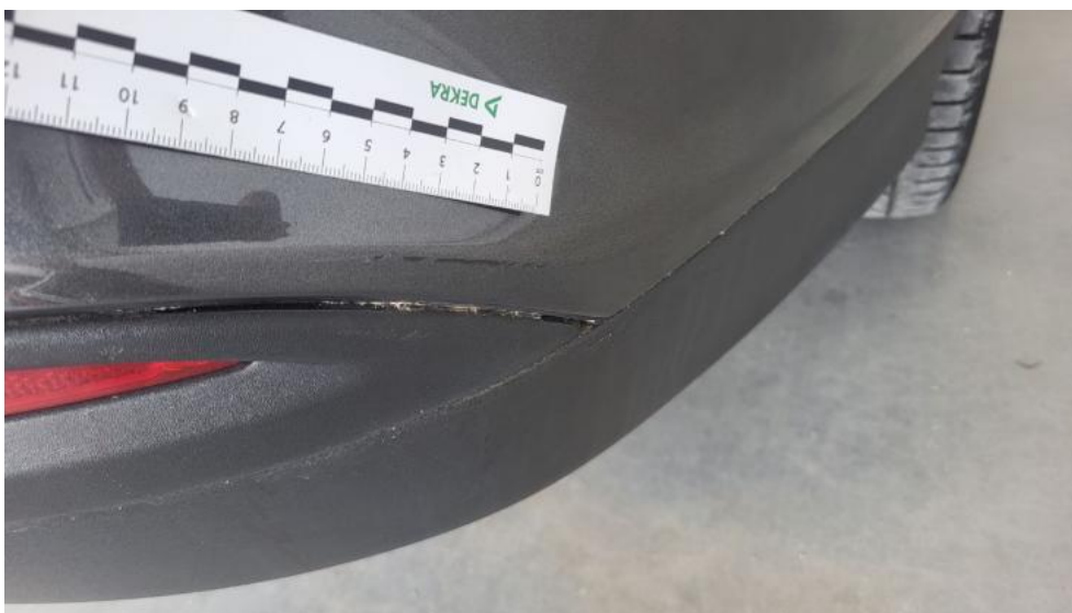
Fot. 69. Zderzak tylny - Rysa/odprysk 1
