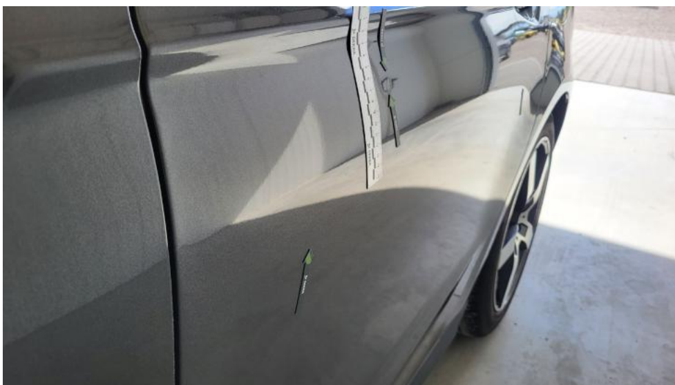
Fot. 82. Drzwi tylne L - Wgniecenie/odkształcenie 1
