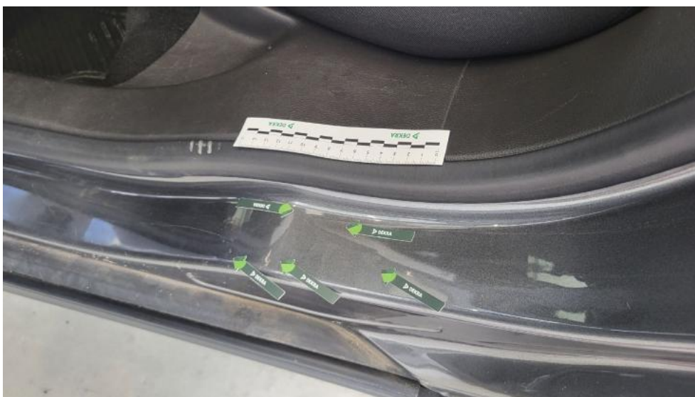
Fot. 84. Próg L - Wgniecenie/odkształcenie 1
