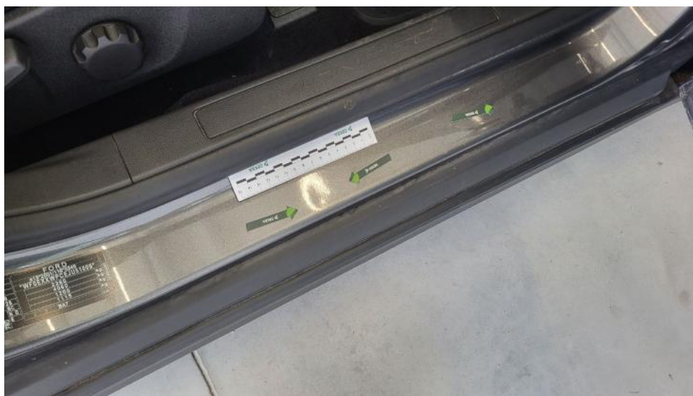
Fot. 61. Próg P - Wgniecenie/odkształcenie 1
