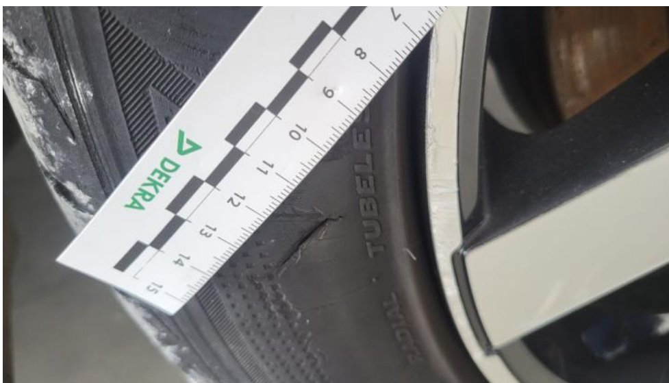
Fot. 55. Opona przednia P - Pęknięcie/rozerwanie 1
