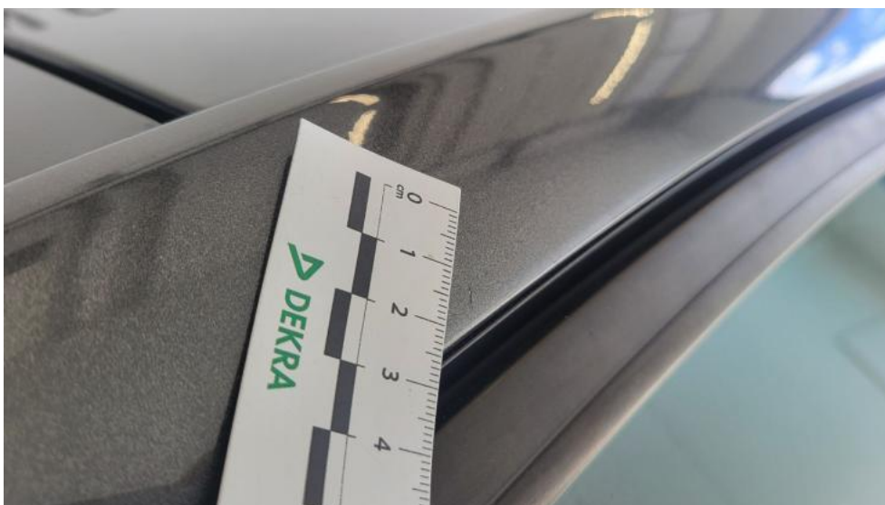
Fot. 86. Słupek przedni L - Rysa/odprysk 1
