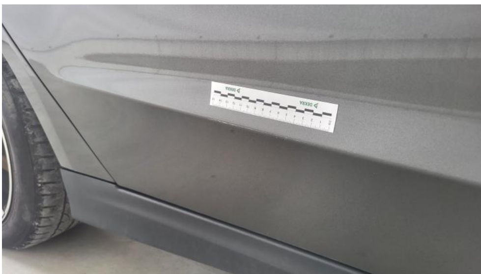
Fot. 58. Drzwi tylne P - Rysa/odprysk 1
