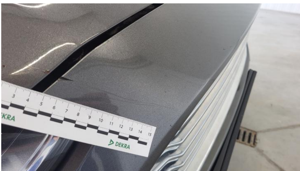
Fot. 46. Zderzak - Rysa/odprysk 2
