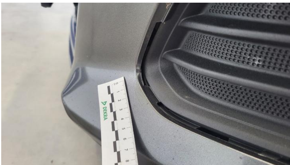
Fot. 50. Zderzak - Pęknięcie/rozerwanie 2
