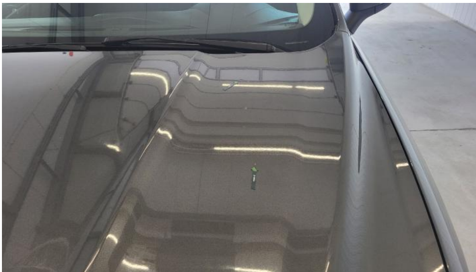
Fot. 43. Pokrywa komory silnika - Wgniecenie/odkształcenie 1
