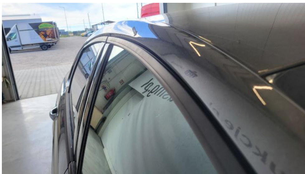
Fot. 62. Słupek przedni P - Wgniecenie/odkształcenie 1
