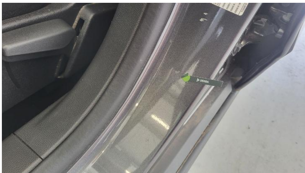
Fot. 88. Słupek środkowy L - Wgniecenie/odkształcenie 1
