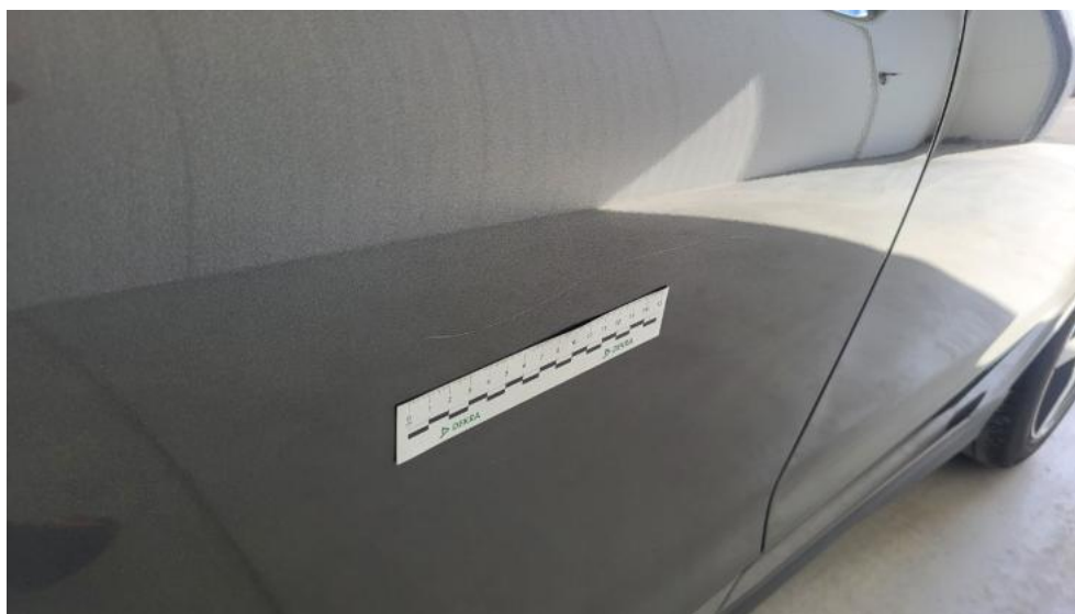
Fot. 79. Drzwi przed L - Rysa/odprysk 2
