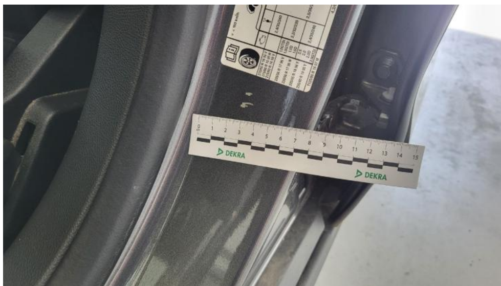
Fot. 87. Słupek środkowy L - Rysa/odprysk 1
