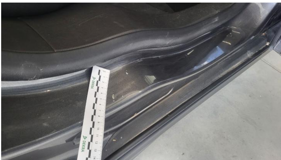
Fot. 60. Próg P - Rysa/odprysk 1
