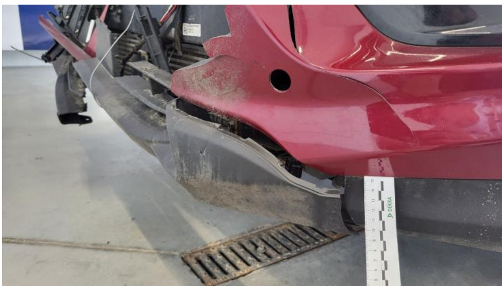
Photo 58. Zderzak przedni cz dolna - Pękniecie/rozerwanie 1
