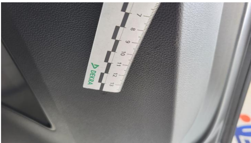
Fot. 48. Wykładzina pokrywy tylnej - Rysa/odprysk 1
