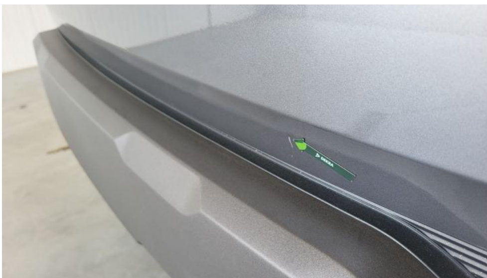
Fot. 46. Pokrywy bagażnika - Wgniecenie/odkształcenie 1
