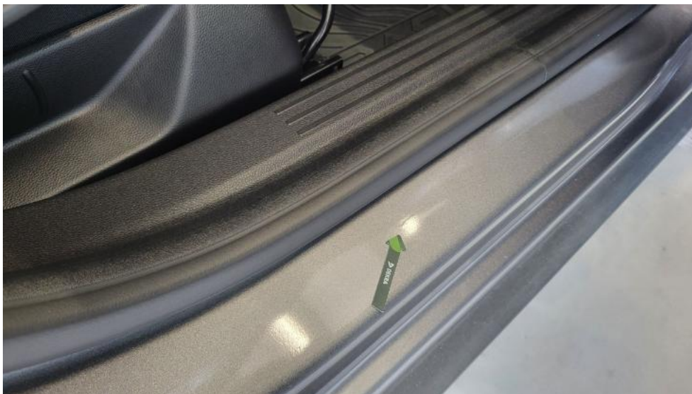
Fot. 43. Próg P - Wgniecenie/odkształcenie 1
