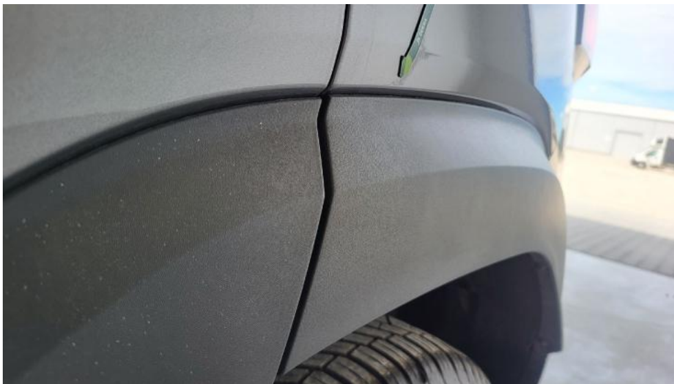
Fot. 47. Błotnik tylny L / Ściana boczna L - Wgniecenie/odkształcenie 1
