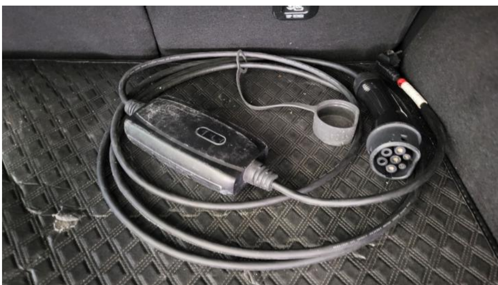
Fot. 32. Przewód ładowania baterii trakcyjnej
