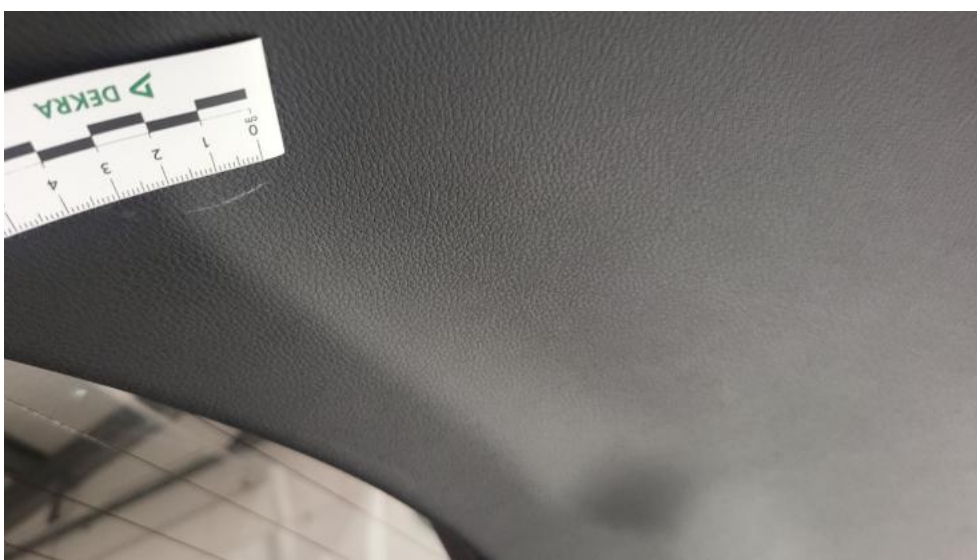
Fot. 84. Wykładzina pokrywy tylnej - Rysa/odprysk 1
