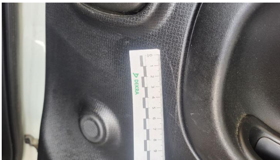
Photo 55. Tapicerka drzwi tylnych P - Rysa/odprysk 1
