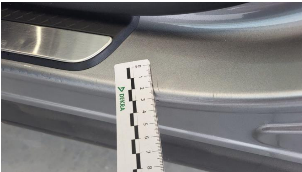
Photo 77. Próg L - Rysa/odprysk 1
