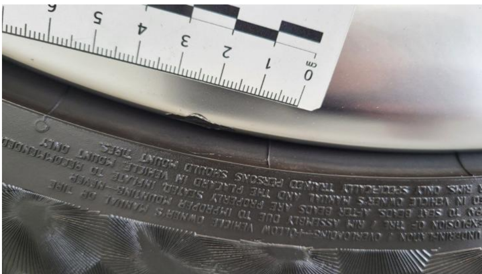
Photo 78. Felga Aluminiowa przednia L - Rysa/odprysk 1
