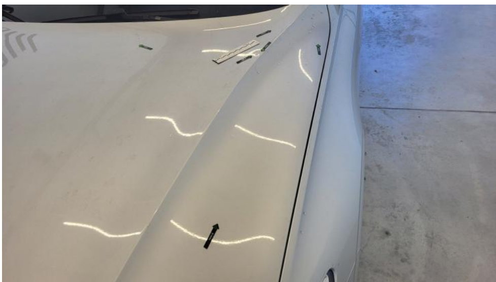
Fot. 52. Pokrywa komory silnika - Wgniecenie/odkształcenie 1
