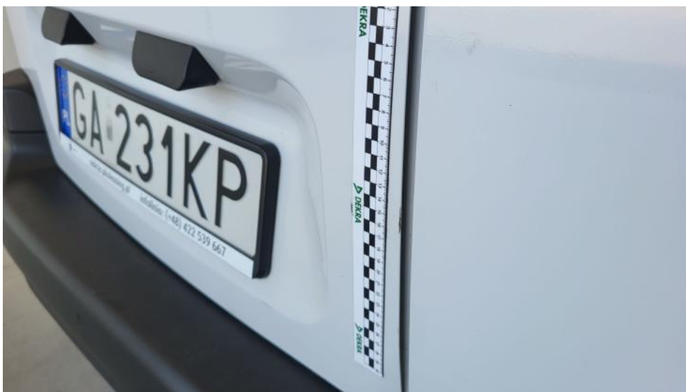
Fot. 37. Pokrywy bagażnika - Rysa/odprysk 1
