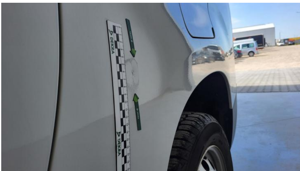
Fot. 38. Błotnik tylny L / Ściana boczna L - Wgniecenie/odkształcenie 1
