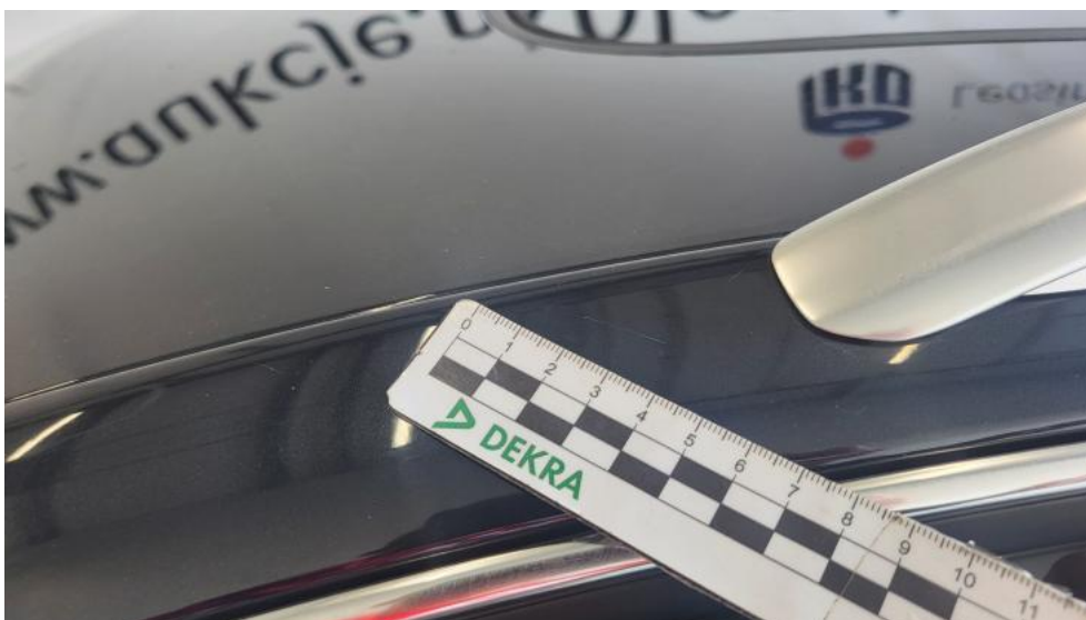
Fot. 66. Słupek przedni L - Rysa/odprysk 1
