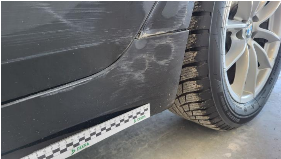
Fot. 57. Próg L - Rysa/odprysk 2
