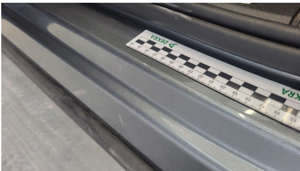
Photo 57. Próg L - Rysa/odprysk 1
