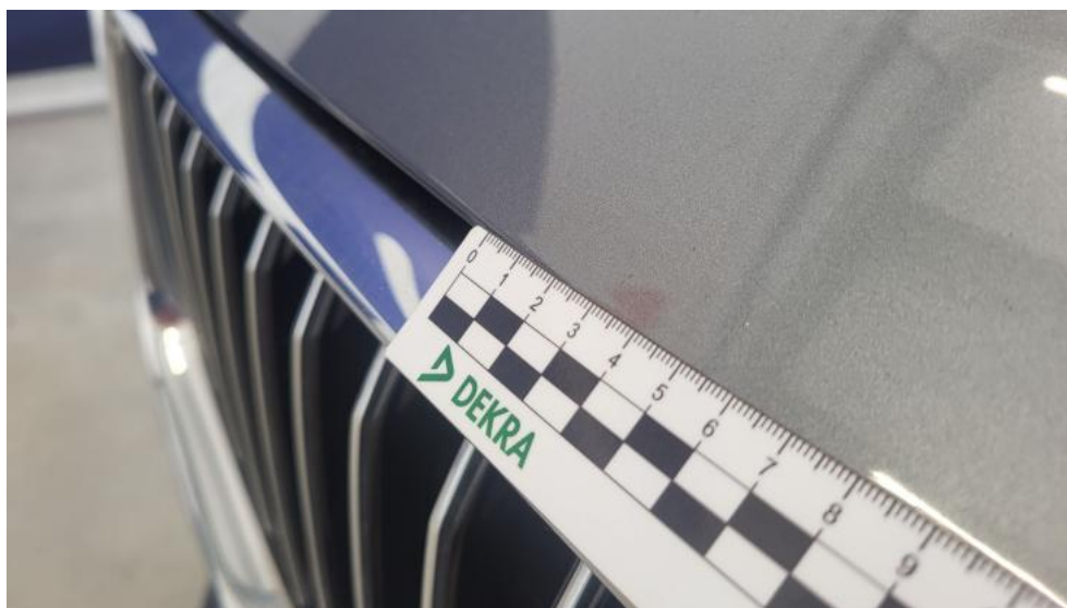
Photo 42. Pokrywa komory silnika - Rysa/odprysk 1
