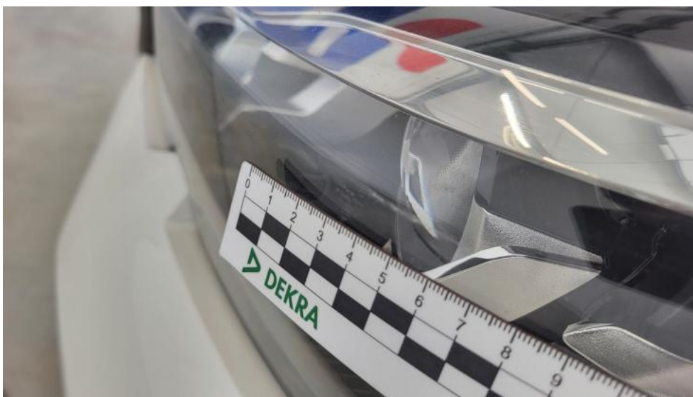
Fot. 51. Reflektor L - Rysa/odprysk 1
