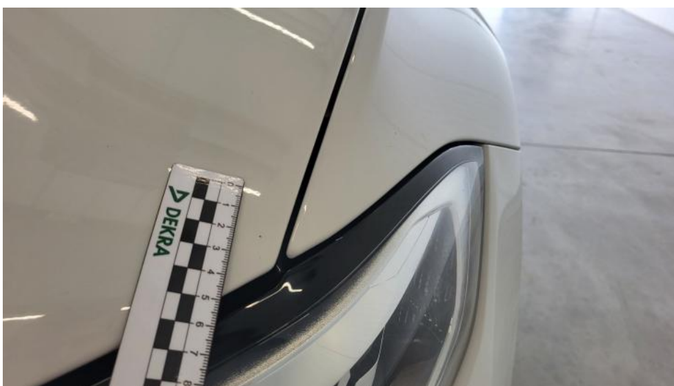
Fot. 38. Pokrywa komory silnika - Rysa/odprysk 1
