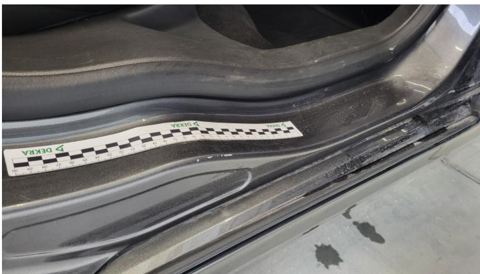
Fot. 45. Próg P - Rysa/odprysk 1
