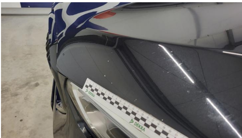
Fot. 48. Pokrywa komory silnika - Rysa/odprysk 1
