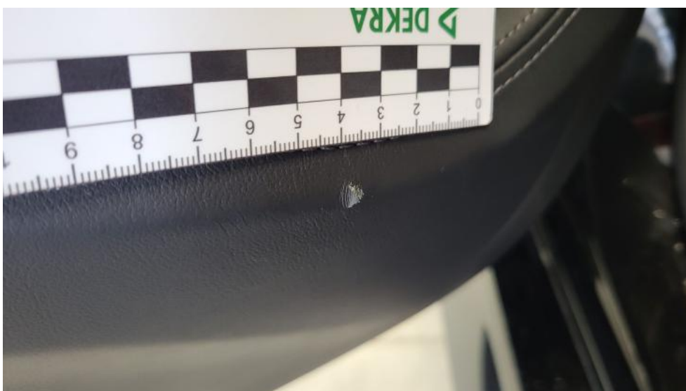
Fot. 82. Tapicerka drzwi tylnych L - Pęknięcie/rozerwanie 1
