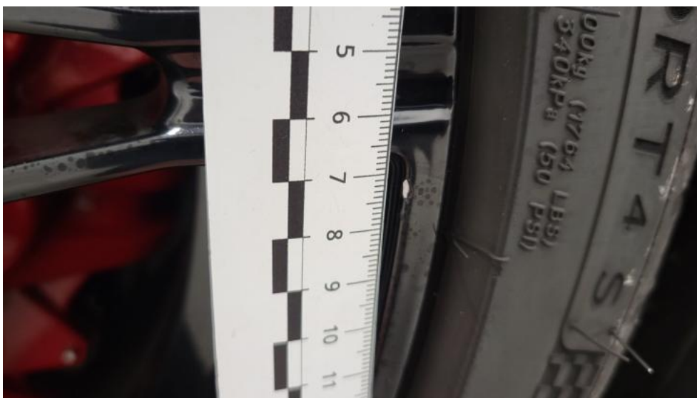
Fot. 62. Felga Aluminiowa przednia L - Rysa/odprysk 1
