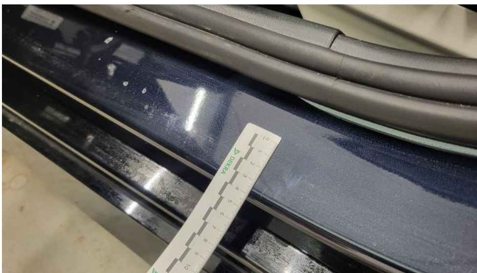
Fot. 57. Próg L - Rysa/odprysk 1
