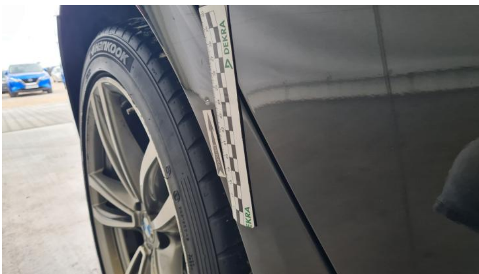
Fot. 59. Błotnik tylny P / Ściana boczna P - Wgniecenie/odkształcenie 2
