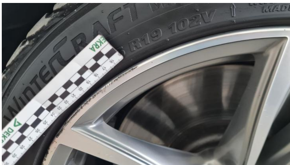
Fot. 71. Felga Aluminiowa przednia L - Rysa/odprysk 1
