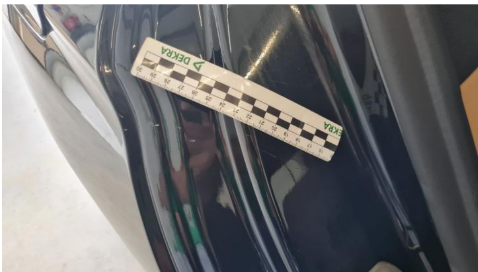
Fot. 56. Błotnik tylny P / Ściana boczna P - Rysa/odprysk 1
