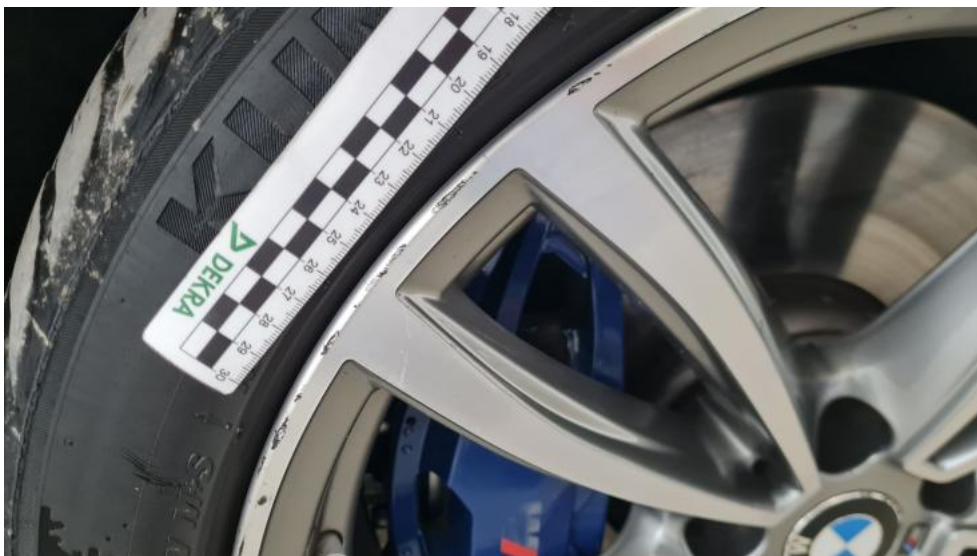
Fot. 53. Felga aluminiowa przednia P - Rysa/odprysk 1
