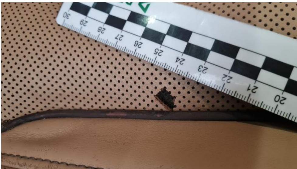
Fot. 77. Kanapa tyl. - Pęknięcie/rozerwanie 1
