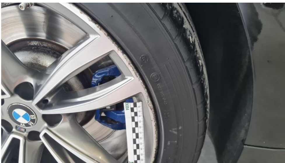
Fot. 60. Felga aluminiowa tylna P - Rysa/odprysk 1
