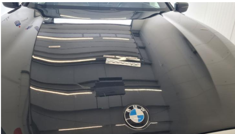
Fot. 44. Pokrywa komory silnika - Wgniecenie/odkształcenie 1
