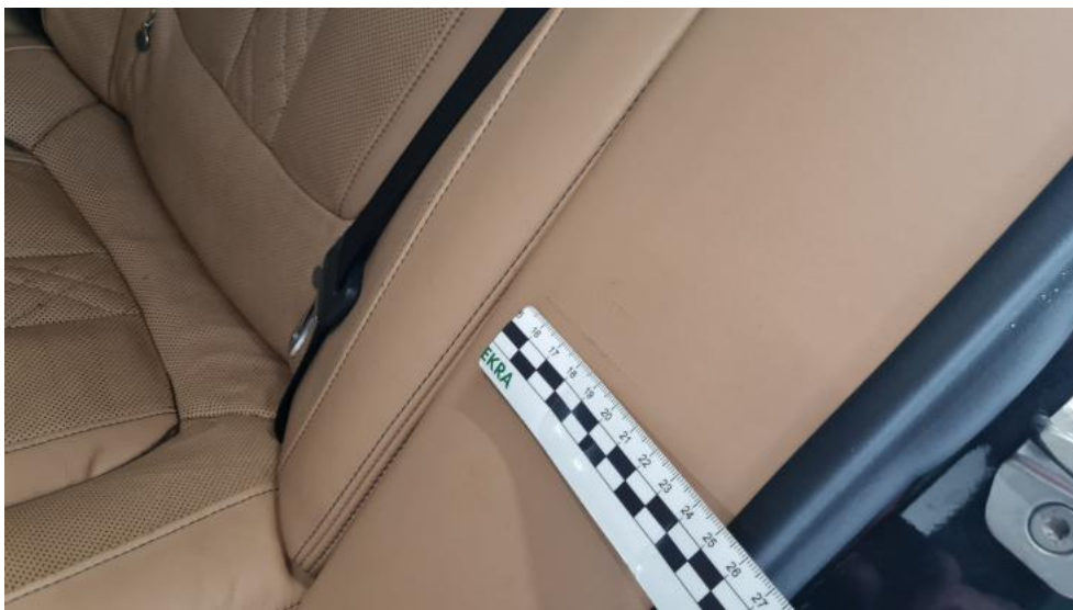
Fot. 79. Wykładzina(y) słupka tylnego L - Rysa/odprysk 1
