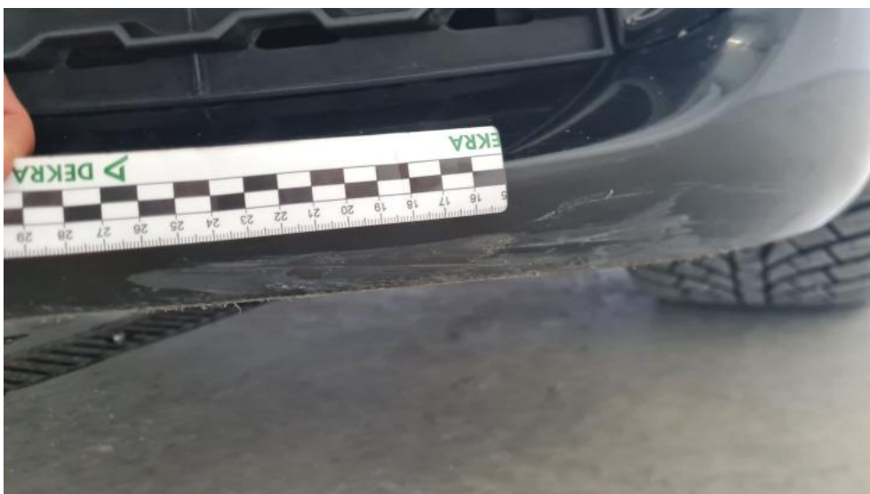
Fot. 50. Zderzak - Rysa/odprysk 2
