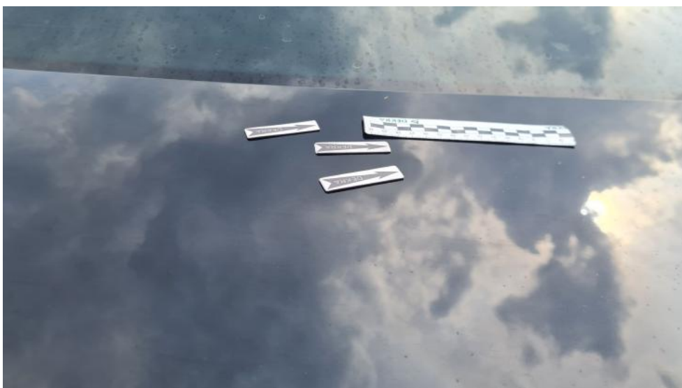
Fot. 62. Pokrywy bagażnika - Wgniecenie/odkształcenie 2
