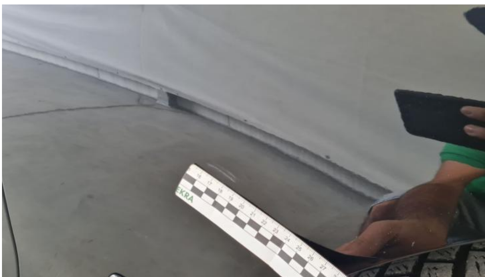
Fot. 52. Błotnik przedni P - Rysa/odprysk 1
