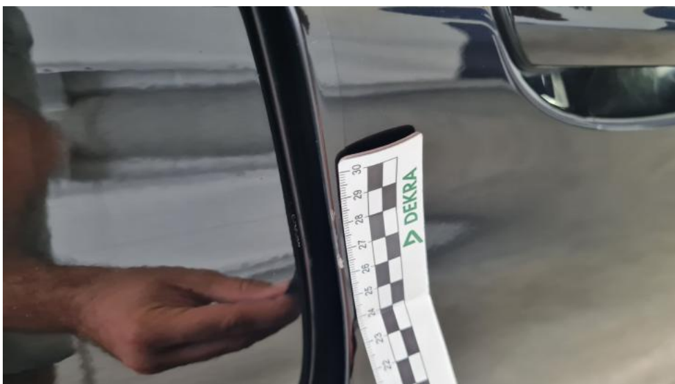
Fot. 54. Drzwi przednie P - Rysa/odprysk 1
