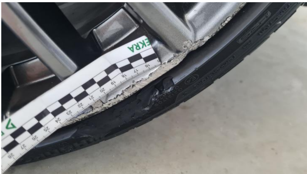
Photo 49. Opona przednia P - Pęknięcie/rozerwanie 1
