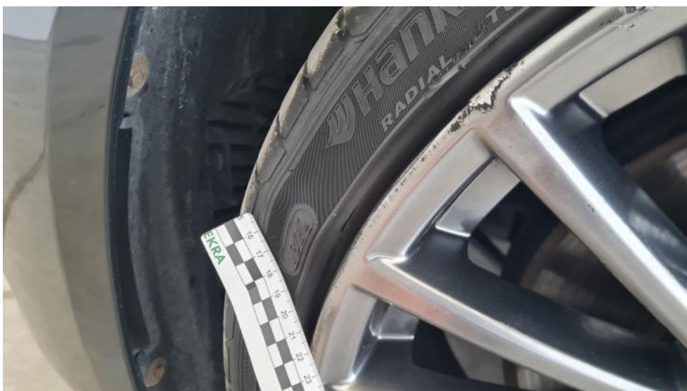
Photo 72. Opona przednia L - Wgniecenie/odkształcenie 1
