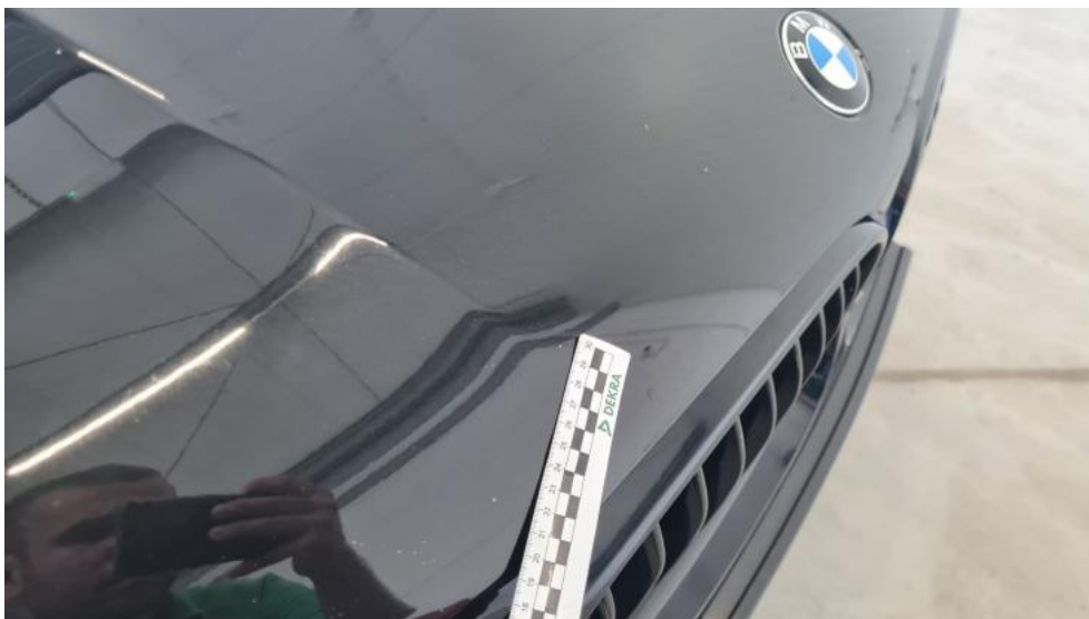
Photo 39. Pokrywa komory silnika - Rysa/odprysk 1
