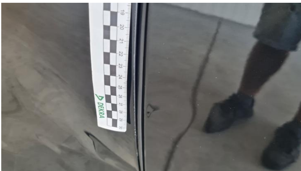
Photo 62. Drzwi przed L - Rysa/odprysk 1
