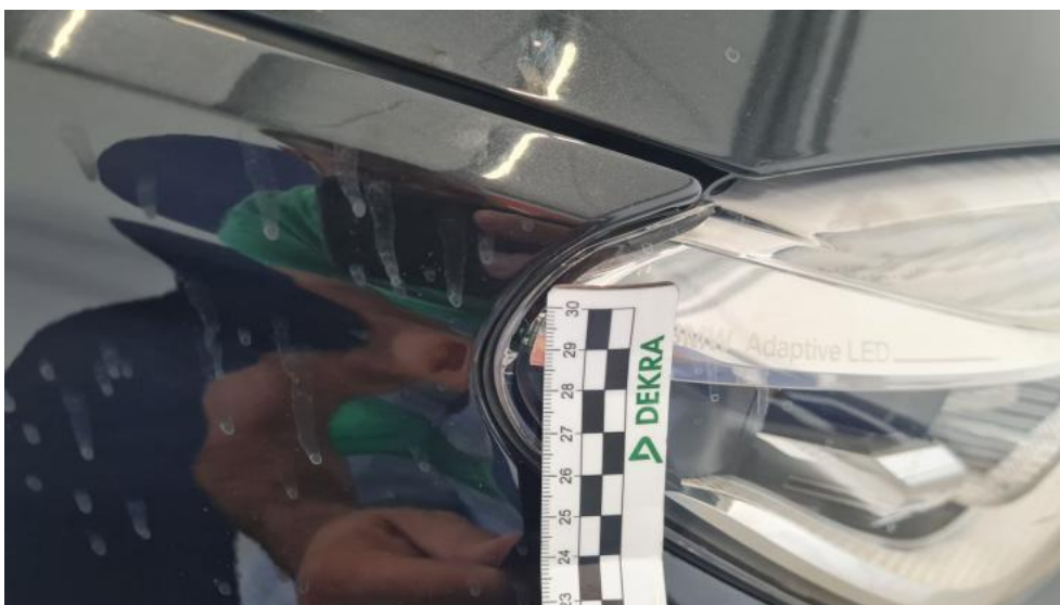
Photo 50. Reflektor P - Rysa/odprysk 1
