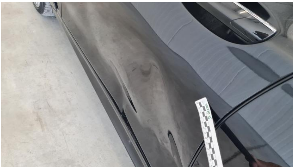
Photo 63. Drzwi przed L - Wgniecenie/odkształcenie 1
