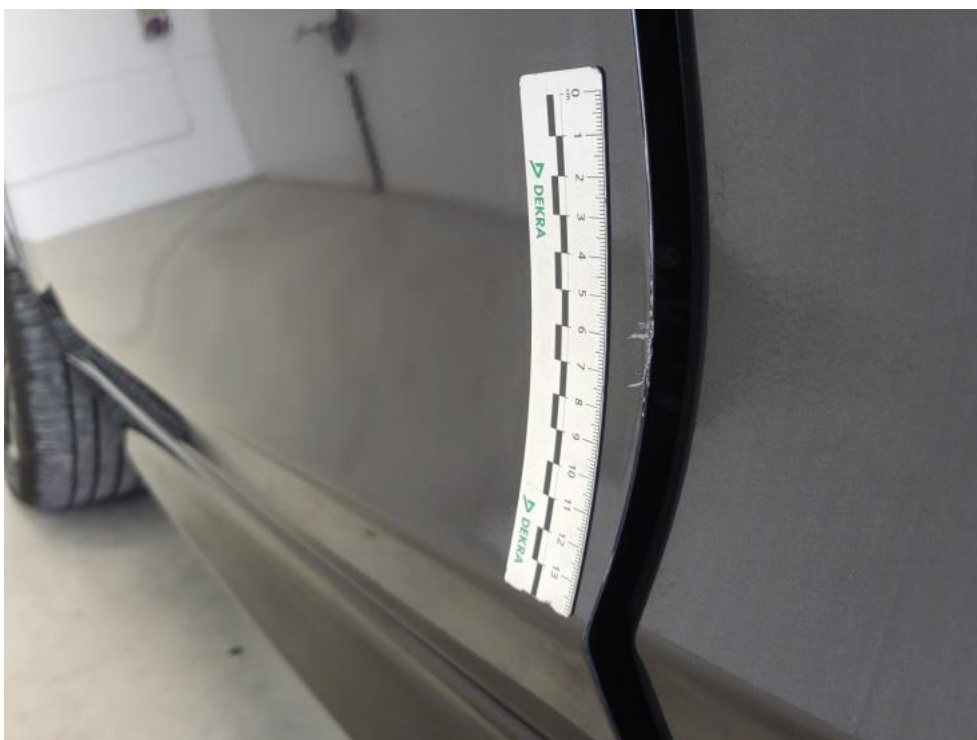
Photo 56. Drzwi przed L - Rysa/odprysk 1
