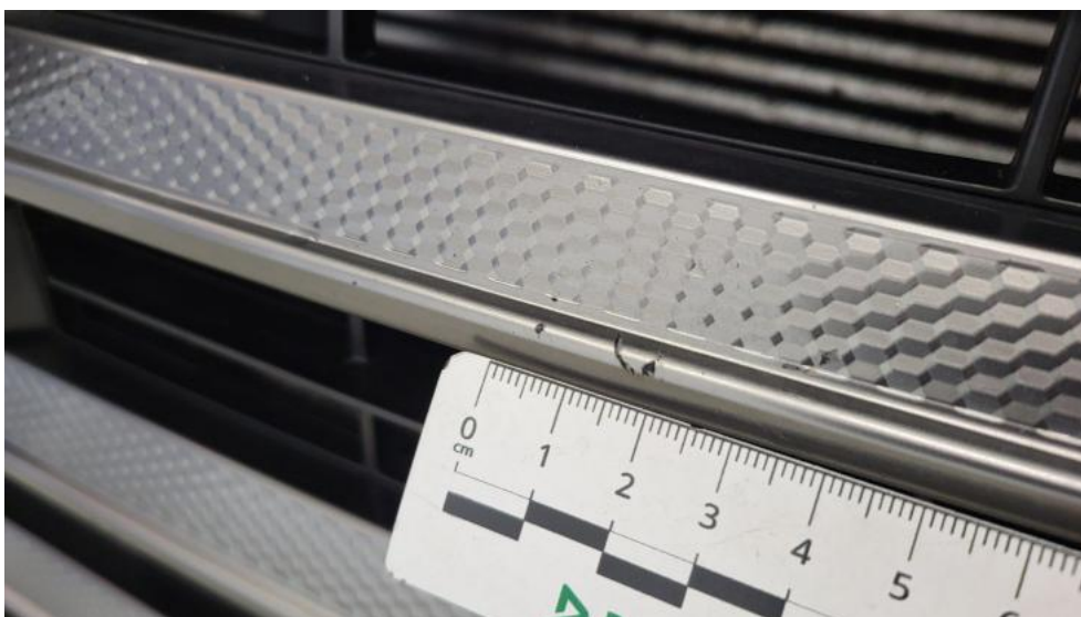
Fot. 42. Atrapa przednia - Rysa/odprysk 1
