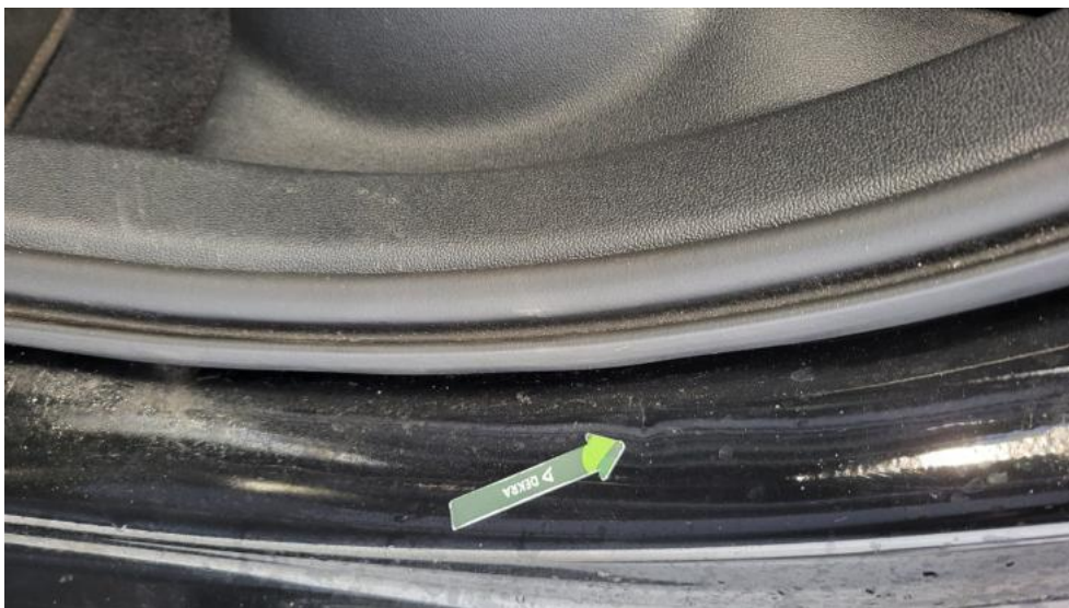
Fot. 65. Próg L - Wgniecenie/odkształcenie 1
