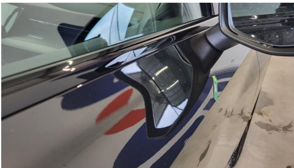
Fot. 46. Drzwi przednie P - Wgniecenie/odkształcenie 1
