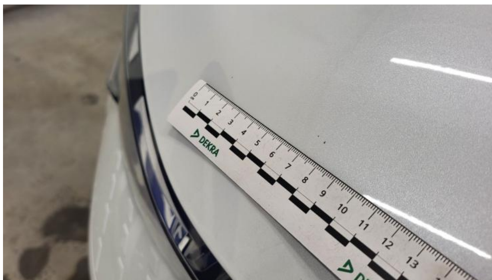
Photo 40. Pokrywa komory silnika - Rysa/odprysk 1
