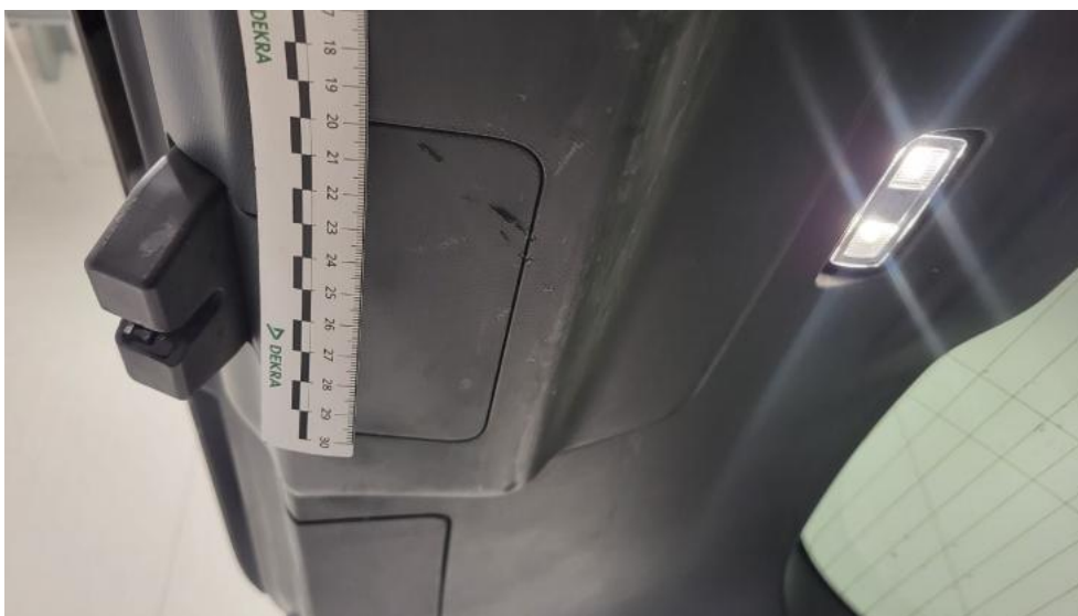
Photo 74. Wykładzina pokrywy tylnej - Rysa/odprysk 1
