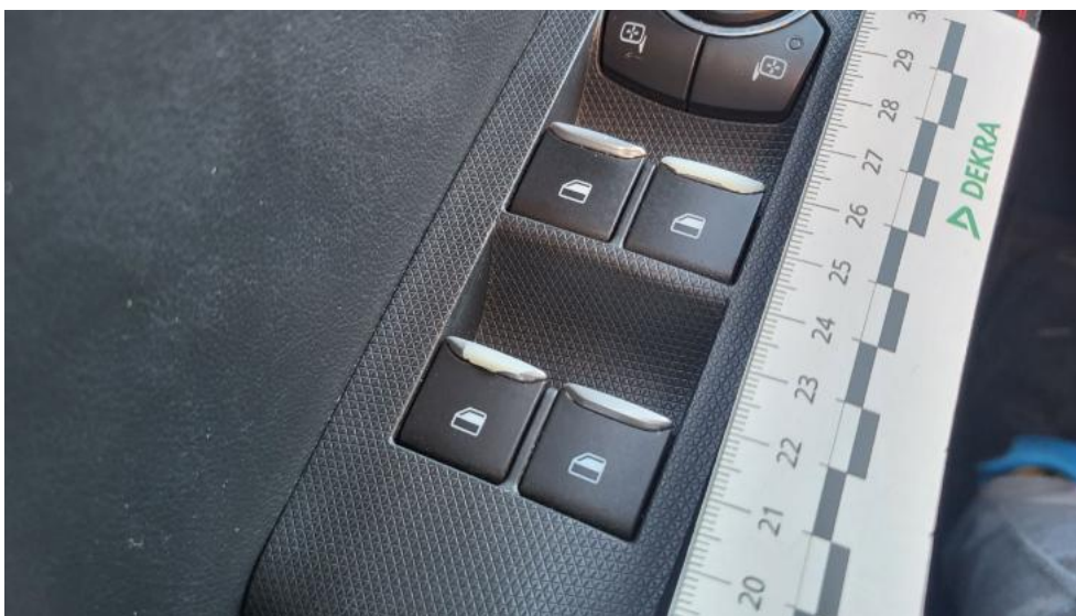
Photo 69. Włączniki/przełączniki drzwi prz L - Rysa/odprysk 1
