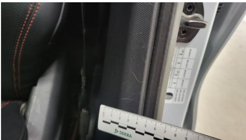
Photo 70. Wykładzina(y) słupka środkowego L - Rysa/odprysk 1
