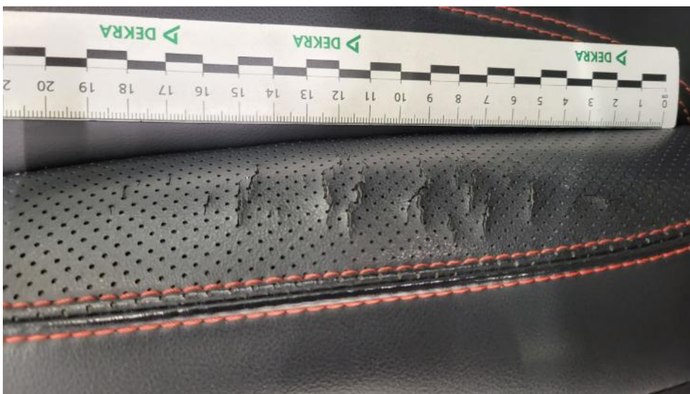
Photo 64. Fotel prz. lew. - Pęknięcie/rozerwanie 1
