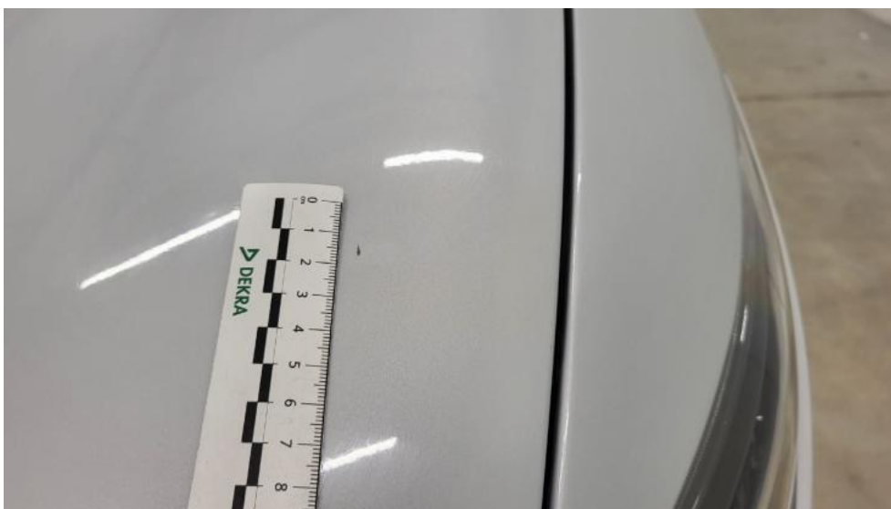
Photo 46. Pokrywa komory silnika - Rysa/odprysk 1
