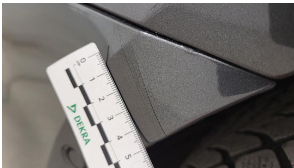
Fot. 49. Zderzak - Pęknięcie/rozerwanie 1
