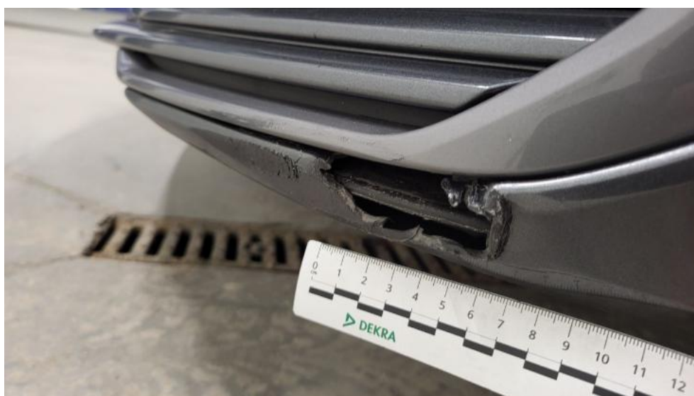
Fot. 50. Zderzak - Pęknięcie/rozerwanie 2
