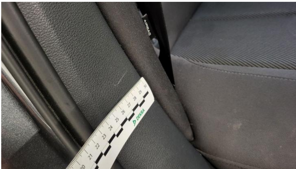
Fot. 69. Wykładzina(y) słupka tylnego P - Rysa/odprysk 1
