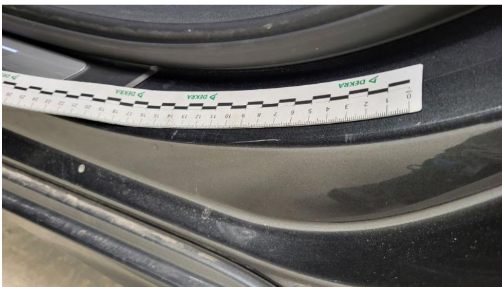
Fot. 59. Próg L - Rysa/odprysk 1
