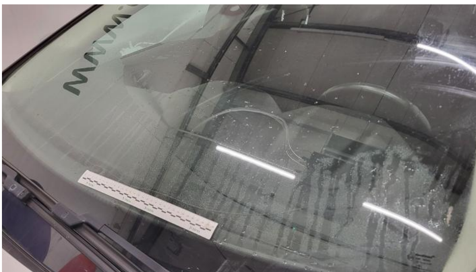
Photo 57. Szyba czołowa - Pęknięcie/rozerwanie 1
