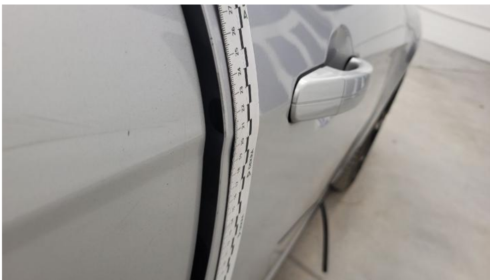
Photo 76. Drzwi przednie P - Rysa/odprysk 1
