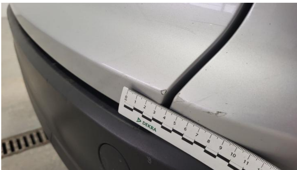
Photo 88. Pokrywy bagażnika - Rysa/odprysk 1
