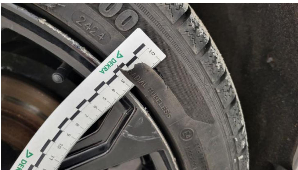
Photo 86. Opona tylna P - Pęknięcie/rozerwanie 1
