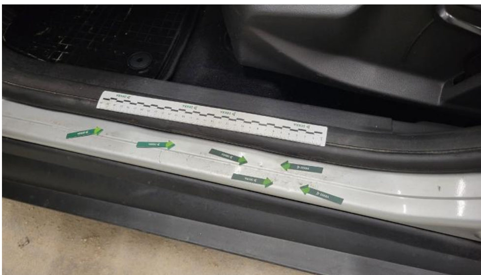
Photo 105. Próg L - Wgniecenie/odkształcenie 1
