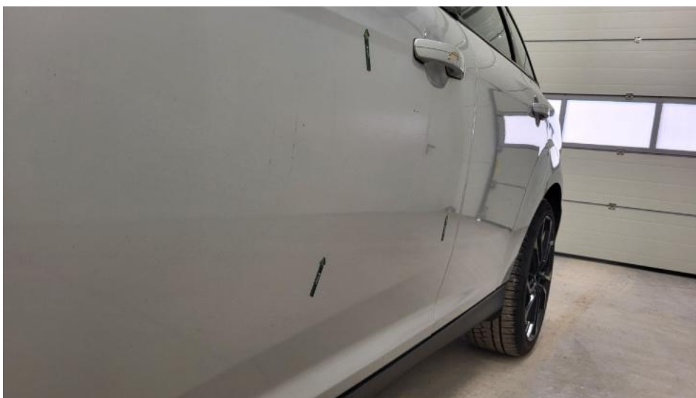
Photo 99. Drzwi przed L - Wgniecenie/odkształcenie 1
