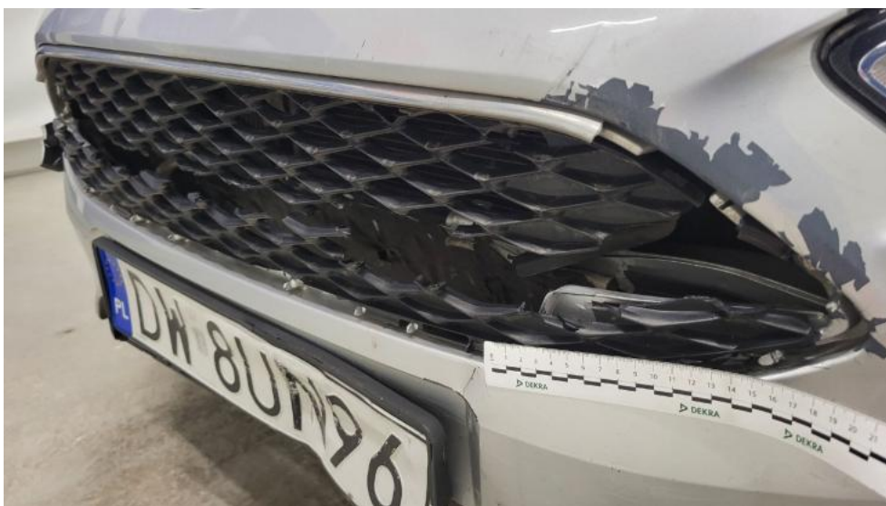
Photo 48. Atrapa przednia - Pęknięcie/rozerwanie 1
