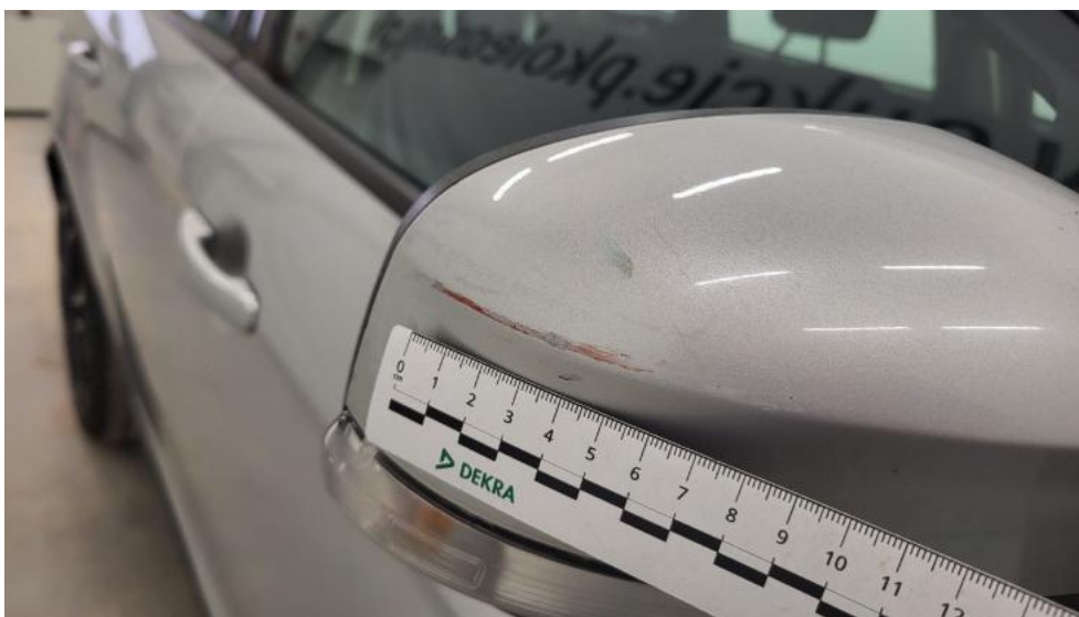
Photo 79. Lusterko zew P - Rysa/odprysk 1
