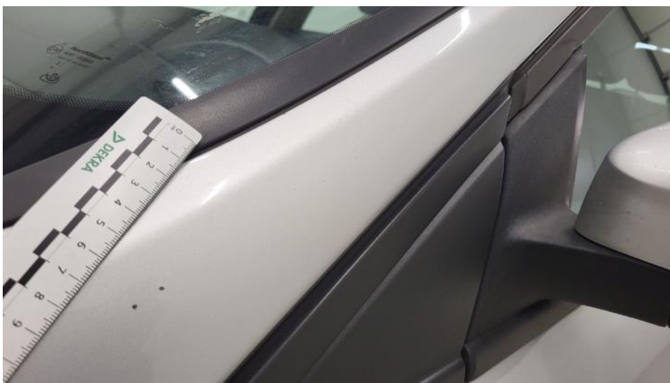
Photo 106. Słupek przedni L - Rysa/odprysk 1
