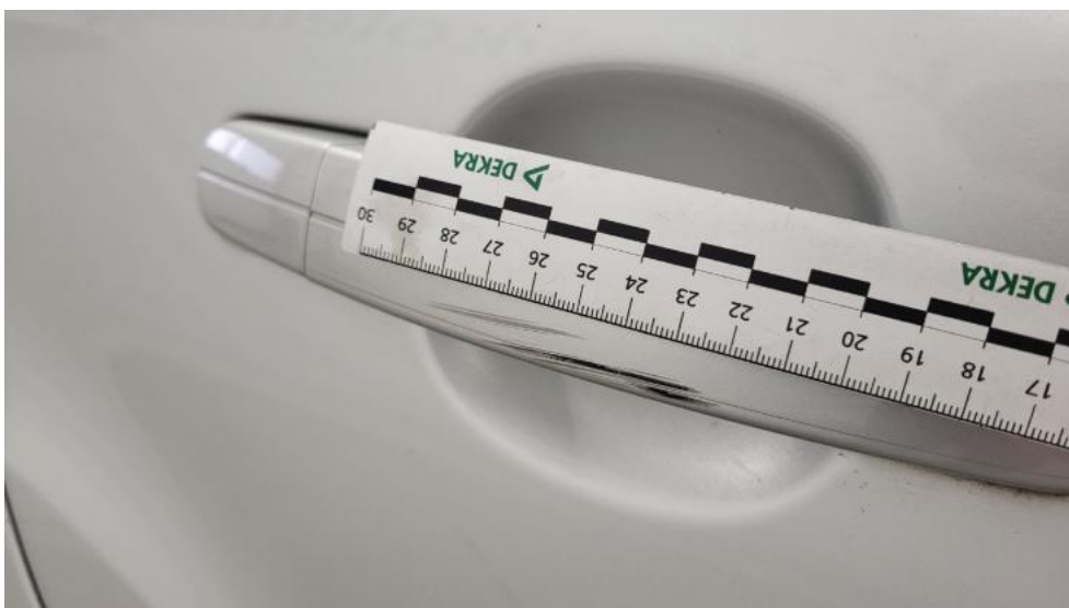
Photo 78. Klamka drzwi tyl P - Rysa/odprysk 1
