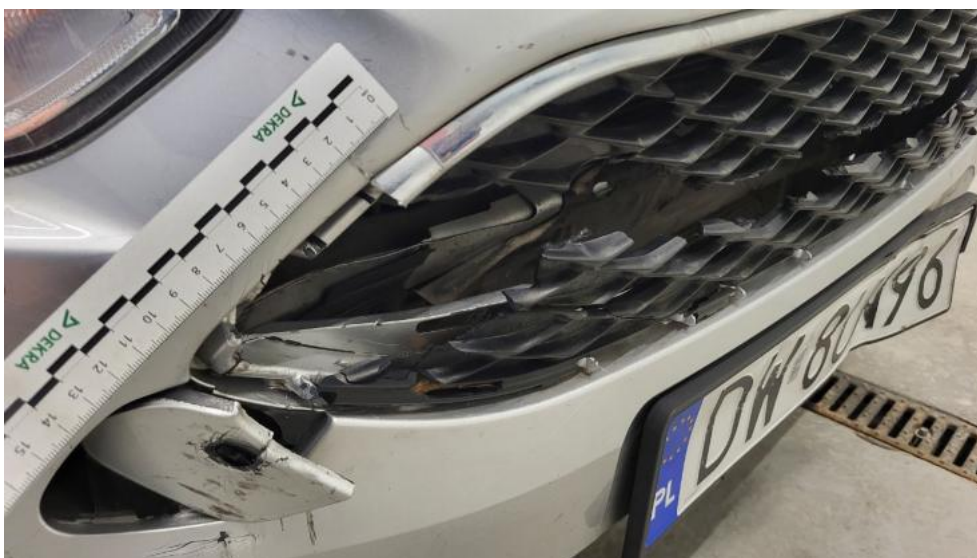
Photo 52. Listwa śr zderzaka przedniego - Pęknięcie/rozerwanie 1
