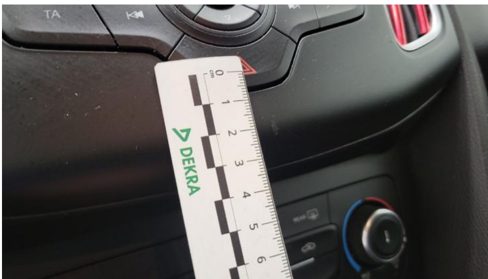
Photo 114. Konsola środkowa - Rysa/odprysk 1
