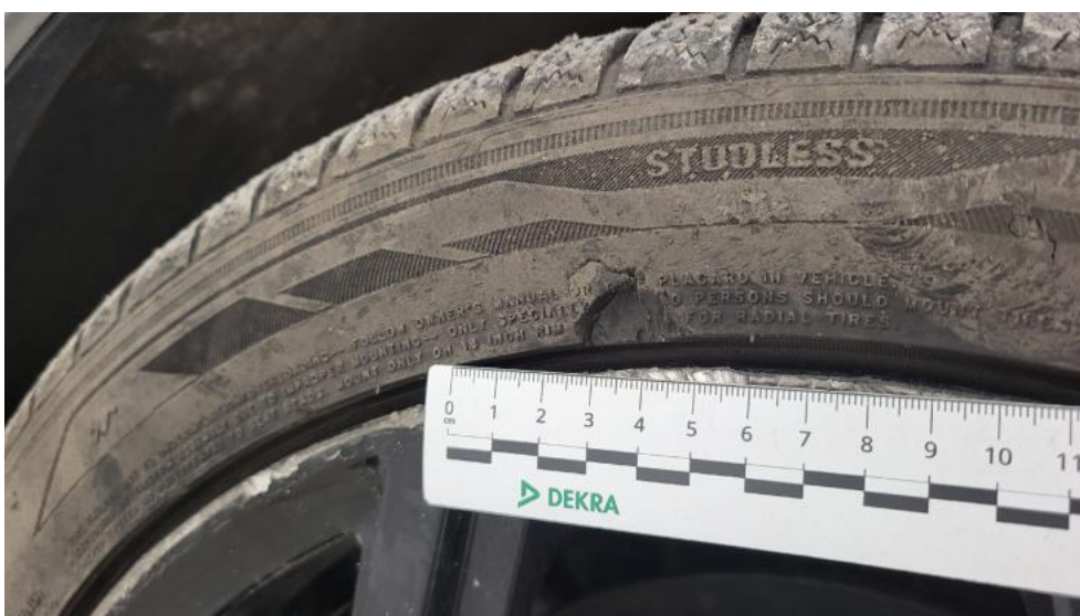
Photo 74. Opona przednia P - Pęknięcie/rozerwanie 1
