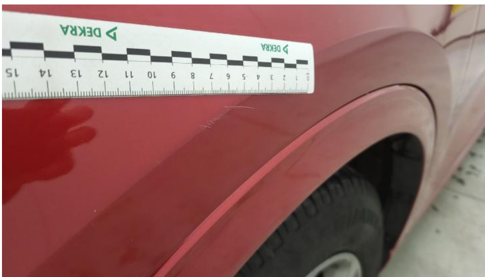
Photo 50. Błotnik przedni L - Rysa/odprysk 1
