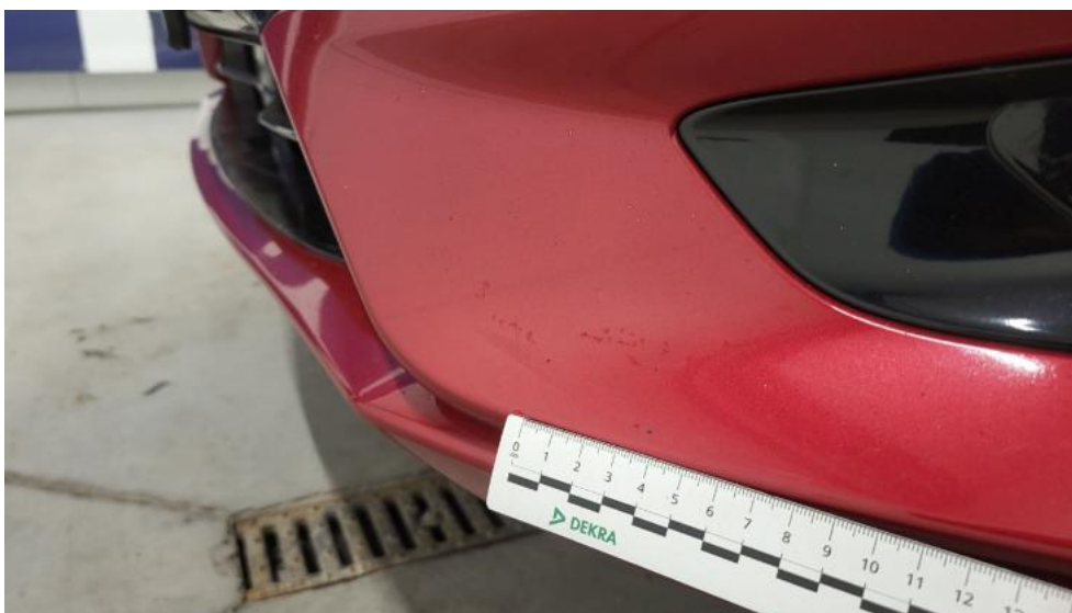
Photo 37. Kratka/zaślepka halogenu L - Rysa/odprysk 1
