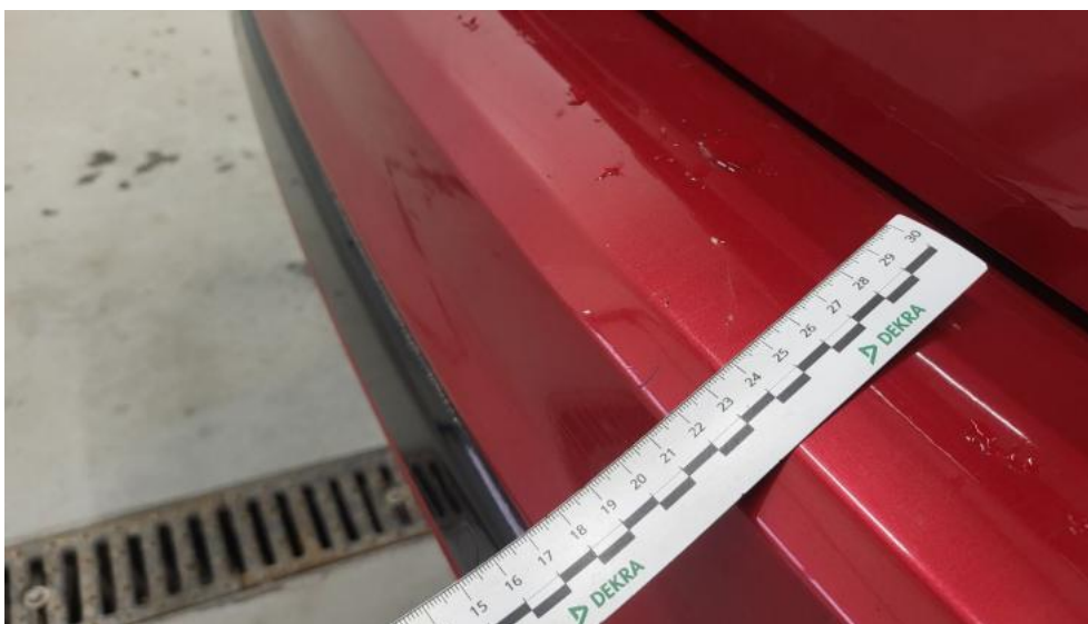
Photo 45. Zderzak tylny - Rysa/odprysk 1
