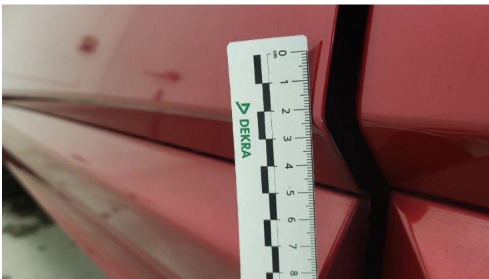
Photo 48. Drzwi przed L - Rysa/odprysk 1
