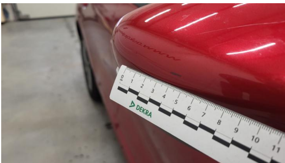
Photo 42. Lusterko zew P - Rysa/odprysk 1
