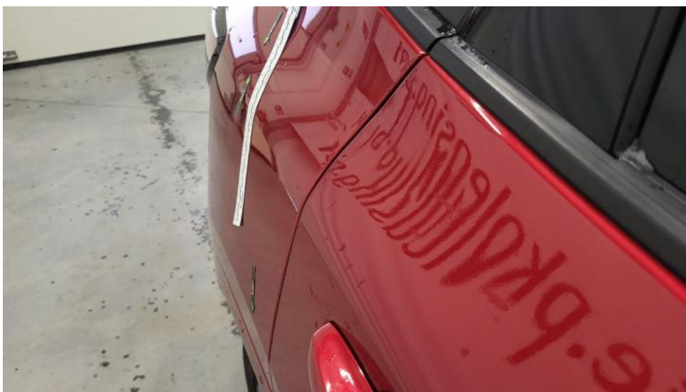
Photo 43. Błotnik tylny P / Ściana boczna P - Wgniecenie/odkształcenie 1
