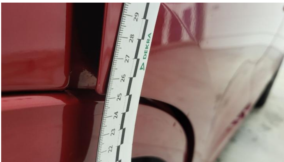
Photo 41. Drzwi tylne P - Rysa/odprysk 1
