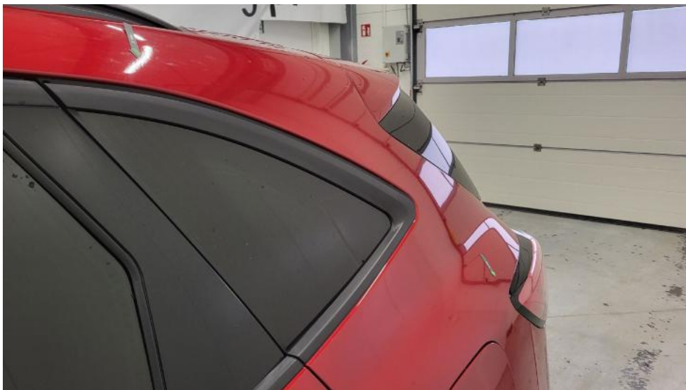
Photo 47. Błotnik tylny L / Ściana boczna L - Wgniecenie/odkształcenie 1
