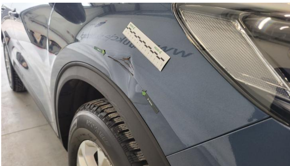
Fot. 37. Błotnik przedni P - Wgniecenie/odkształcenie 1
