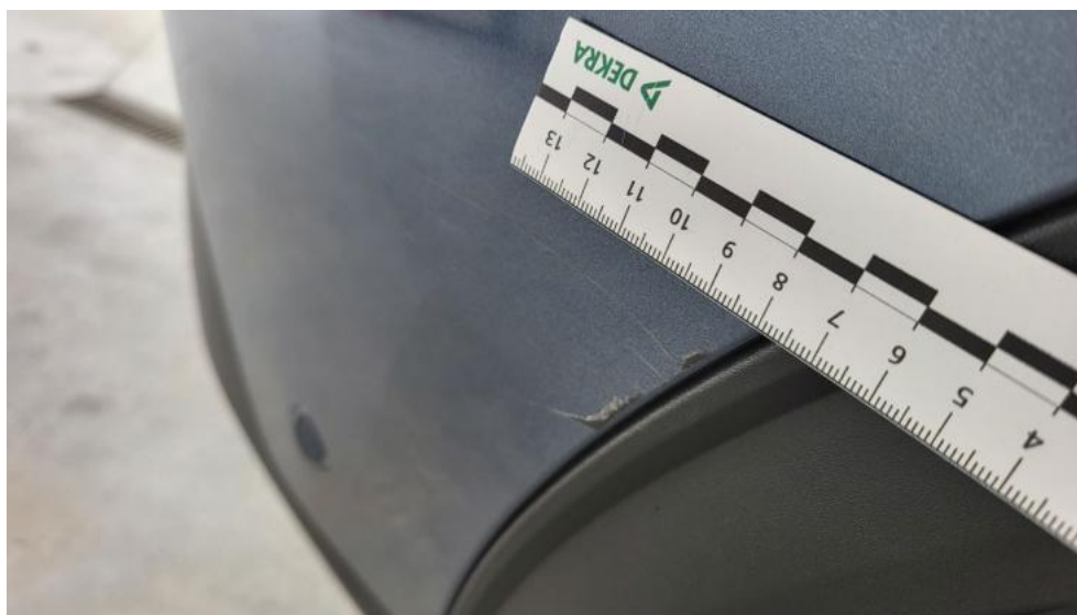
Fot. 45. Zderzak tylny - Rysa/odprysk 1
