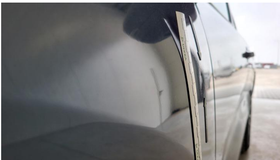
Fot. 51. Błotnik przedni L - Wgniecenie/odkształcenie 1
