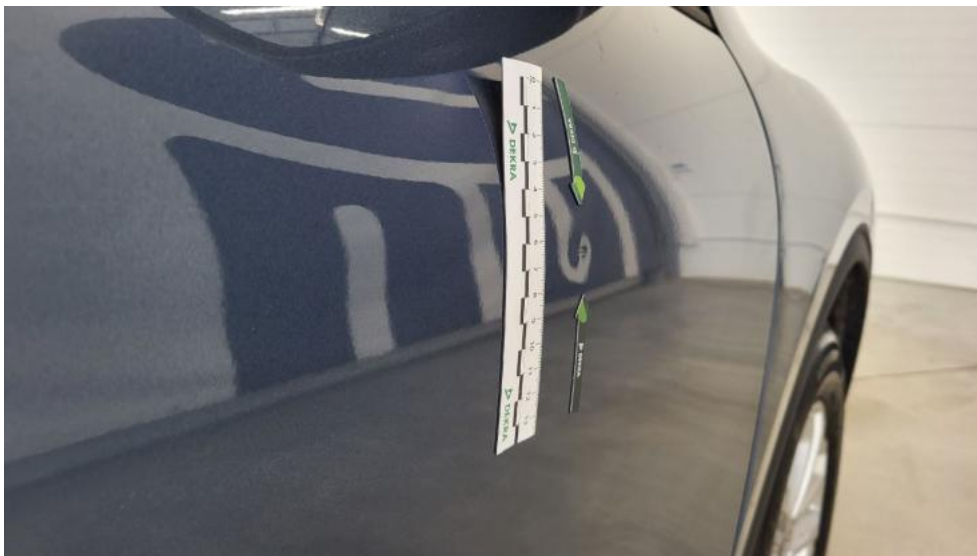
Fot. 39. Drzwi przednie P - Wgniecenie/odkształcenie 1
