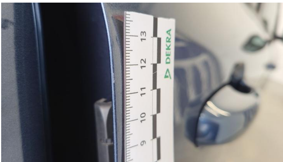
Fot. 40. Drzwi tylne P - Rysa/odprysk 1
