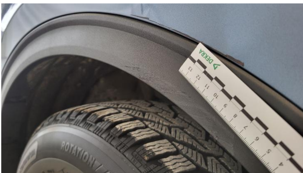
Fot. 38. Listwa krawędzi błotnika prz P - Rysa/odprysk 1
