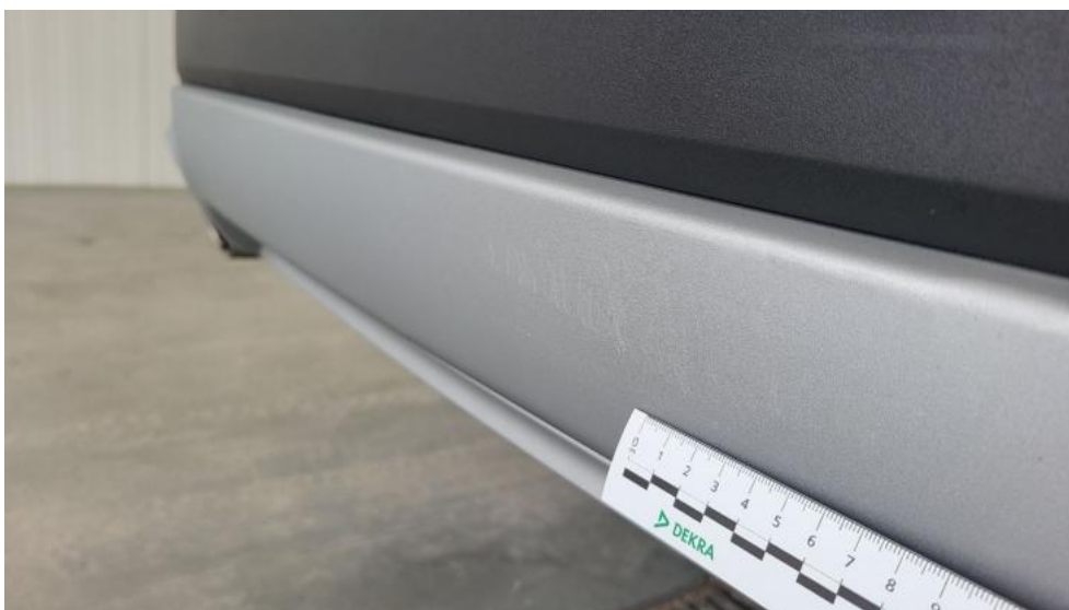
Fot. 44. Spojler zderzaka tylnego - Rysa/odprysk 1
