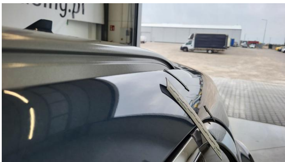
Fot. 48. Błotnik tylny L / Ściana boczna L - Wgniecenie/odkształcenie 1
