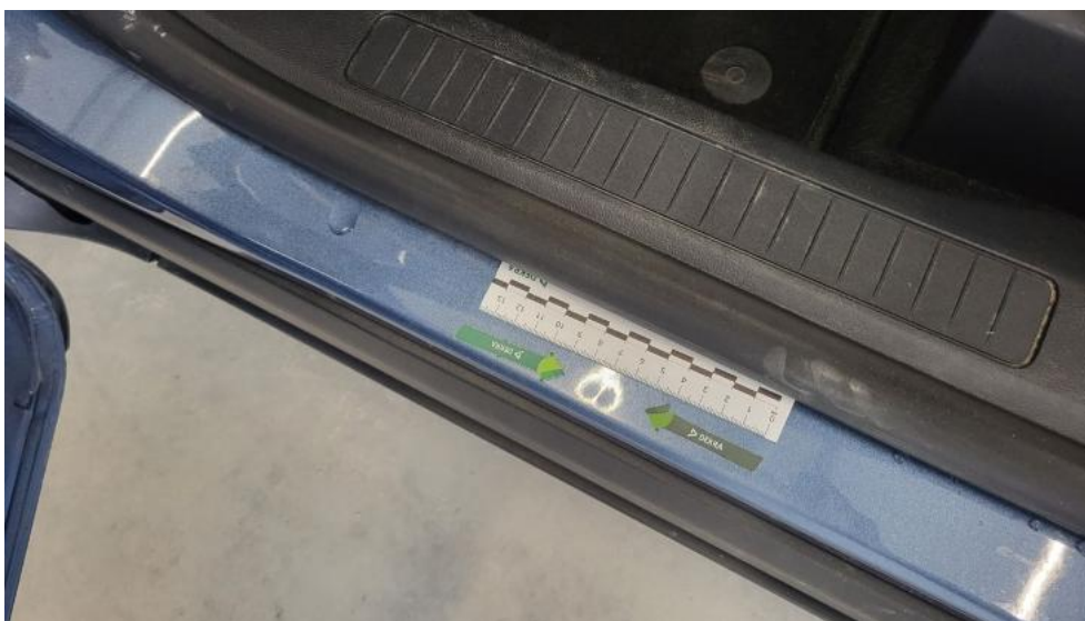
Fot. 49. Próg L - Wgniecenie/odkształcenie 1
