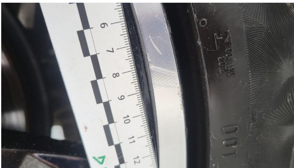
Photo 46. Felga aluminiowa tylna P - Rysa/odprysk 1
