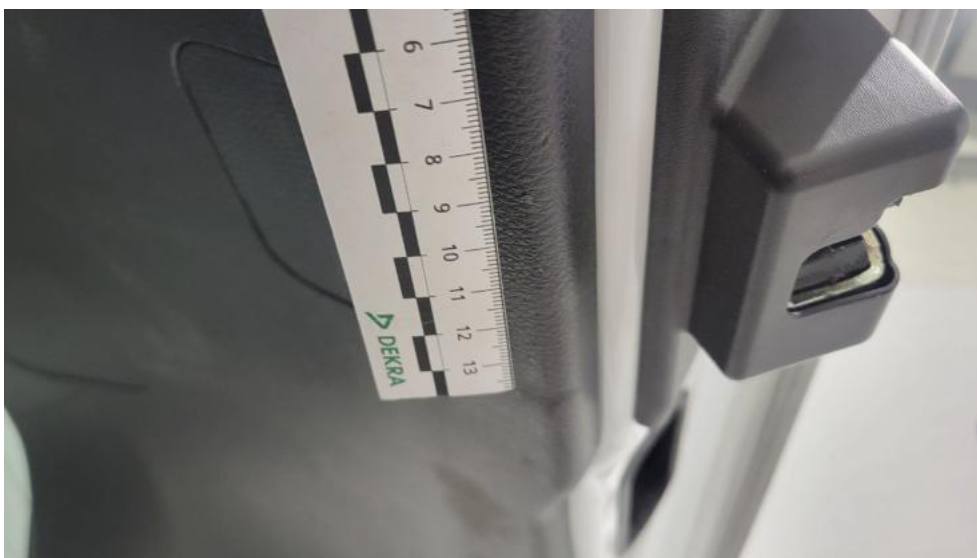
Photo 64. Wykładzina pokrywy tylnej - Rysa/odprysk 1
