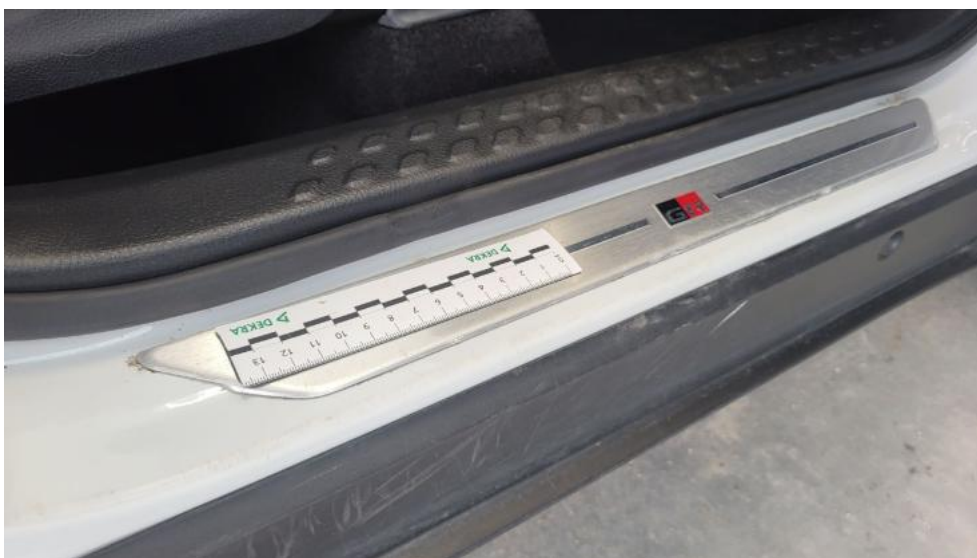
Photo 44. Próg P - Rysa/odprysk 1
