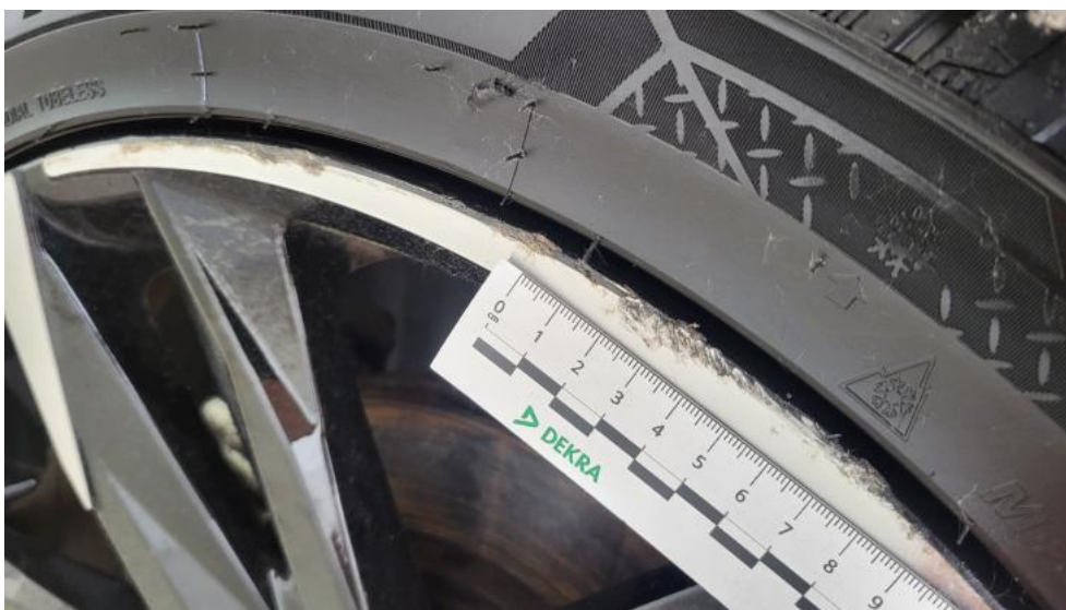
Photo 59. Felga Aluminiowa przednia L - Rysa/odprysk 1
