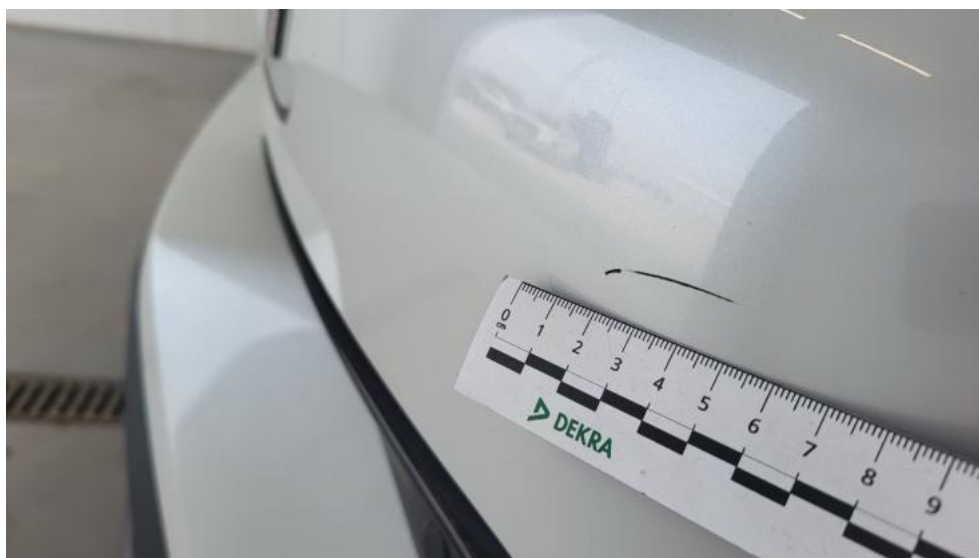
Photo 48. Zderzak tylny - Rysa/odprysk 1
