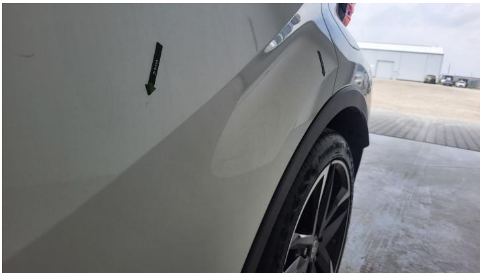
Photo 57. Drzwi tylne L - Wgniecenie/odkształcenie 1
