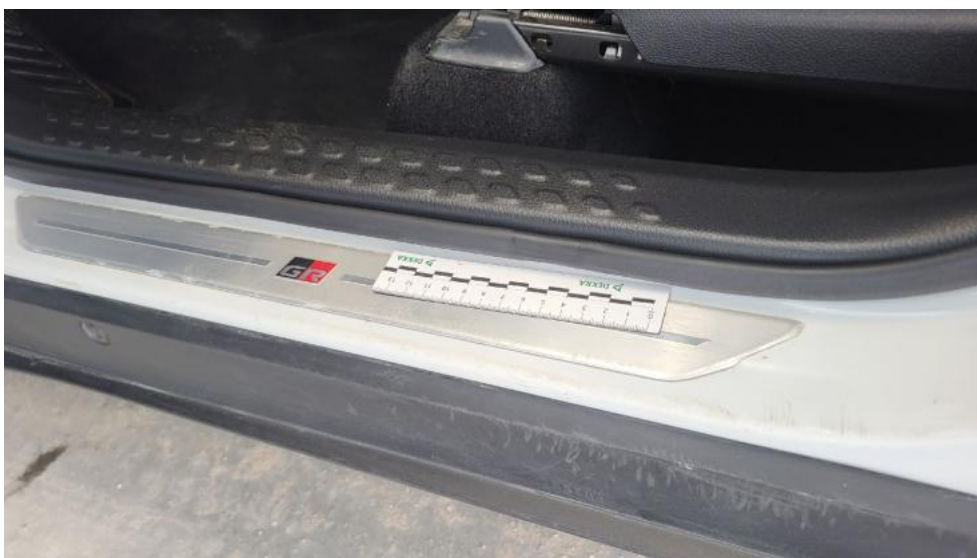
Photo 58. Próg L - Rysa/odprysk 1
