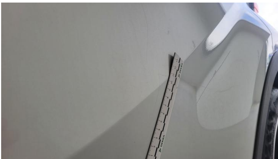
Photo 56. Drzwi tylne L - Rysa/odprysk 2
