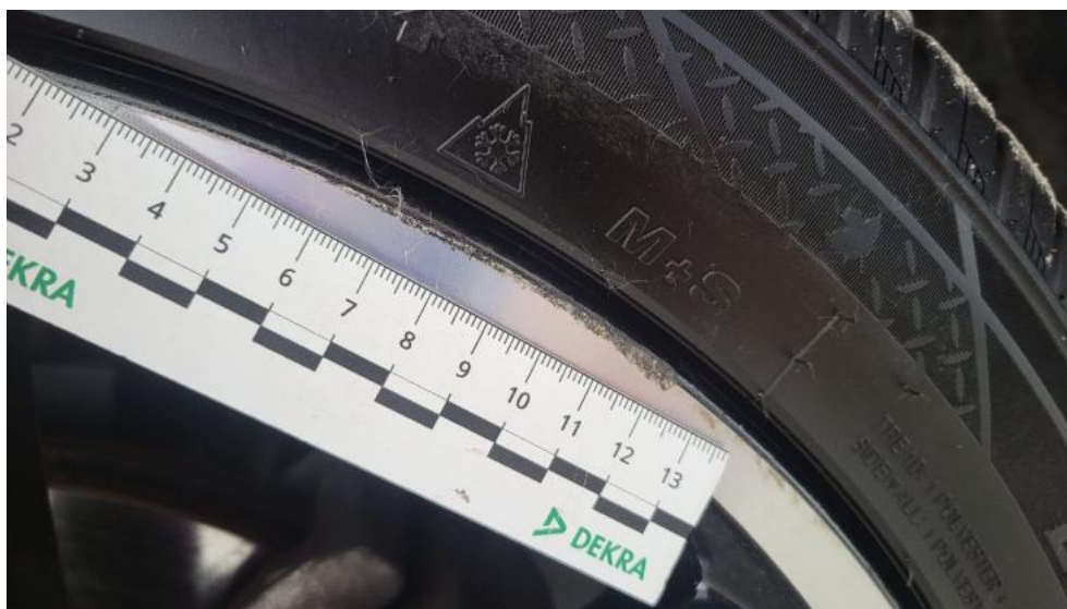
Photo 41. Felga aluminiowa przednia P - Rysa/odprysk 1
