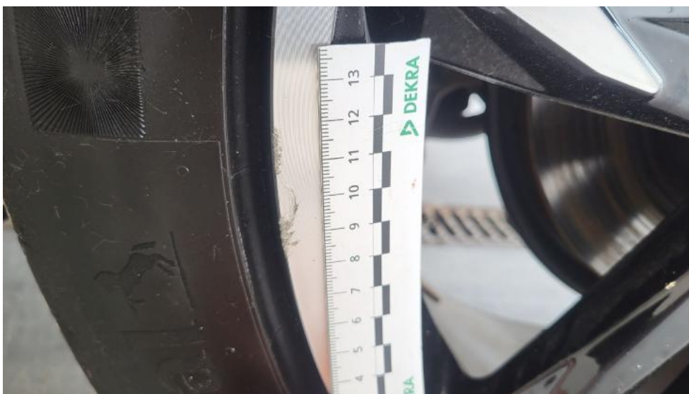
Photo 52. Felga aluminiowa tylna L - Rysa/odprysk 1
