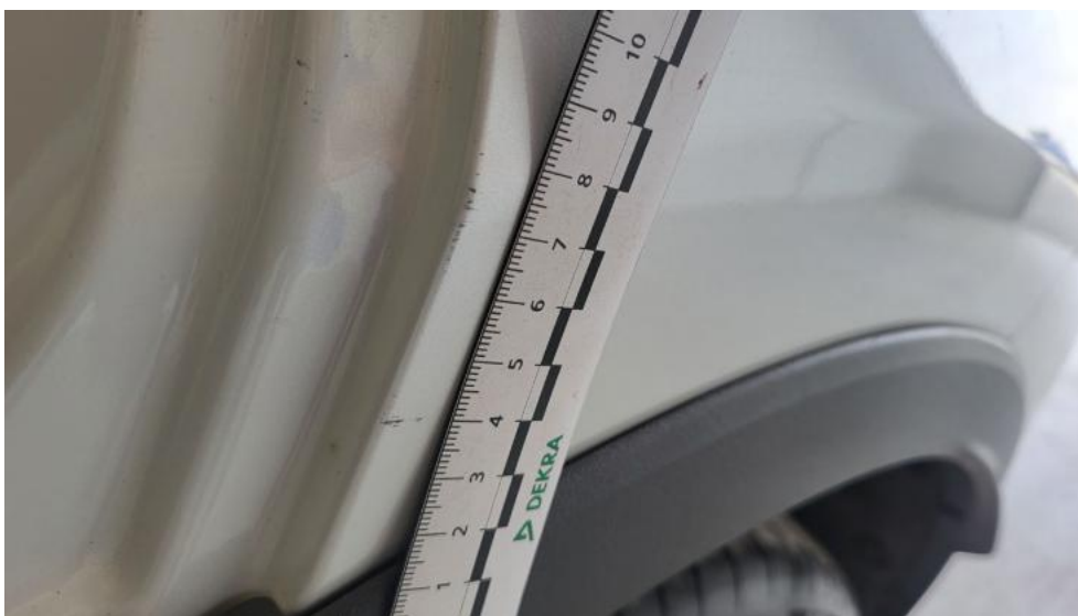
Photo 51. Błotnik tylny L / Ściana boczna L - Rysa/odprysk 1
