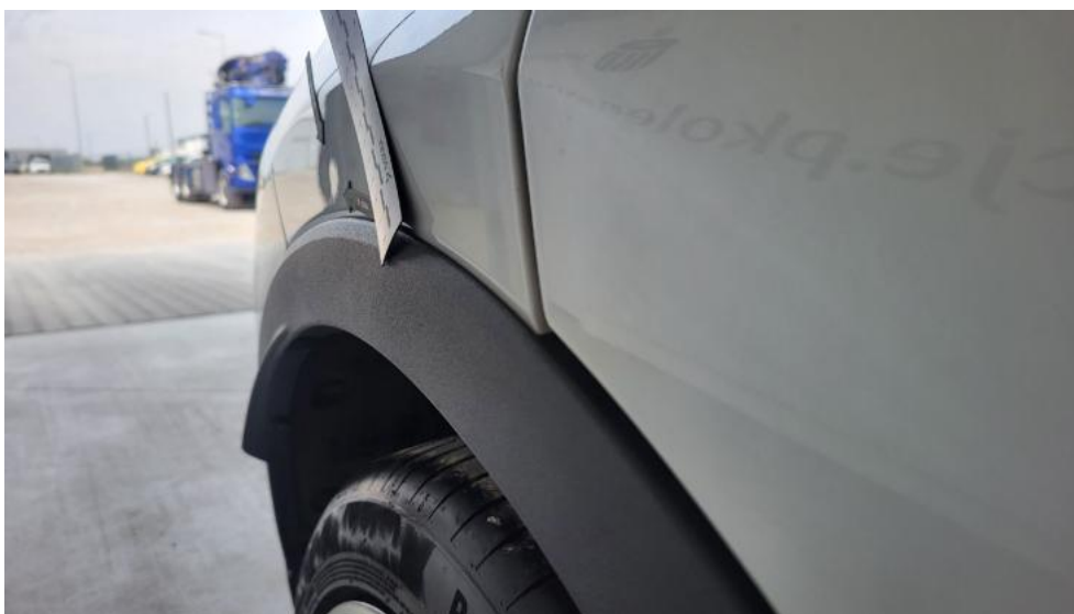
Photo 45. Błotnik tylny P / Ściana boczna P - Wgniecenie/odkształcenie 1
