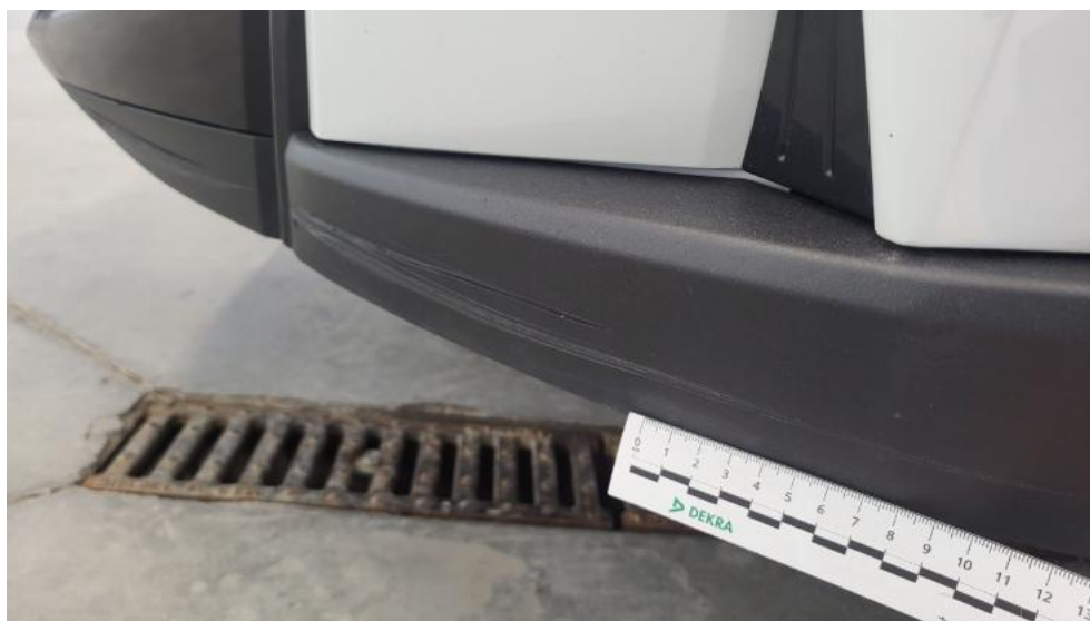
Photo 40. Zderzak przedni cz L - Rysa/odprysk 1
