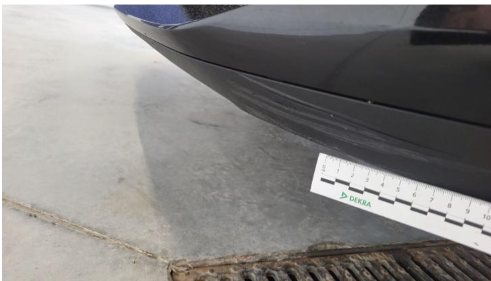
Photo 37. Spoiler zderzaka przedniego - Rysa/odprysk 1
