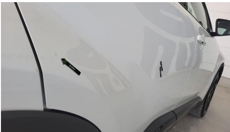
Photo 43. Drzwi tylne P - Wgniecenie/odkształcenie 1
