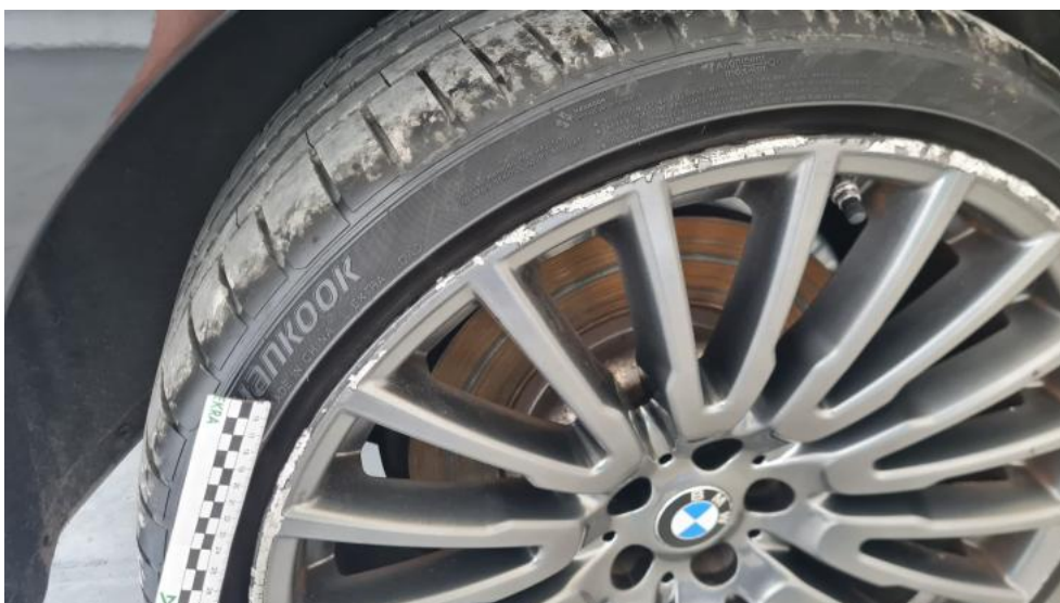
Fot. 54. Felga aluminiowa tylna P - Rysa/odprysk 1
