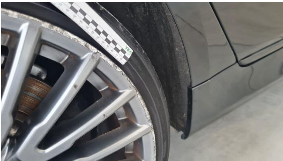
Fot. 55. Felga aluminiowa tylna P - Rysa/odprysk 2
