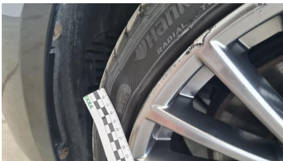
Fot. 72. Opona przednia L - Wgniecenie/odkształcenie 1
