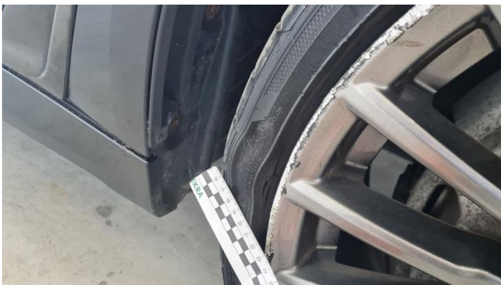
Fot. 48. Opona przednia P - Wgniecenie/odkształcenie 1
