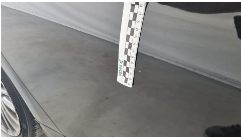
Fot. 52. Drzwi tylne P - Rysa/odprysk 1
