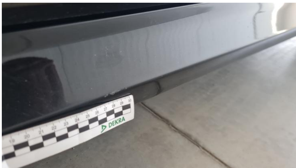
Fot. 66. Próg L - Rysa/odprysk 1
