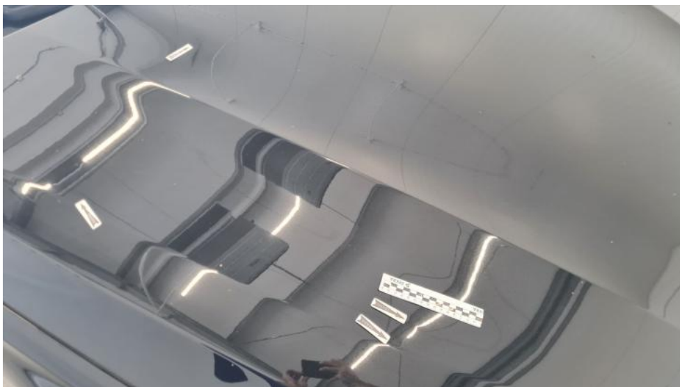
Fot. 41. Pokrywa komory silnika - Wgniecenie/odkształcenie 2
