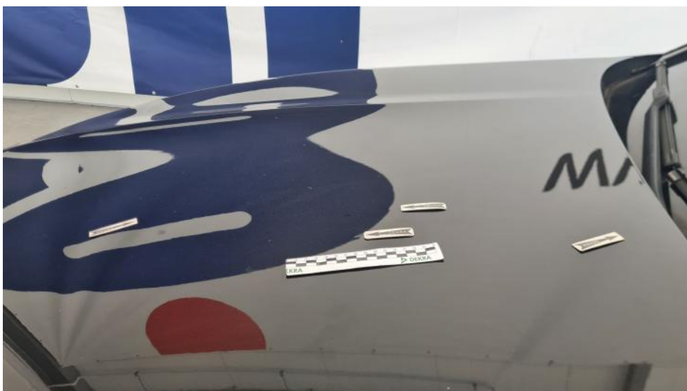
Fot. 40. Pokrywa komory silnika - Wgniecenie/odkształcenie 1
