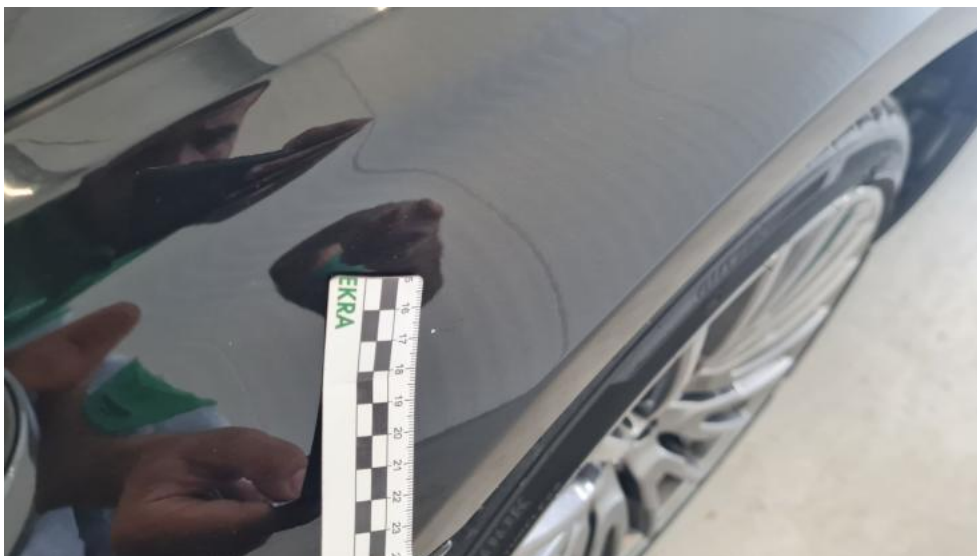
Fot. 69. Błotnik przedni L - Rysa/odprysk 1
