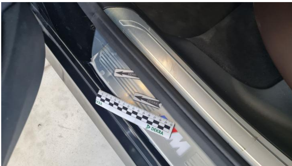
Fot. 67. Próg L - Wgniecenie/odkształcenie 1
