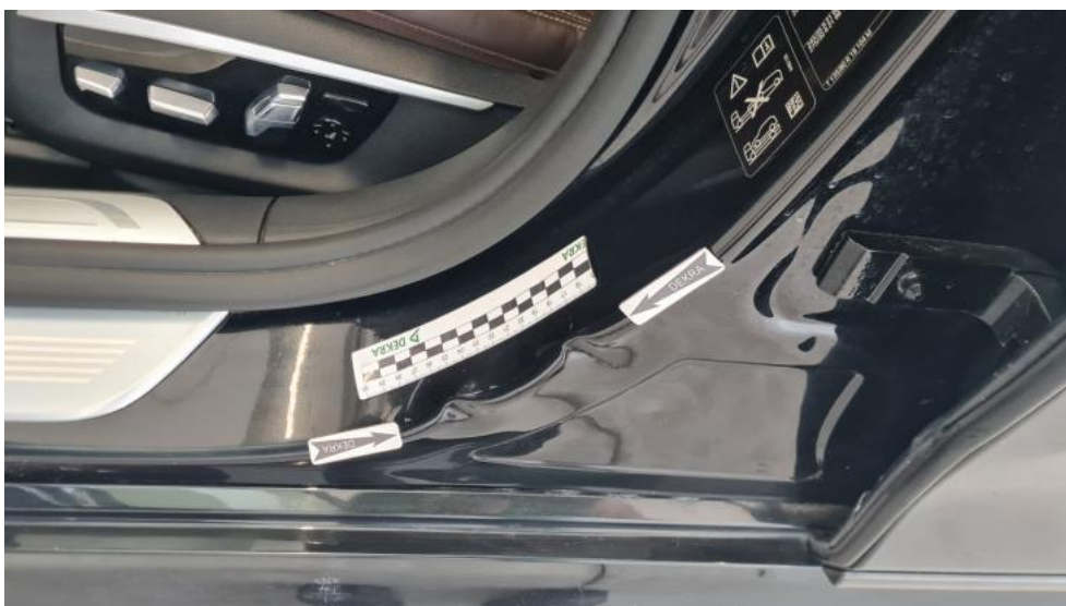
Fot. 68. Słupek środkowy L - Wgniecenie/odkształcenie 1
