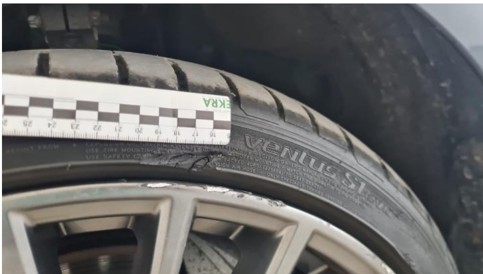
Fot. 73. Opona przednia L - Pęknięcie/rozerwanie 1
