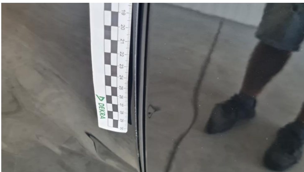
Fot. 62. Drzwi przed L - Rysa/odprysk 1
