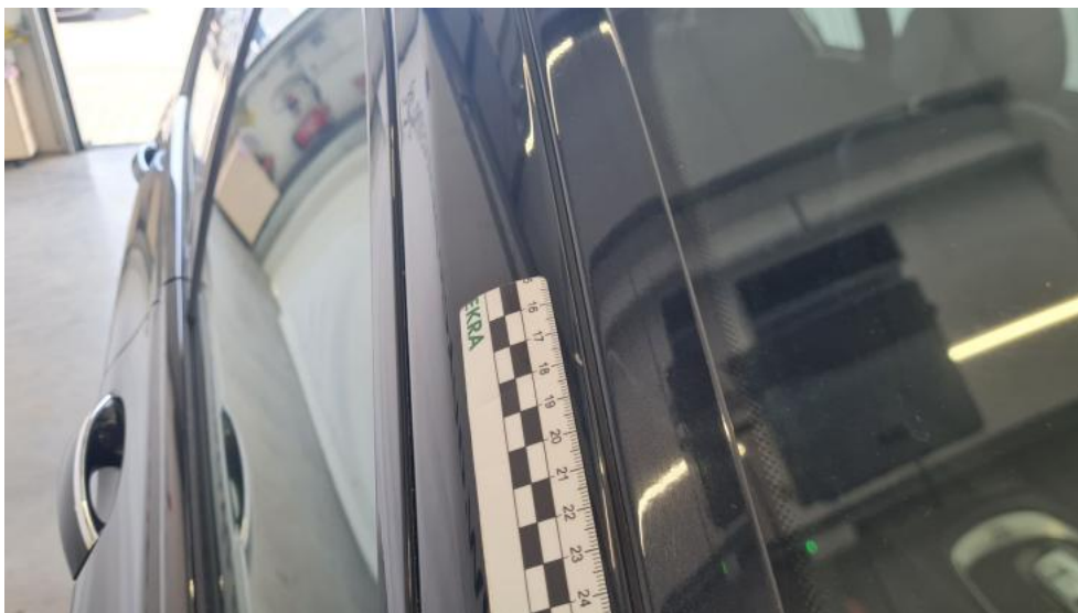
Fot. 53. Stupek przedni P - Rysa/odprysk 1
