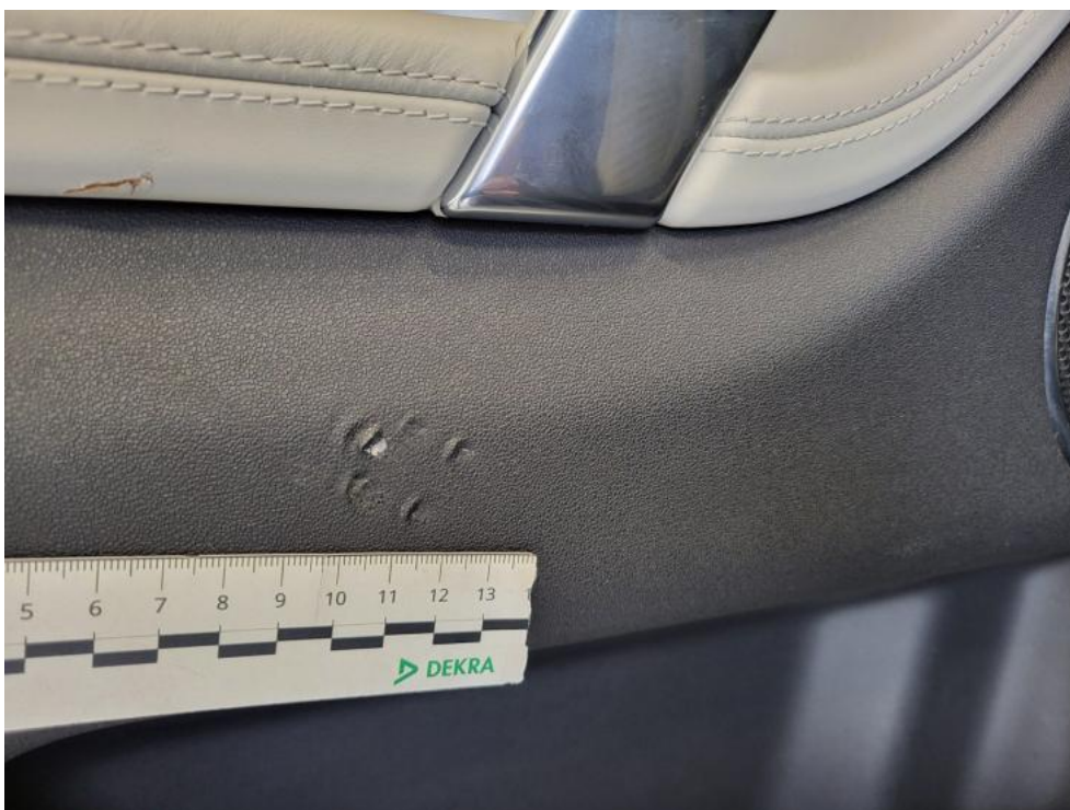
Fot. 62. Tapicerka drzwi tylnych L - Pęknięcie/rozerwanie 1
