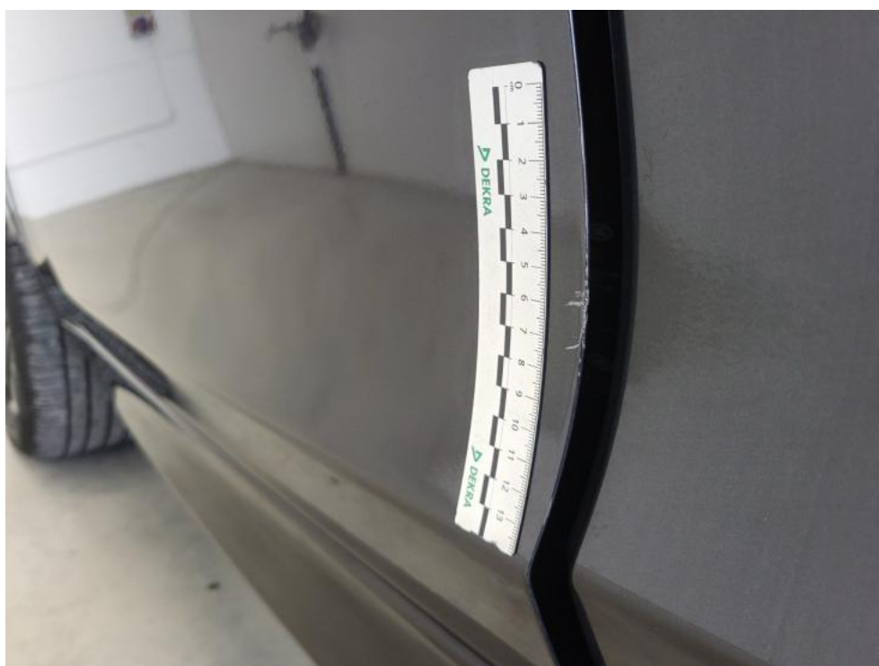
Fot. 56. Drzwi przed L - Rysa/odprysk 1
