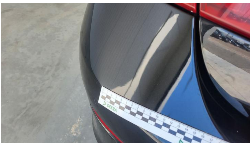
Fot. 50. Zderzak tylny - Pęknięcie/rozerwanie 1
